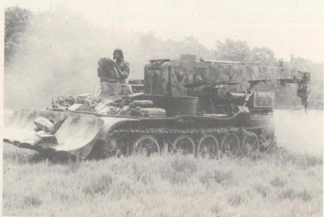
Tank za izvlačenje oštećene tehnike na terenu
