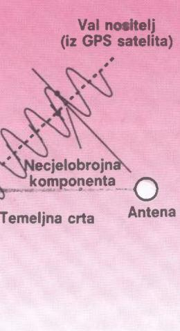
**Dobivanje CPA.** To je određivanje cijelog broja valnih duljina signala GPS satelita koje leže između nekog para antena
