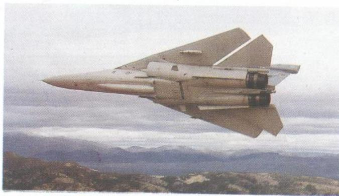
Najbolja obrana EF-111A je korištenje ugrađene ometačke opreme, i iznimno velika brzina (na slici se vidi Raven sa skupljenim krilima, pri velikoj brzini)
