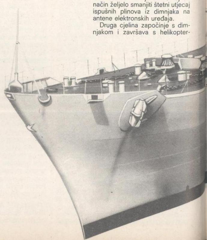
na vertikalu dimnjaka. Na taj se način željelo smanjiti štetni utjecaj ispušnih plinova iz dimnjaka na antene elektronskih uređaja.
