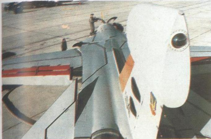
Sredinom osamdesetih, zbog nepouzdanosti, uklonjen je IR detektor AN/ARL-23 koji je bio postavljen u aerodinamičkom spremniku na repu (vidi se na slici)
