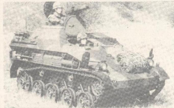
inačice Wiesel 1 vozila teške su s bojnim tretatom 2800 kg. Čelični oklop štiti od pješačkog oružja kalibra 7,62 mm. Njemačka vojska rabila je Wiesel vozila u Somaliji prošle godine.
