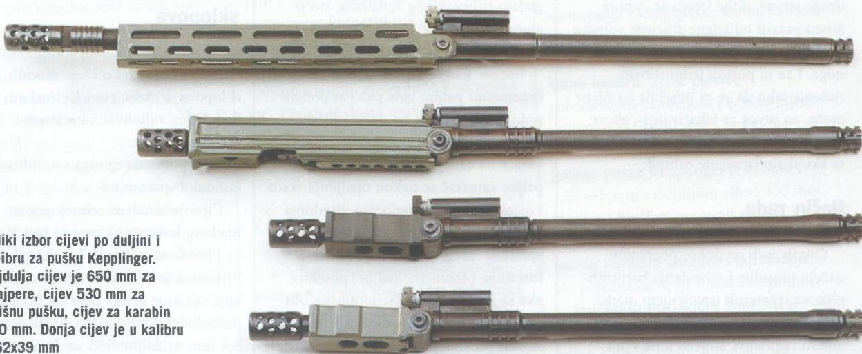
Veliki izbor cijevi po duljini i kalibru za pušku Kepplinger. Najdulja cijev je 650 mm za snajpere, cijev 530 mm za jurišnu pušku, cijev za karabin 420 mm. Donja cijev je u kalibru 7,62x39 mm
