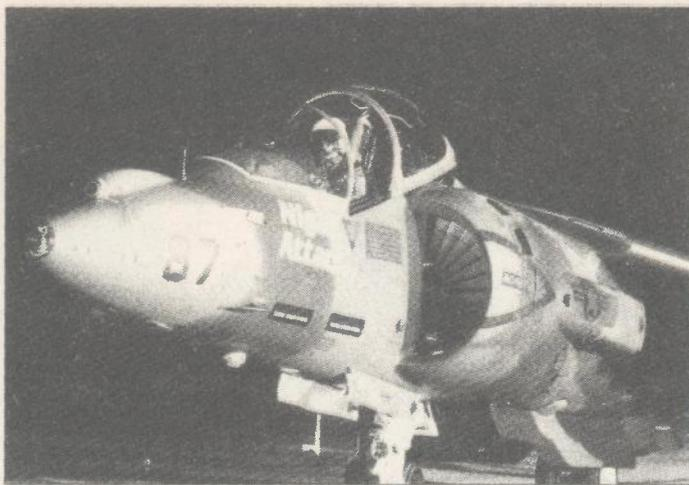
AV-8B Harrier prije noćnog napadaja uz pomoć FLIR senzorskog sustava ugrađenog u nos zrakoplova
