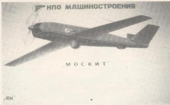
*'Moskit' je letjelica koju je razvio NPO Mašinstrojenije za novi izvidnički sustav. Lansira se iz spremnika pomoću potisnih, odbacivih raketnih motora. U spremniku i u trenutku lansiranja krila su sklopljena uz trup letjelice, a postavljaju se u razvučeni položaj nakon što je letjelica pri lansiranju napustila spremnik*
