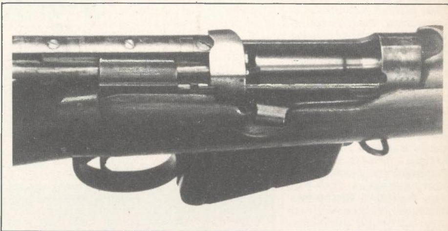
*Lee-Metford Mark II, s nabojem koji leži na pločici prekidača dotoka streljiva*
