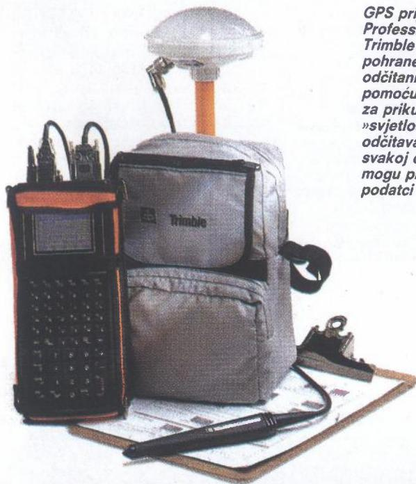
*GPS prijamnik Pathfinder Professional tvrtke Trimble ima mogućnost pohrane više od 50.000 odčitanih točaka, a pomoću ručnog računala za prikupljanje podataka i »svjetlosne olovke« za odčitavanje barcoda, svakoj odčitanoj točki se mogu pridružiti i drugi podatci*
