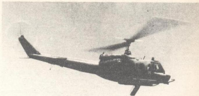
*Početna ispitivanja sustava SOTAS, izvršena od strane kopnene vojske SAD, obavljena su na helikopterima JUH-1, opsežno modificiranim UH-1. Na slici lijevo vidi se podtrupni spremnik sa SOTAS-om, a na desnoj slici SOTAS u operacionom položaju (uočljive su i uvučene skije podvozja)*
