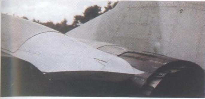
**Repni stožac je preoblikovan radi smanjivanja transsoničnog otpora i smještaja dva padobrana za kočenje. S njega su uklonjene i ledna i podtrupna zračna kočnica, koje su zamijenjene jednom kočnicom postavljenom na lednom dijelu trupa zrakoplova**
