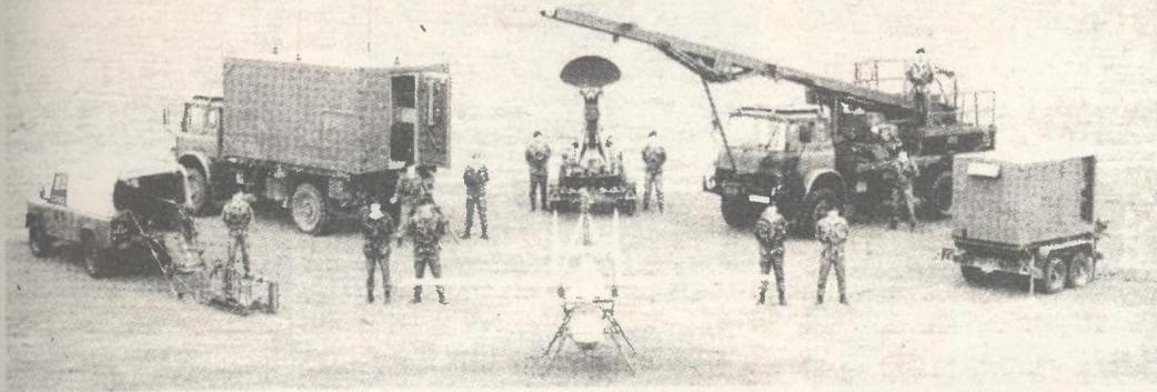
Ključni čimbenici sustava Phoenix. U prednjem planu je letjelica (UAV) s podvješanim senzorskim kontejnerom. Straga (slijeva nadesno) nalaze se: Land Rover za izvlačenje, zemaljska upravljačka postaja (GCS), zemaljski terminal za prijenos podataka (GDT), vozilo za lansiranje, i generator za GCS
