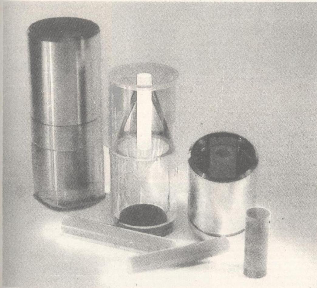
**Jednodirekcijski radijator (JDR) koristi konstrukciju sličnu kumulativnom punjenju. U njemu je šupljik stožac (lijevak) sačinjen od eksploziva napunjen plemenitim plinom. Eksploziv služi za zagrijavanje plina. Laserska obojena šipka postavljena duž glavne osi JDR-a »pumpa« se radijacijom (bljeskom) nastalom prigodom zagrijavanja plina, pri čemu se nastala količina svjetlosti usmjerava u jednom smjeru**
