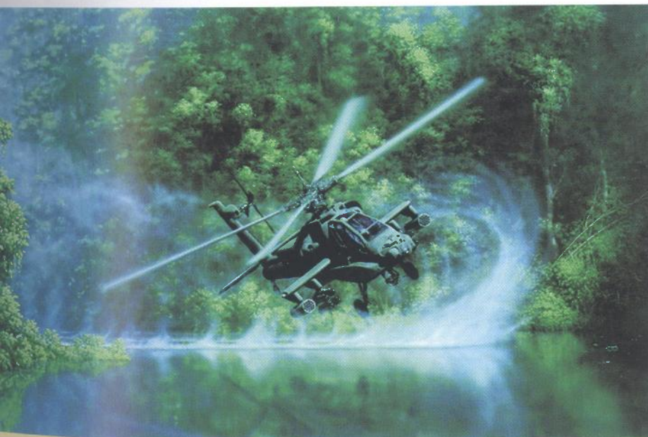
Američki borbeni helikopter AH-64 Apache bio je prva platforma namijenjena za lansiranje raketa Hellfire kad je ona stavljena u operativnu uporabu. Taj se helikopter odlikuje izvrsnim manevarskim sposobnostima, brzinom, velikim dosegom te velikom paljbenom moći (osim raketa Hellfire koristi i nevođene rakete 70 mm, top 30 mm te rakete zrak-zrak)
