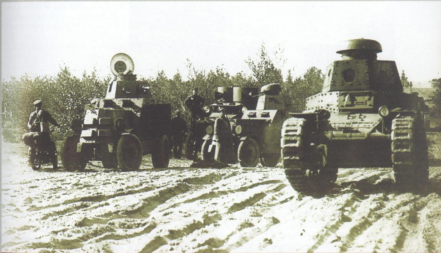
Prvi sovjetski tenkovi pravljani u većem broju bili su laki tenkovi T-18. Iako je u proizvodnji bio samo dvije godine (1929.-1931.), to je bio prvi sovjetski tenk proizveden u velikim količinama (napravljeno je 959 primjeraka), a unatoč tome što je ubrzo tehnički bio nadmašen od novijih tenkova njegovom upotrebom novostvorene mehanizirane postrojbe stekle su dragocjena iskustva u oklopnom ratovanju. Na fotografiji su dva T-18, snimljena s oklopnim kolima (u pozadini) na manevrima 1929. godine
