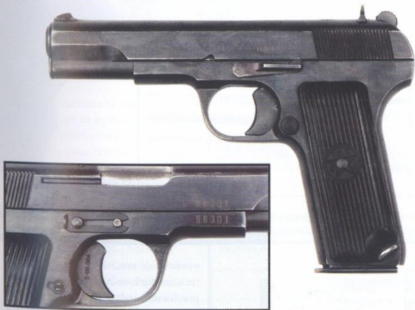
Pištolj kalibra 7,62 mm M57 ima, osim serijskih brojeva na rukohvatu, navlaci i cijevi, utisnute i tvorničke oznake za pojedine dijelove. To znatno olakšava rad u radionicama tijekom remonta oružja
