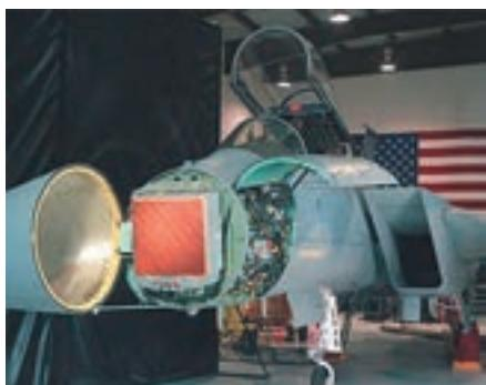
**NOVI** AESA (Active Electronically Scanned Array) radar APG-79 kojeg razvijaju Raytheon i Space and Airborne Systems postigao je vrijedan uspjeh u procesu uvođenja u uporativnu uporabu. Tijekom testiranja provedenih krajem prošle godine na kalifornijskom poligonu u China Lakeu pomoću novog radara postig-
