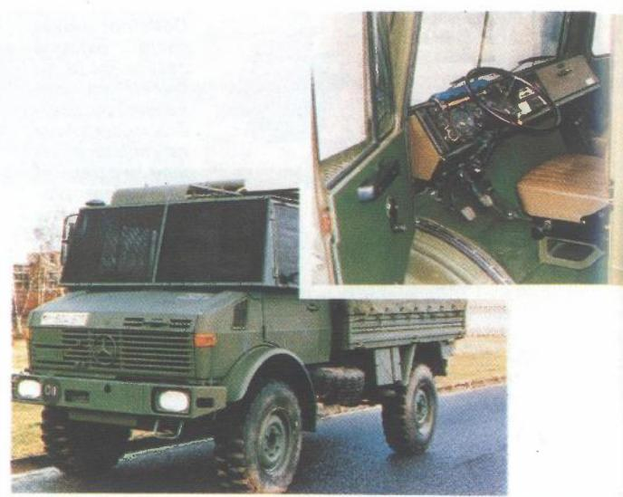
Ograničena oklopna zaštita potrebna je često puta i standardnim vozilima. Konstrukcijska rješenja u kabini i na prozorima (vidi sliku) treba pružiti zaštitu od krhotina i projektila streljačkog oružja
