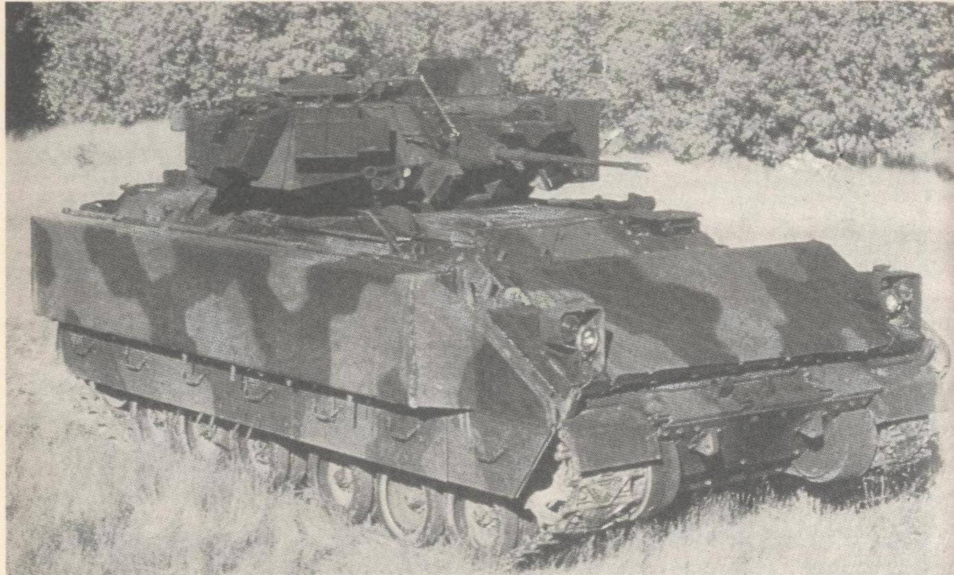
Moderno MICV (engl., Mechanised Infantry Combat Vehicle – borbeno vozilo mehaniziranog pješaštva), prikazno na slici je M2A2 Bradley američke vojske. Od ovog MICV-a se očekuje da bude nešto više od transportera za pješaštvo. Naime, to je vozilo namijenjeno i za pružanje direktnе paljbene potpore pješaštvu kad ono izade iz vozila uništavanjem »lakih« ciljeva koji ometaju napredovanje pješaštva
