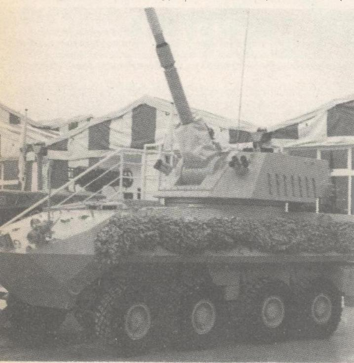
Na slici je prikazano kanadsko vozilo GM 8x8 s ugrađenom kupolom za minobacač 120 mm koje je rezultat rada na ovakvom konceptu
