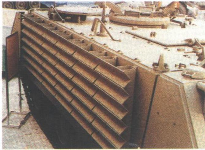
Izraelska tvrtka Rafael razvila je dodatnu zaštitu za oklopne transportere M113. Konstrukcija sastavljena od čeličnih elemenata različitih oblika štiti od probojnih projektila kalibra 20 mm, ispaljenih s daljine od 200 metara. Masa cijele konstrukcije iznosi 855 kg
