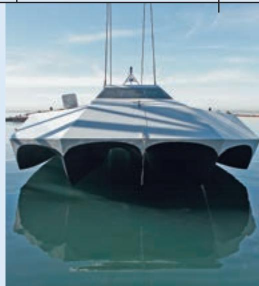
brod plovi te četiri tunela koji se nalaze između tih oslonaca a takvom formom postiže izdizanje plovila iznad valova. Brod ima ugrađenu kružnu rampu za rukovanje brodicom maksimalne duljine 11 metara a isto tako može primiti manju bespilotnu letjelicu.
