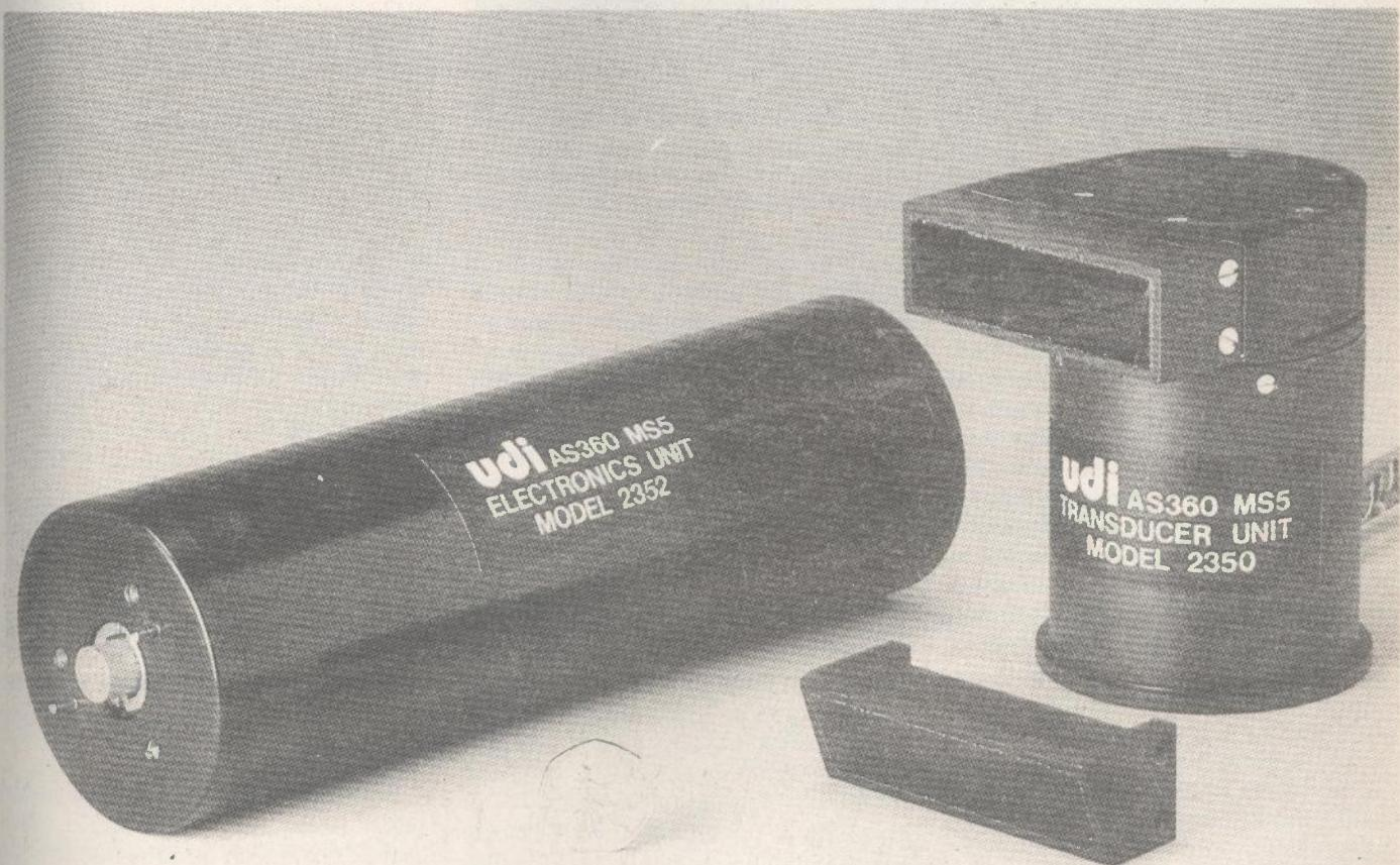
Sklopovi sonara UDI AS 360 MSS, koji se ugrađuju na ronilicu, u usporedbi s novčićem od 50 penija
