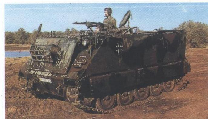
Dobro poznati oklopni transporter M113, snage 150 kW, mase 11 tona, brzine 70 km/h, autonomije kretanja 540 km, naoružan strojnicom 7,62 mm, s mogućnošću prevoženja 10 vojnika
