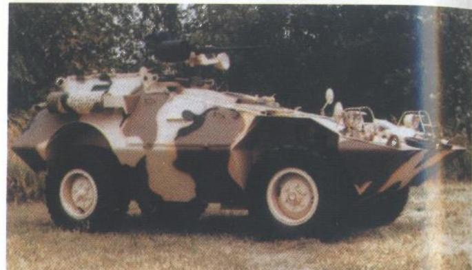
Izvidnički automobil Cadillac Gage Scout 4x4 naoružan s cijevnim i protuoklopnim raketnim naoružanjem (TOW). Osim sigurnosnih guma, vozilo raspolaže i oklopnom zaštitom koja ga štiti od paljbe streljačkog oružja
