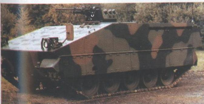
*Borbeno vozilo pješaštva TH 495 ICV naoružano strojnicom 12,7 mm*
