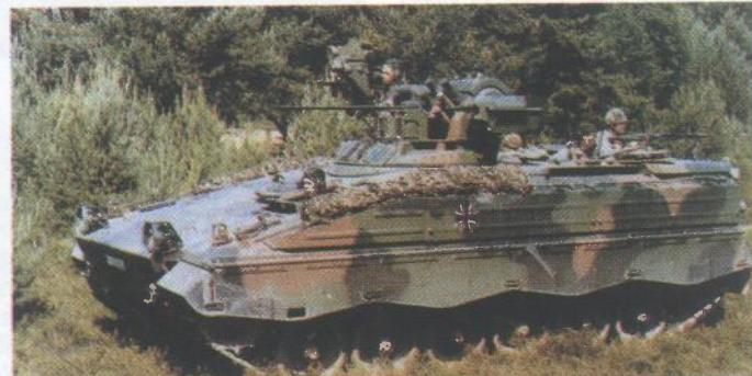
*Viša klasa lako oklopno vozilo na gusjenicama Marder 1 A3. Vozilo je naoružano topom 20 mm, POVRS MILAN. Masa vozila je 33,5 tona, snaga 441 kW, brzina km/h. Posadu vozila čini devet vojnika*
