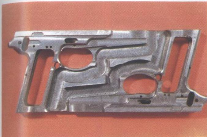
Prvi primjerici PHP izrađeni su iz čeličnih ploča postupkom gledanja i bušenja. Bio je to vrlo zahtjevan i skup način proizvodnje
