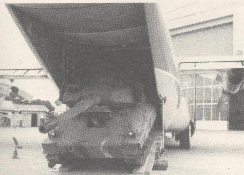
Na slici je prikazano probno ukrčavanje u transportni zrakoplov 20 tonskog oklopjenog topovskog sustava (kalibr 105 mm) koji je namijenjen za pružanje bliske potpore pješaštvu
