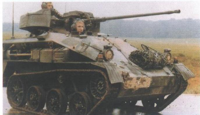
*Brzohodno lako gusjenično vozilo Wiesel 1 MK naoružano topom 20 mm, ima dva člana posadu. Masa vozila je 2,75 tona, snaga 64 kW, brzina 80 km/h*
