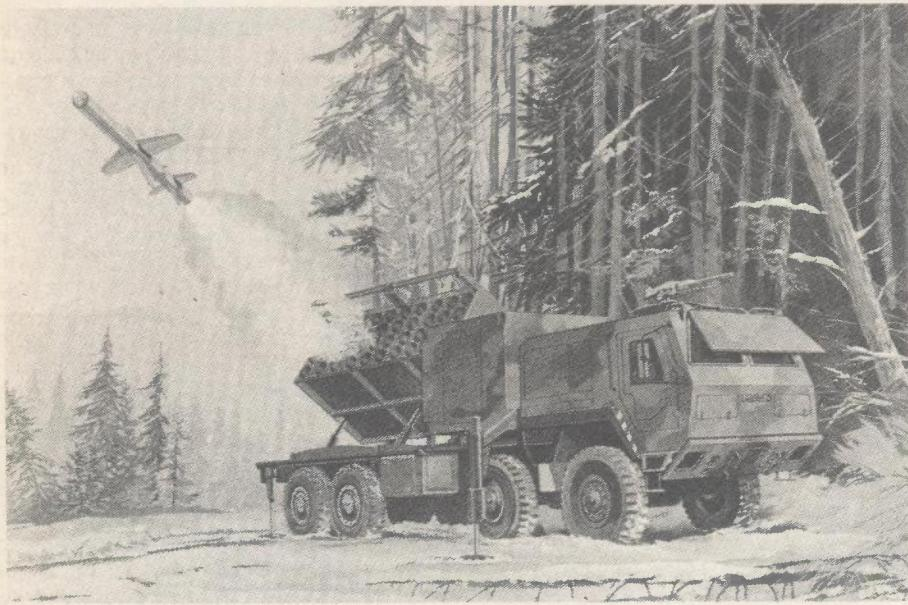
*Na slici je prikazana raketa FOG-M koja osim što je namijenjena za uništavanje niskolebdećih helikoptera može biti uporabljena i prigodom vođenja indirektne PO borbe*
