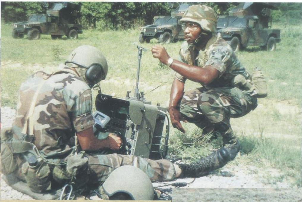
**PZO sustavom Avenger se može upravljati i s udaljenosti do 50 metara rabeći uređaj za daljinsko upravljanje. Zapovjednik mehaničkim markerom ugrubo navodi sustav prema cilju, a ciljač, čim mu se cilj pojavi na ekranu, preuzima fino praćenje i gađanje cilja**
