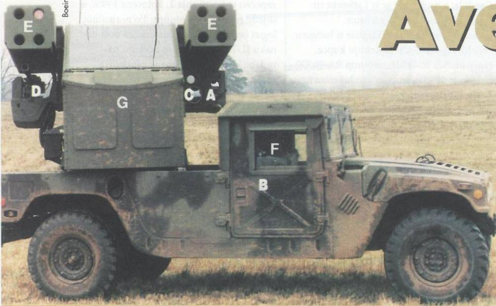
PZO raketni sustav Avenger modularne je konstrukcije i sastoji se od visokoprophodnog terenskog vozila tipa HMMWV (B) i borbene kupole (G). Najažniji podsustavi borbene kupole su: FLIR kamera (A); laserski daljinomjer (C); teška strojnica M3P (D); dva skupna lansera Stinger sa po četiri rakete (E); uredaj za daljinsko upravljanje kupolom (F) i sustav veza i upravljanja u kupoli
