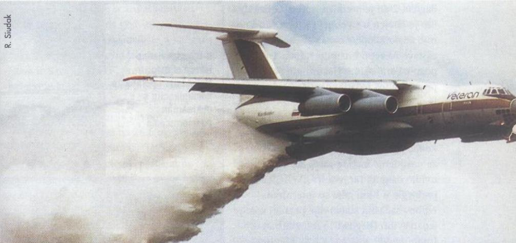
Vodeni bombarder izbacuje 40 tona sredstva za gašenje na požarište zahvaljujući infracrvenom ciljniku vidi kroz dim. Standardni IC-76 modulom VAP-2
