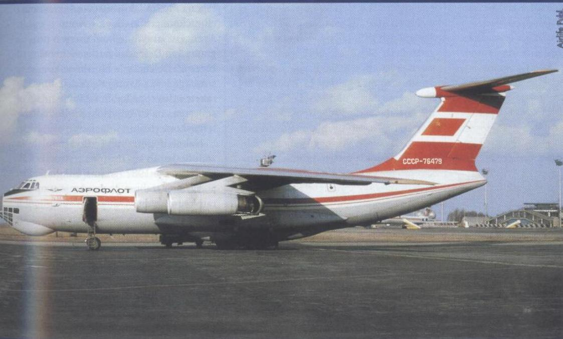
**Polarna shema (crvena) Aeroflota SSSR-a. Videna su gruba slijetanja uz rotiranje zrakoplovne i pucanje guma na zaledenoj zemlji. Isti zrakoplov je brzo bio sposoban bez popravka poletjeti. Učljiv promjenjiv položaj horizontalnog dijela repa**
