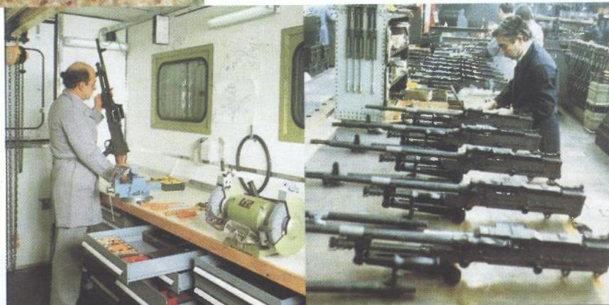
Montaža i kontrola puškostrojnica 7,62 mm MAG u belgijskoj tvornici FN HERSTAL
