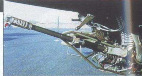
**Jednocijevni automatski top M230 kalibra 30 mm sa 1200 metaka ima brzinu paljbe 600-650 metaka u minuti.**
