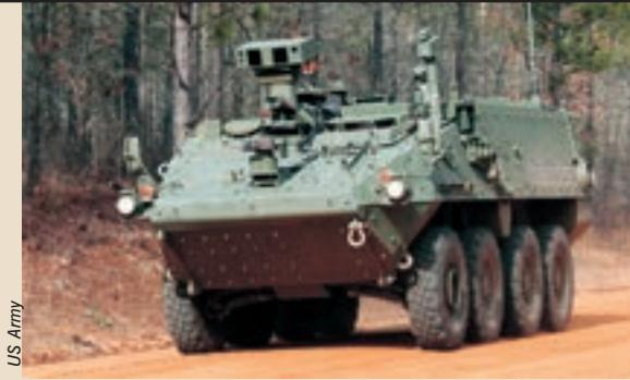
ravnim su dionicama postizane brzine do 65 km/h. Najvažniji dio robotiziranog Strykeera je senzorski paket koji se sastoji od modernog ladar-a i termovizijske kamere, te naprednih računala za obradu podataka i autonomnu navigaciju. U tome mu pomažu i podaci koje prima od prvog, vodećeg vozila. Dosadašnji su rezultati, navodi se u priopćenju, izvrsni. Robotsko je vozilo slijedilo vodeće vozilo s ljudskom posadom na udaljenosti od 100 metara.
