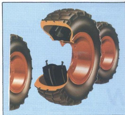
*Rješenje za kotačna vozila predstavlja i pneumatik sa sigurnosnim Vorwerkovim NLR prstenom (Njemačka)*
