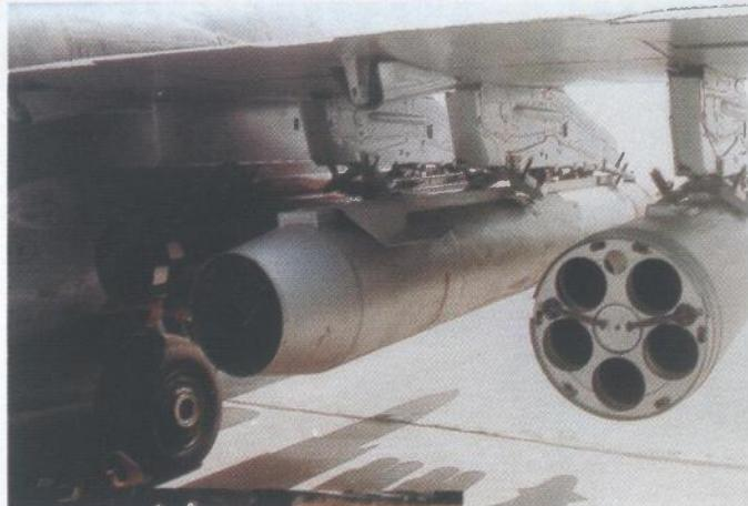
Na desnom je nosač lansera B-13 za pet nevođenih raketa S-13 kal. 122 mm. Lijevo je cijevasti lanser O-15 za laserski vođenu raketu S-25L
