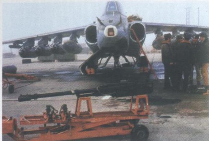
Dvocijevni 30 mm top izvađen je iz zrakoplova i smješten na posebnu kolicu; sačasti lanseri za nevođene rakete kal. 80 mm podvješeni su pod krila
