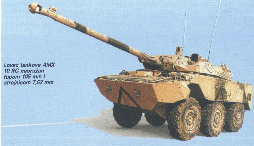
*Lovac tankova AMX 10 RC naoružan topom 105 mm i strojnicom 7,62 mm*
