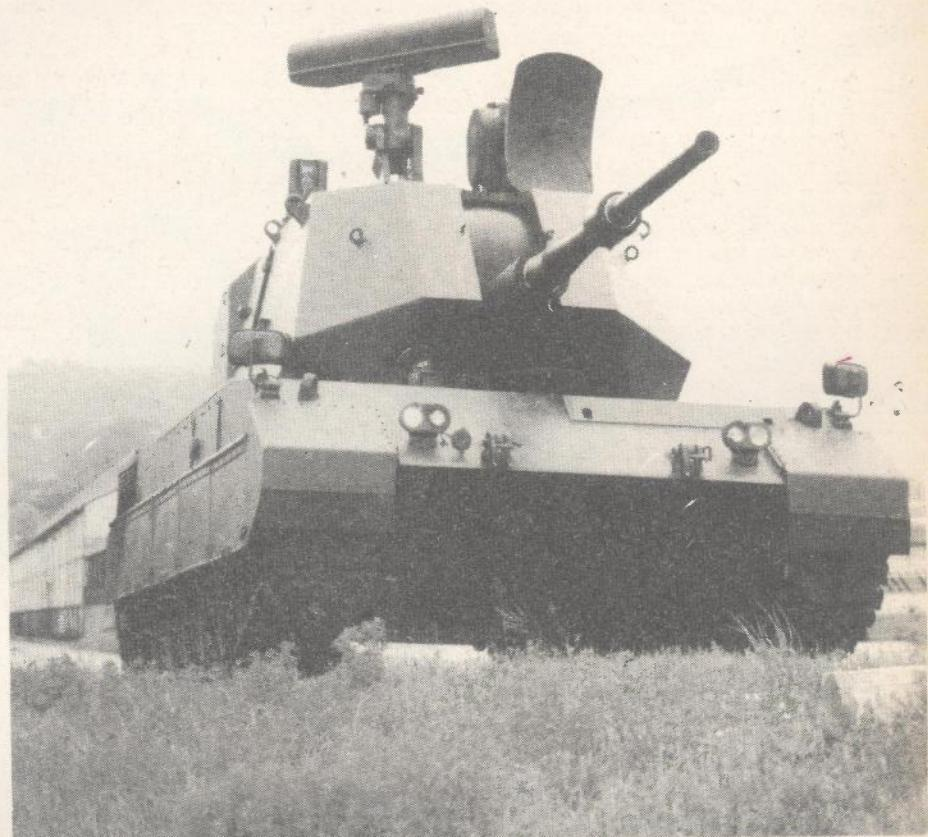
OTOMATIC ovdje ugrađen na podvoz samovozne haubice PALMARIA, može se ugraditi na bilo koji pogodan tankovski podvoz po želji naručitelja
