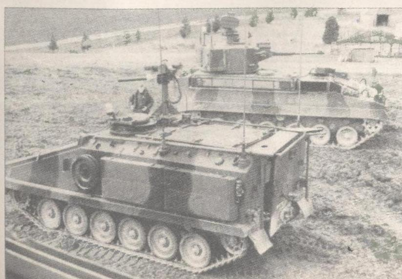
*VERDI 2 ugrađuje se na Warrior (s kupolom i oružnim sustavima) i Stormer koji se oprema s mikrovalnom usmjerrenom antenom za prijenos slike s TV i termovizijskih kamera.*
