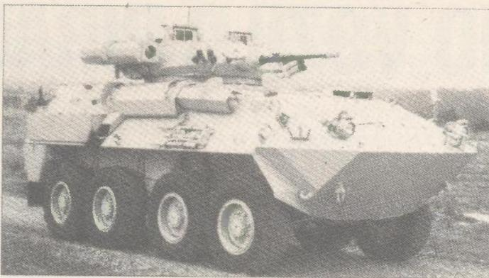
*Na slici je prikazan prototip nove inačice Pirane koji je izradila tvrtka GKN. Na tu je inačicu montirana kupola Delco TOW koja ima ugrađen top kalibra 25 mm, strojnici 7,62 mm i lanser (po jedan sa svake strane) za PO vođene rakete TOW*
