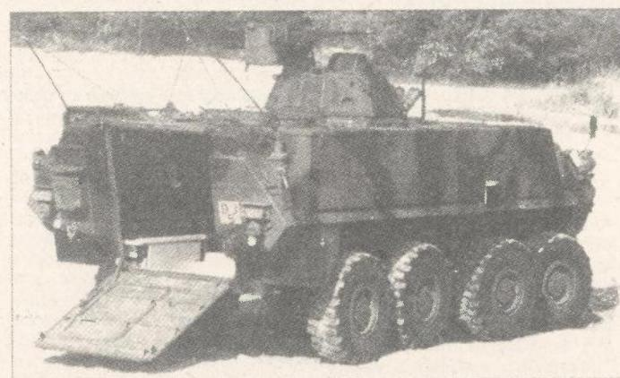
*Vrata u obliku rampe na zadnjem dijelu vozila osiguravaju dobar pristup unutarnjem prostoru (volumena 9,5 m³) inačice koju je naručila švicarska vojska*
