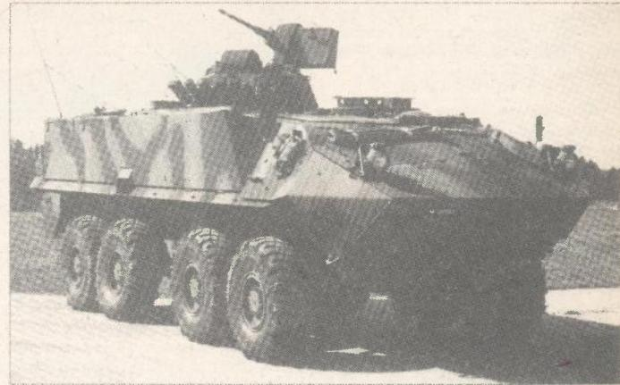
*Na slici je prikazan prototip poboljšane Pirane sa širim gumama i kupolom KUKA 606 A1-CH sa strojnicom kalibra 12,7 mm koji je proizведен za švicarsku vojsku. Dodatni oklop koji povećava zaštitu ovog vozila vidi se na prednjem dijelu tijela vozila*
