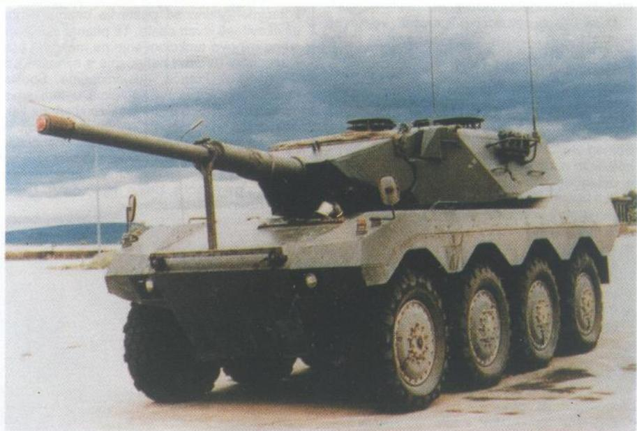
**Eksperimentalno vozilo 8x8, lovac tankova borbenе težine 32–36 t, (motor snage 610 kW) naoružan topom kalibra 105 mm s izljebljenom cijevi ili topom kalibra 120 mm s glatkom cijevi**
