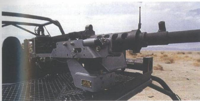
Ovisno o namjeni strojnica razvijena su različita postolja. Lijevo je prikazano postolje Mk26 za ugradnju strojnica na vozila ili čamce, a desno tronožno postolje M3.
