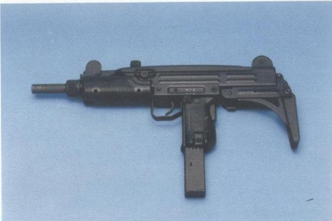
Kratka strojnica ERO rađena je prema uzoru na izraelski UZI. Koristi se standardni NATO metak 9 × 19 mm Parabellum
