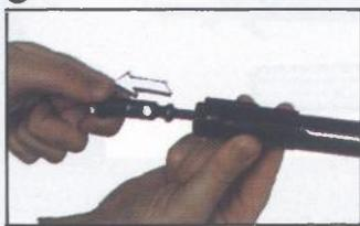
metka. Postaviti regulator paljbe u zakočen položaj ③ Pritisnuti vrhom zrna utvrđivač kućišta u stranu, te preklopiti kućište zatvarača prema naprijed ④ Povuci ručicu zatvarača unazad, te izvaditi zatvarač ⑤ Izvaditi ručicu povlačenjem do kraja unazad i niže ⑥ Vrhom zrna potisnuti u stranu i izvaditi utvrđivač udarne igle ⑦ Postaviti tijelo zatvarača u završeni položaj, te izvući udarnu iglu ⑧ Izvaditi klip koji veže tijelo zatvarača s nosačem ⑨ Odvojiti tijelo zatvarača od nosača
