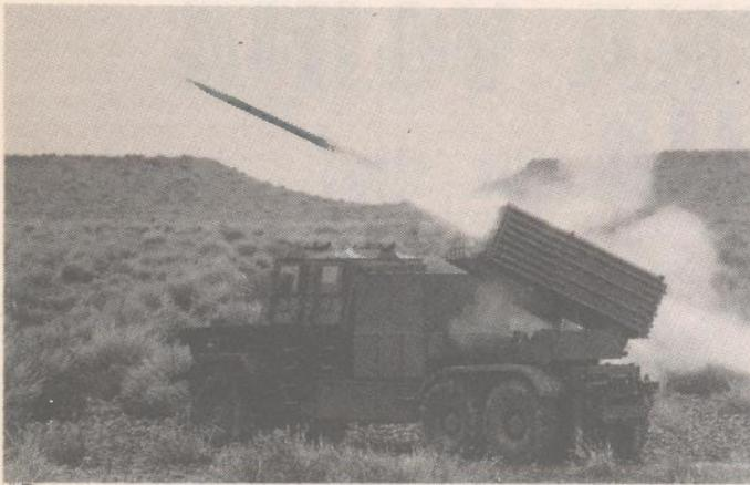
**Četrdesetcijevni lanser raketa Batelur kalibra 127 mm ostvaruje maksimalni domet od 37 km**
