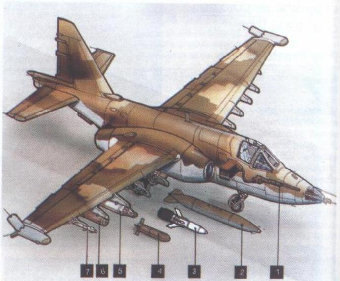
Crtež s mogućnošću nošenja borbenog tereta na Su-25: 1 — 30 mm top; 2 — dodatni spremnik goriva; 3 — vođeni projektili različitih vrsta; 4 — vođene bombe; 5 — lanseri nevođenih projektila zrak-zemlja; 6 — kasetne bombe; 7 — vođeni projektil zrak-zrak R-60 (AA-8) koji služi za samoobranu
