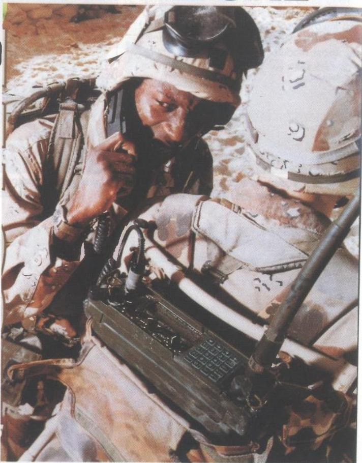
*Harris AN/PRC-138 prijenosni VF uređaj koji pokriva frekvencijsko područje 1,6-60 MHz, s vrstama rada frekvencijsko skakanje i automatskom upostavom veze (ALE), digitalnom kriptozastitom i ugrađenim modемом za prijenos podataka (do 2400 b/s)*
