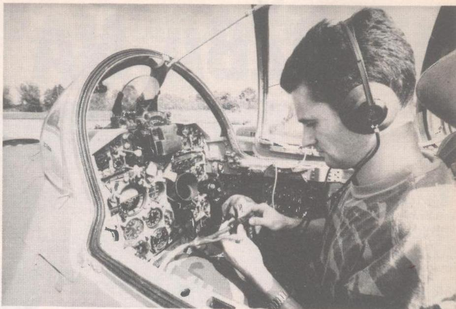
Provjera instrumenata u pilotskoj kabini
