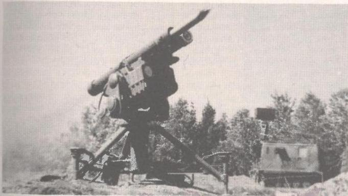
Upravo lansirana raketa sustava RBS-90 hita prema cilju; u drugom planu je zapovjedno vozilo Bv 206 s radarskom antenom usmjerenom prema cilju
