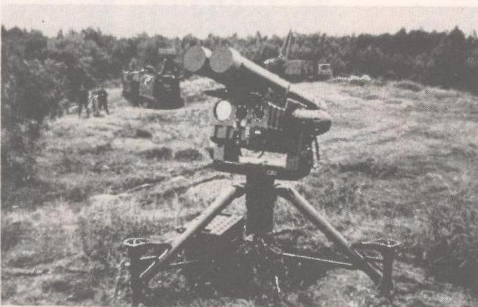
**Lanser sustava RBS-90 s dvije rakete spremne za lansiranje, te ciljničkom napravom koja sadrži TV i termovizijsku kameru i laserski predajnik**
