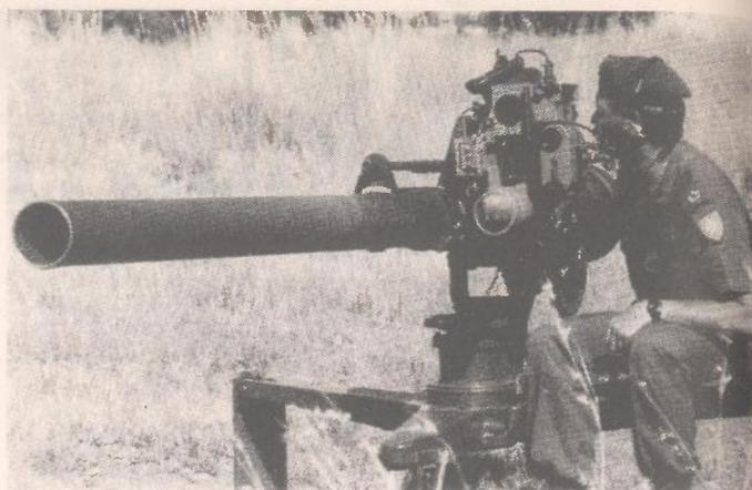
**Netržajni top kalibra 106 mm ostat će i dalje u uporabi, s tim da će na njemu biti izvršeno niz poboljšanja u smislu ugradnje dnevno/noćnog ciljnika i laserskog daljinomjera**
