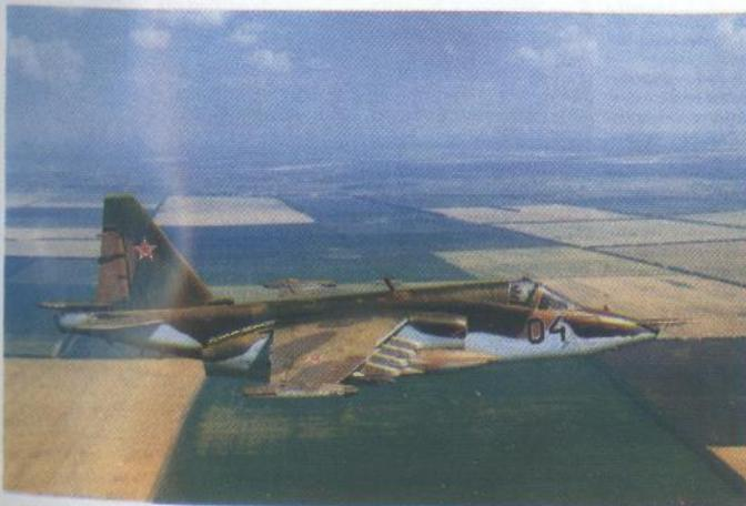
Su-25 zračnih snaga bivšeg SSSR-a: na unutarnjem nosaču vidi se dopunski spremnik goriva
