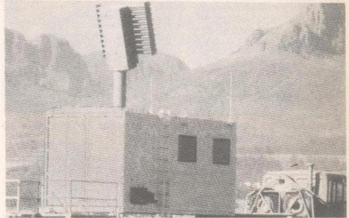
**ESD EDR 340 3D radar s mogućnošću praćenja do 100 ciljeva, proizvod tvrtke ESD jedne od vodećih u području elektro-mehaničkih sustava**
