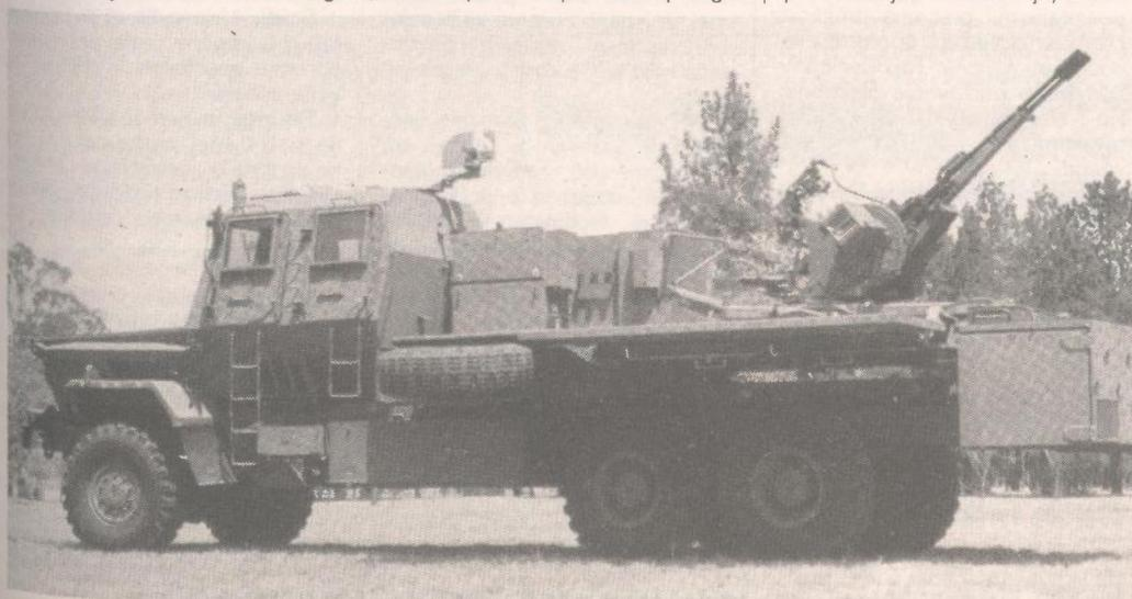
**Zumrlac dvocijevni 23 mm samovozni protuzrakoplovni sustav na paljbenom položaju**
