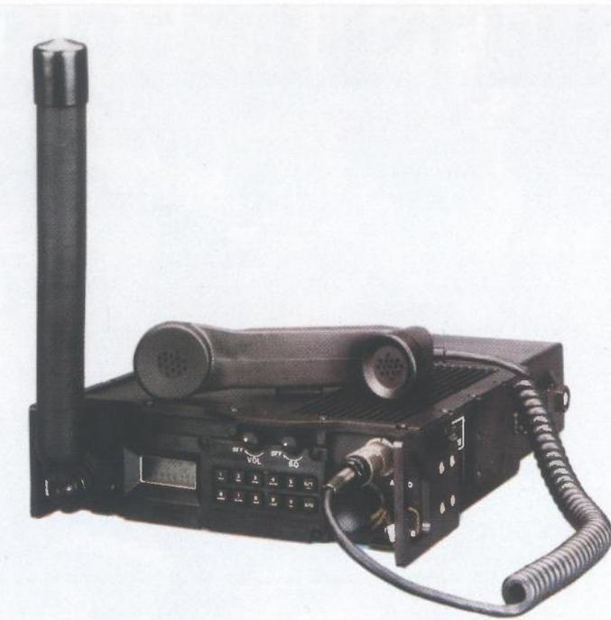
**Motorola URC-200 mali prijenosni taktički uređaj koji radi u frekvencijskom području 115-400 MHz (AM i FM) zbog osiguravanja radio-veza suradnje zrakoplovstva i kopnenih snaga**
