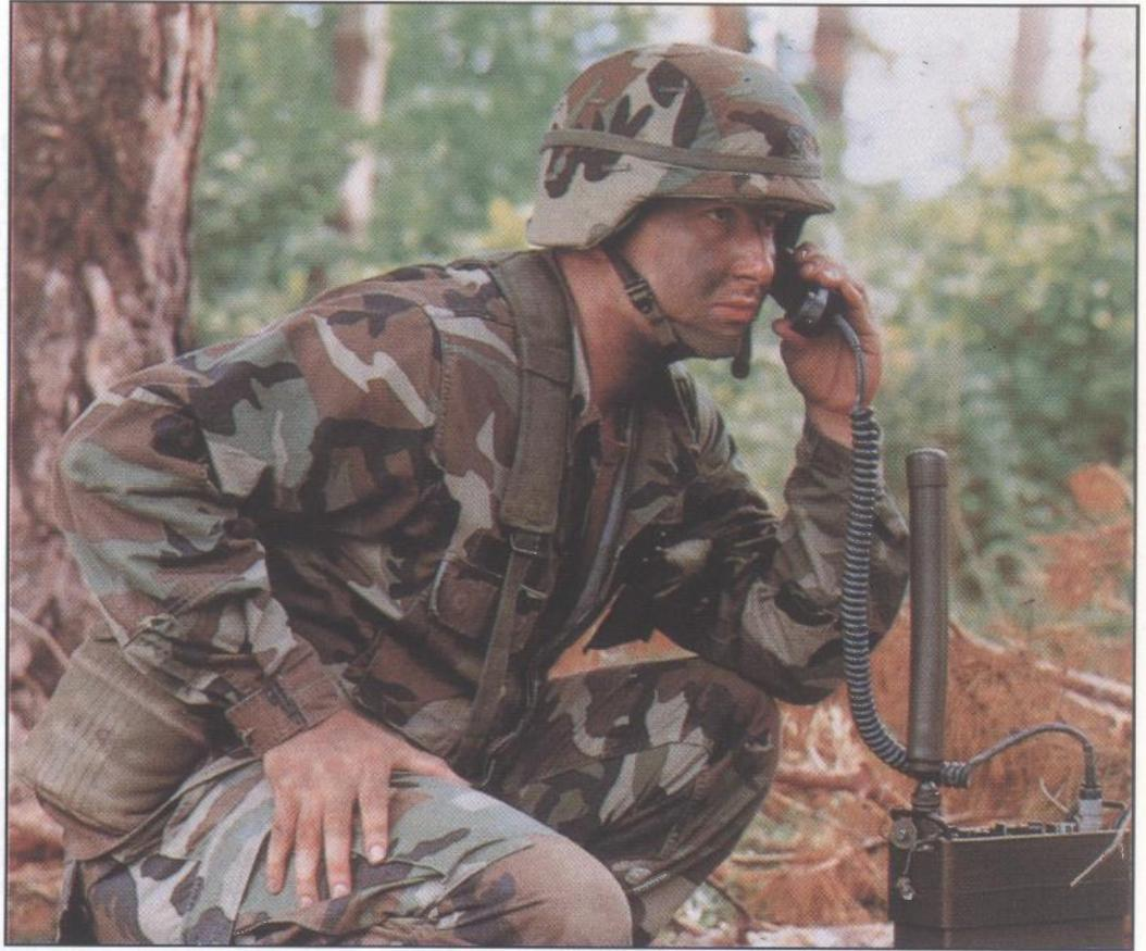
**Harris AN/PRC-117D(E) prijenosni taktički »multimission« radio-uređaj koji radi u frekvencijskim područjima 30-90, 116-174 i 225-420 MHz, s različitim širinama kanala i raznim vrstama modulacije, digitalnom KZ i frekvencijskim skakanjem**
