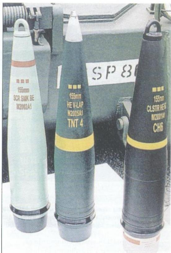
**Streljivo 155 mm Assegai tvrtke Naschem serije 2000 pripremljeno za uporabu iz sustava Braveheart. U sredini je razorni projektil M2005 A1 VLAP s proračunskim dometom 52 km**
