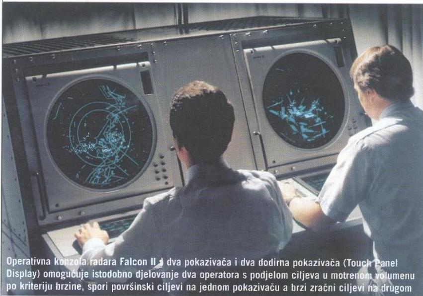
Operativna konzola radara Falcon II s dva pokazivača i dva dodirna pokazivača (Touch Panel Display) omogućuje istodobno djelovanje dva operatora s podjelom ciljeva u motrenom volumenu po kriteriju brzine, spori površinski ciljevi na jednom pokazivaču a brzi zračni ciljevi na drugom
