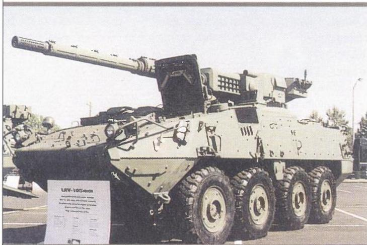
**Američki LAV-105 vozilo od 14t je najlakše vozilo koje uspješno nosi visokotlačni top 105mm.**
