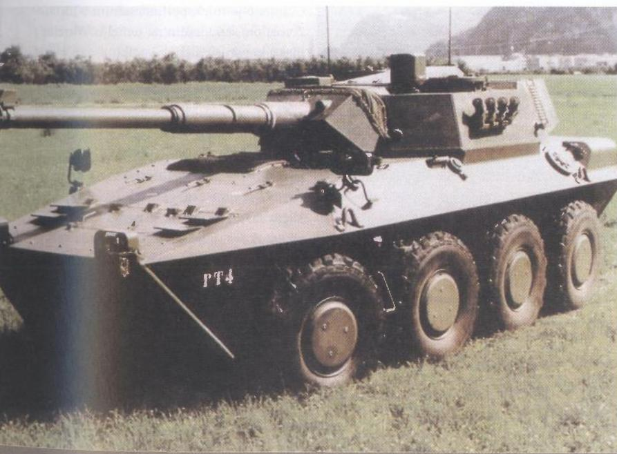
Centauro 8x8 izvidničko vozilo, tvrtki Iveco-FIAT i OTO Melara, teži 24t i ima visokotlačni top od 105mm
