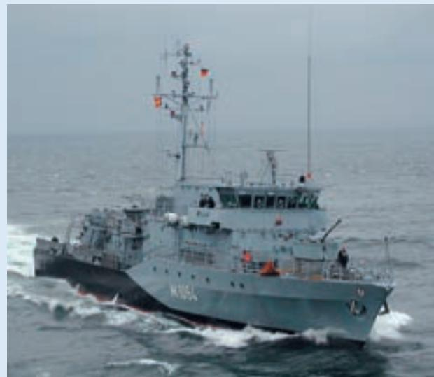
na. Brodovi su građeni od nemagnetnog čelika i opremljeni tegljenim sonarom i TV kamerom smještenom na daljinski upravljanju ronilici Penguin B3, iako nije naznačeno hoće li ta oprema biti uključena u prodaju.
