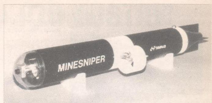
Protuminsko vozilo za jednokratnu uporabu Minesniper švedske tvrtke Simrad
