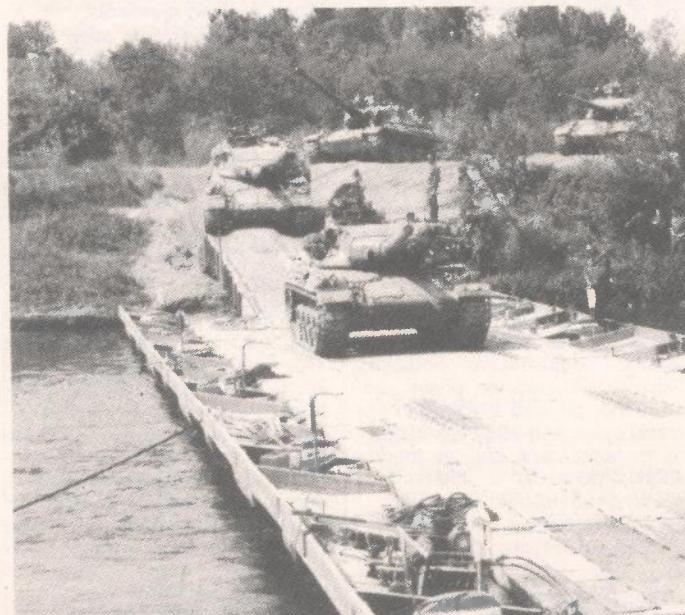
*Sposobnost opkoparstva da na odgovarajući način svlada zapreke ključna je za pokretljivost oklopnih snaga. Slika prikazuje kako francuska vojska svladava rijeku koristeći motorni pontonski most (MPB)*
