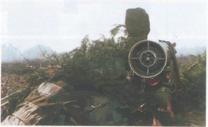
*Pogled sa zadnje strane na kontejner iz kojeg je ispaljena raket. Jasno se vide mlaznice izbacnog (booster) motora*
