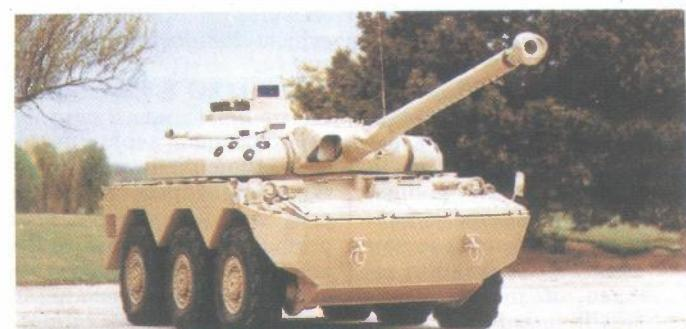
AMX-10RC naoružan kupolom TML-105. Riječ je o vrlo uspješnoj kupoli koja se osim ugradnje na oklopno vozilo Piranha 10 x 10 predviđa ugraditi i na neka druga vozila
