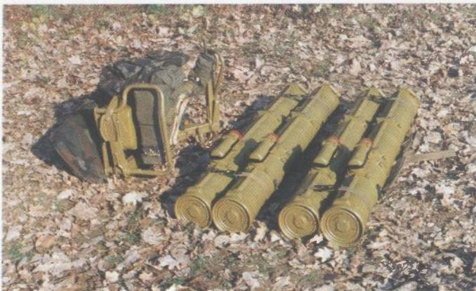
Na slici je prikazan PO lanser u hodnom položaju s kompletom od četiri rakete
