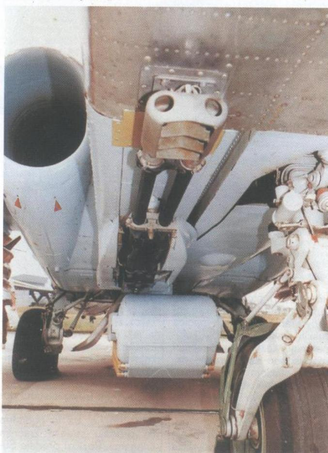
30 mm top postavljen na donjem dijelu trupa Su-25T: straga se vidi (na središnjem podtrupnom nosaču) spremnik »Merkuri« s elektrooptičkom opremom, koji omogućava Su-25T izvršavanje borbenih zadaća noću
