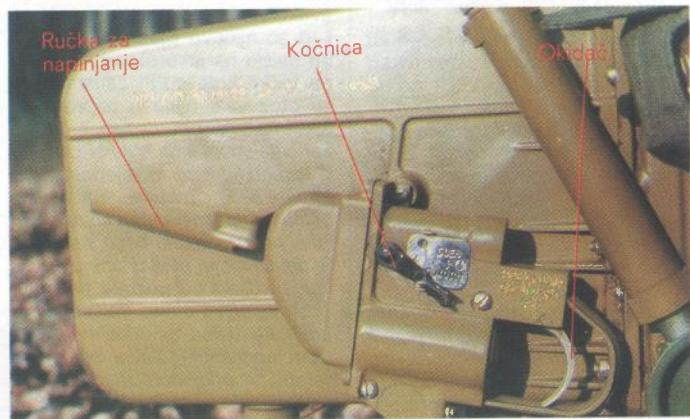
Mehanizam za okidanje PO lansera 9P135M
