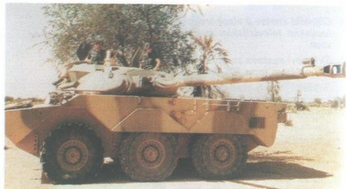
Izvidničko vozilo AMX-10RC 6 × 6 naoružano topom 105 mm snimljeno u Čadu
