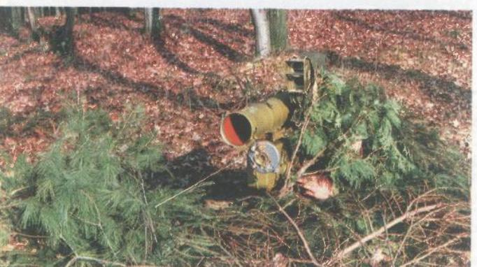
*Raketa je ispaljena a operator do njezinog udara u cilj prati cilj nastojeći pri tome da mu ciljnička točka bude po mogućnosti na najosjetljivijem mjestu tanka. Jasno se vidi mikrokabel koji služi kao veza između rakete i PO lansera*
