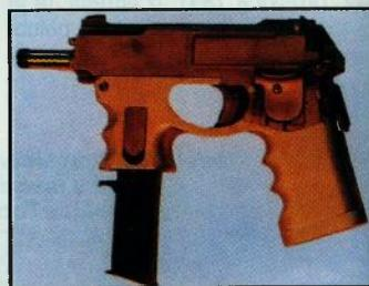
Zanimljivu konstrukciju ima oružje nazvano BUSHMAN. Njegov mehanizam za okidanje zasnovan je na električnom izvoru energije (litijeva baterija), a omogućuje mijenjanje brzina gađanja od 450—1400 metaka u minuti
