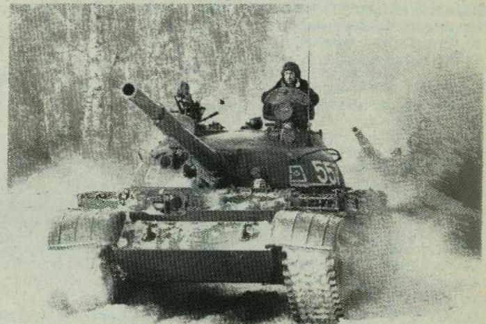
Konstrukcijski ured Vagonka je montirao novi top s glatkom cijevi kalibra 115 mm na proizvedeno tijelo tanka T-55 u promišljanju stvaranja »standardnog« tanka. Model ulazi u serijsku proizvodnju tijekom srpnja 1962. godine kao tank T-62
