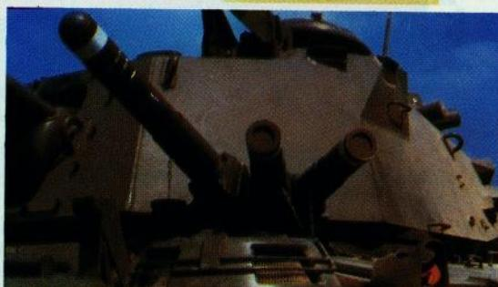
Lanser s pripadajućom osvjetljavajućom raketom smještenom u lanser na prednjoj strani podvoza oklopljenog vozila
