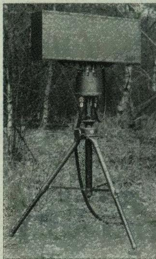
**GB-Scout radar postavljen na tronožno postolje raspolaže FMCW transmisijom s vrlo malom snagom što smanjuje mogućnost njegovog otkrivanja**
