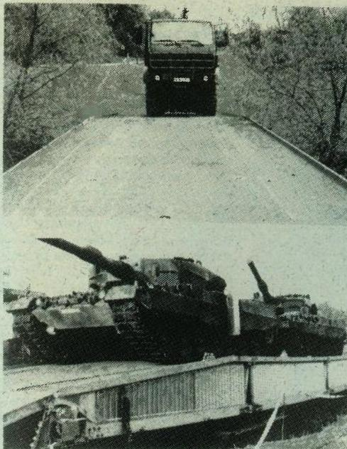
**Korištenje mosta: vozilo, jedan tank, dva tanka Leopard 2, borbeno vozilo pješaštva brzina 25 km/h**
