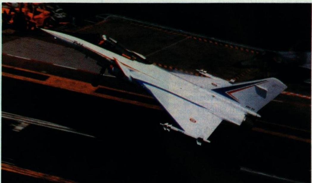
Rafale A korišten je i za vršenje ispitivanja koja su dovele do razvoja mornaričke inačice (na slici Rafale A se vidi prigodom simuliranih slijetanja na nosač zrakoplova)
