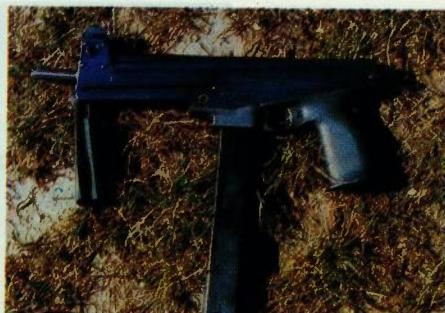
Finska kratka strojnica YATI-MATIC također je napravljena za metak 9 mm Parabellum. Uočavaju se neobični nagibi cijevi i zatvarača koji, prema tvrdnjama proizvođača, olakšavaju nadzor oružja pri brzometnoj palji
