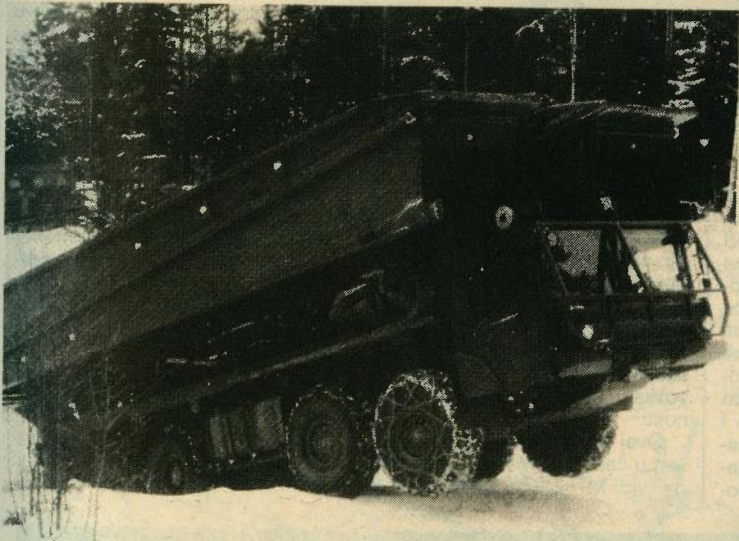
LEGUAN — mostovni sustav MLC 70 kapaciteta — mostovi za suho premošćivanje, 26 m duljine, — mostovi za kratka premošćivanja, 14 m duljine, — skele, 36 m duljine
