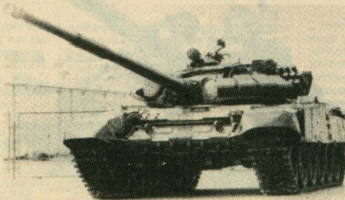
Tank T-90E je najnoviji proizvedeni tank. Za razliku od tanka T-80U koji ima plinsku turbinu od 1250 KS, ovaj tank ima Dieslov motor od 1000 KS, sofisticirani sustav za upravljanje paljbom i novi reaktivni oklop
