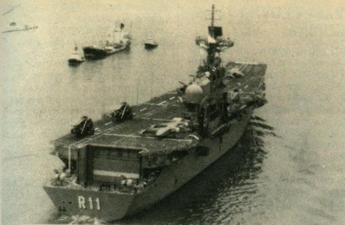
Slika krmenog dijela »Principe de Asturiasa«. Krmeni je lift spušten a vrata broskog hangara zatvorena
