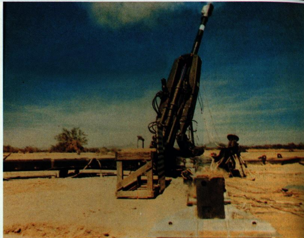
Prototip PT 01 LTH snimljen prigodom ispitivanja paljbe pri velikim kutevima elevacije do 72° u travnju 1991. godine
