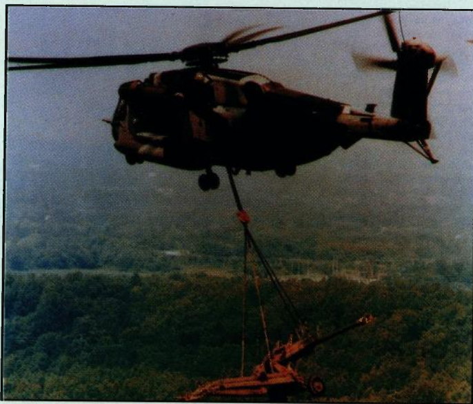
LTH 155 mm može biti prenošena kao podvjesni teret različitih helikoptera. Slika prikazuje prijevoz sa spojenim krakovima i cijevi u prednjem položaju
