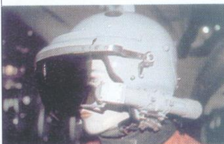
Pilotska kaciga kineske proizvodnje, s mogućnošću prikaza podataka na viziru kacige
