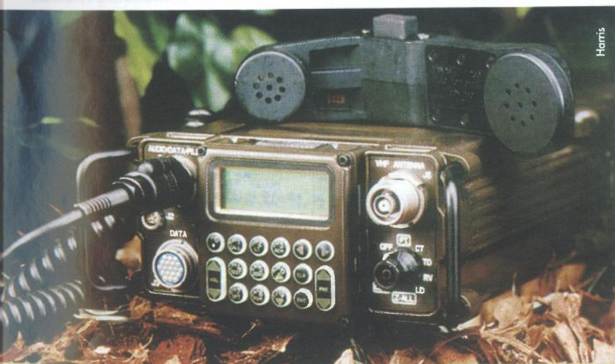
Falcon II VHF radio- jedinstven i SDR kompatibilan programabilni hardver za buduću dogradnju. Obitelj Falcon II sigurno je jedna od najuspješnijih i nedavno je odabrana za britanski "Bowman" HF radioprogram
