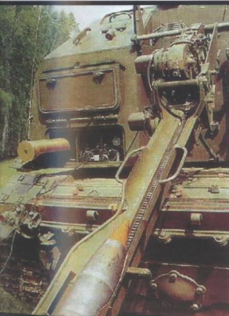
Uređaj za punjenje ili dopunjavanje streljiva u kupolu sustava 2S19
