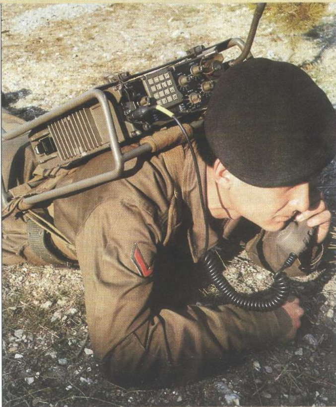
Turska tvrtka "Aselsan" sa svojim VHF/FM taktičkim radiouređajem s frekventijskim skakanjem iz obitelji 9600 uključila se u lanac proizvođača modernih vojnih uređaja
