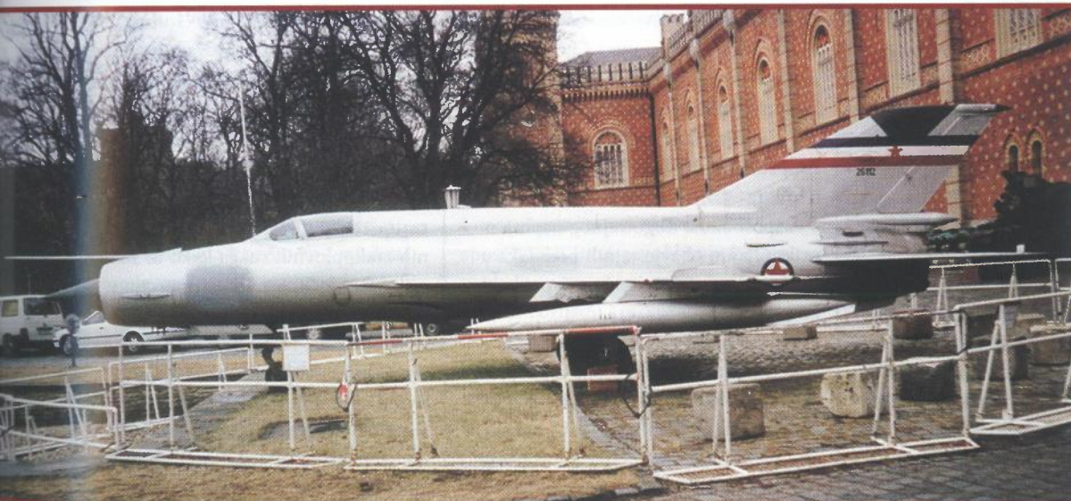
MiG-21R (Ruski "Razvedčik" JNA oznake L-14I; na krajevima krila uočljive su prijamne antene uređaja R-14I za radiotehničko izviđanje)
