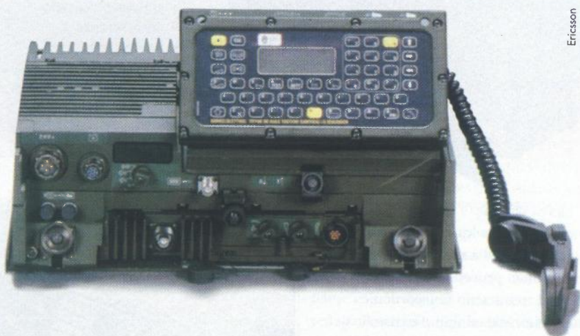
MRR Multi Role Radio (višenamjenski radio)-taktički radio u VHF području za potporu vojnim operacijama modernog digitaliziranog bojišta
