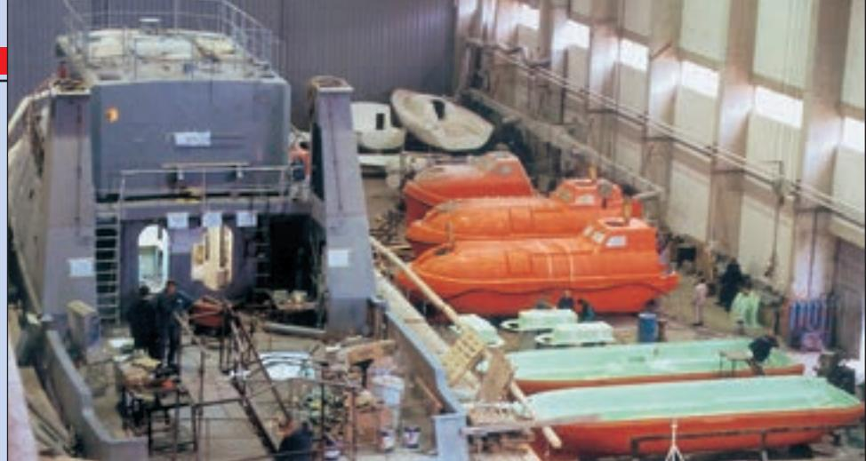
stručnjaci početkom devedesetih godina pri gradnji svojih minolovaca. Dakle, trup broda nema orebrenje (uzdužne i poprečne nosače), kao što je slučaj kod uobičajene konstrukcije trupa koja se primjenjuje pri gradnji brodova. Kako bi se dodatno pojačala konstrukcija, dio pregrada i paluba izvedeni su kao troslojni sendvič paneli s jezgrom od ekspandiranog PVC-a. Uz to, trup broda je s vodonepropusnim pregradama podijeljen na osam vodonepropusnih prostora.
