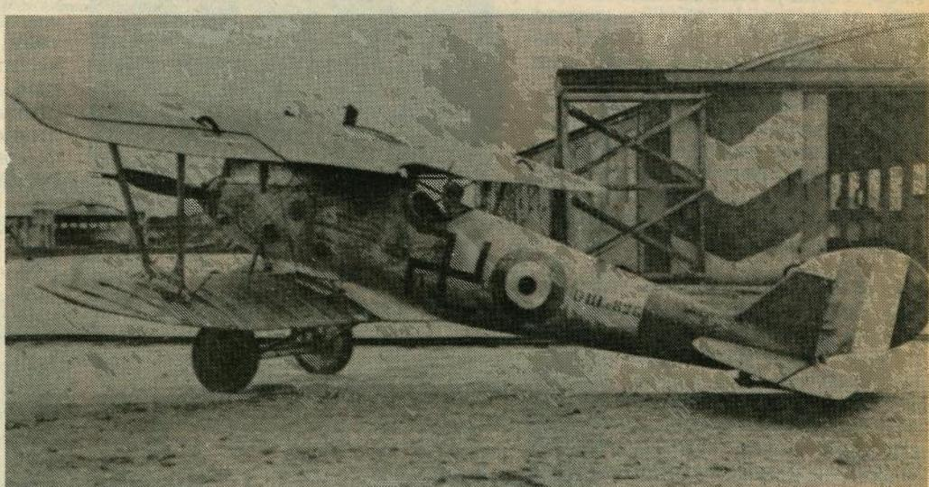
Zaplijenjeni Pfalz D. IIIa 8284/17 s britanskim rondelama. »Hakenkreuz« na trupu ostatak je oznake njemačkog pilota
