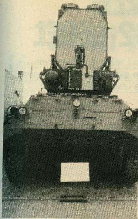
Protutopnički radar ZOOPARK-1 prikazan s prednje strane s podignutom antenom
