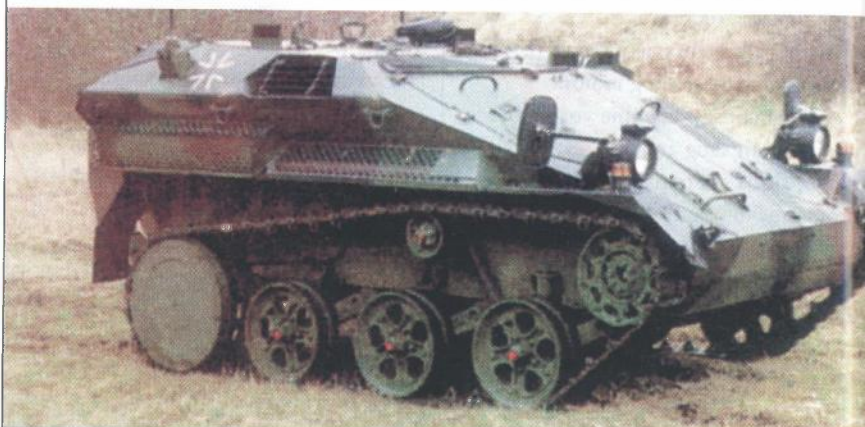
Wiesel 1 baza za laka EBV. U suradnji s vodećim svjetskim proizvođačem elektropogona za vozila - tvrtkom MM Magnet-Motor, tvrtka Rheinmetall Landsysteme je proizvela lako oklopno eksperimentalno vozilo Wiesel 1 - LLX
