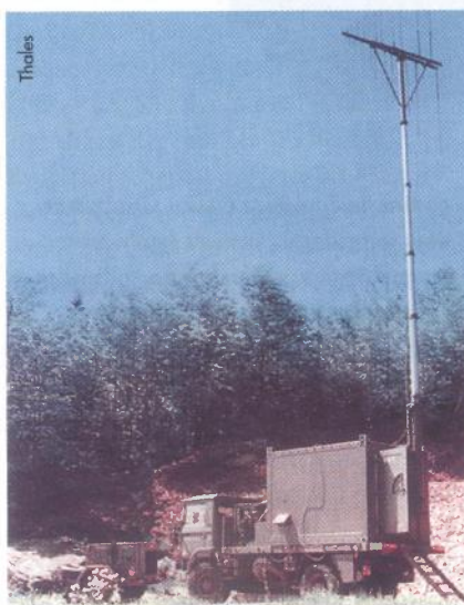
Sustav za ometanje TRC-274 pokriva područje radiofrekvencijskog spektra od 1 MHz do 3 GHz, namijenjen je za neutraliziranje vojnih, paravojnih i civilnih komunikacija
