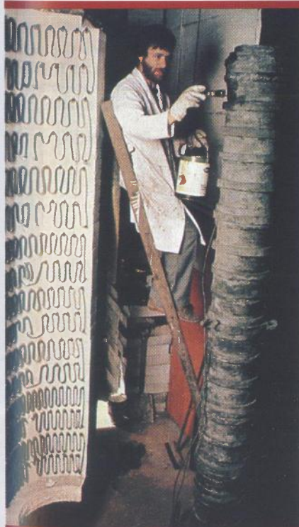
Konzerviranje cijevi željeznog topa. Kako bi se učvrstila i izolirala kovina na nju se nanosi poliesterska otopina. Prije toga cijev je očišćena od morskih naslaga, zatim isprana nitrogenom i vodikom, te potom pečena u visokoj peći na temperaturi od 400° F
