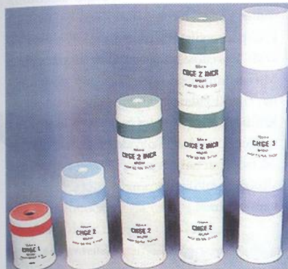
Modularna barutna punjenja M51 do M53. Crvenom bojom je označeno prvo barutno punjenje, plavom drugo barutno punjenje, a zelenom dopunsko. Ljubičastom bojom je označeno treće barutno punjenje za maks. domete
