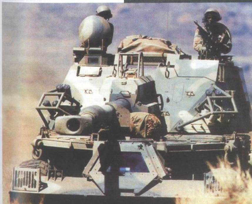
Pogled na prednju stranu topničkog sustava 155 mm G6. Na vrhu kupole je strojica 7,62 mm
