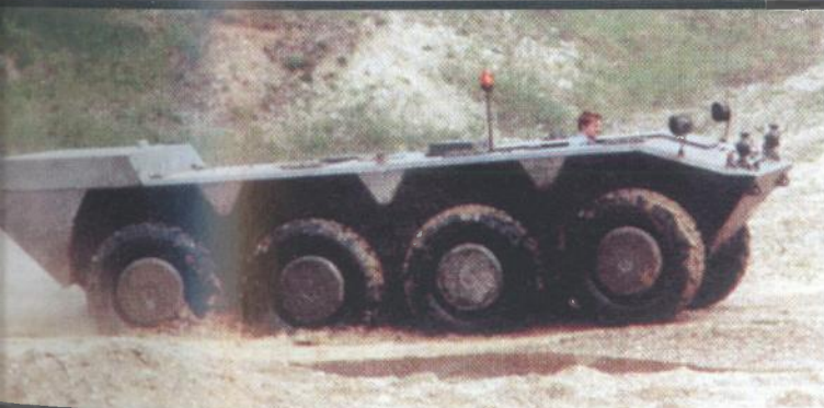
Električno podvozje borbenog vozila, MM demonstrator 8 \times 8 , 600 \text{ kW}
