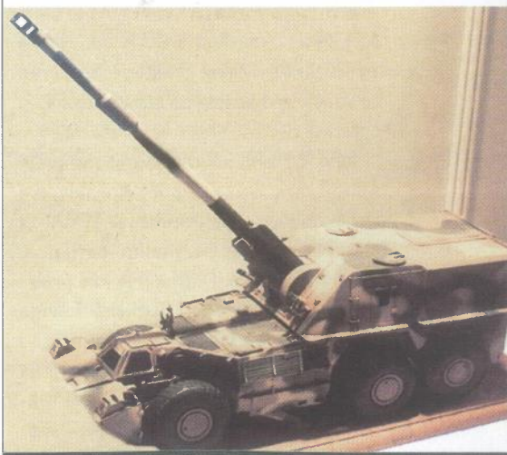
Model budućeg oružja prikazuje modificirano podvozje G-6 za ugradnju kupole T-6 s cijevi dužine 52 kalibara
