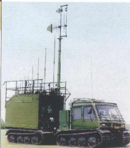
Norvežani su postavili sustav za ometanje "SGS 2000" (tvrtke "EADS") na gusjenično vozilo "Natech P6-300M" pod nazivom "Tor". Pokriva frekvencijsko područje od 1.5 MHz do 1 GHz, a po potrebi može biti prošireno i do 3 GHz
