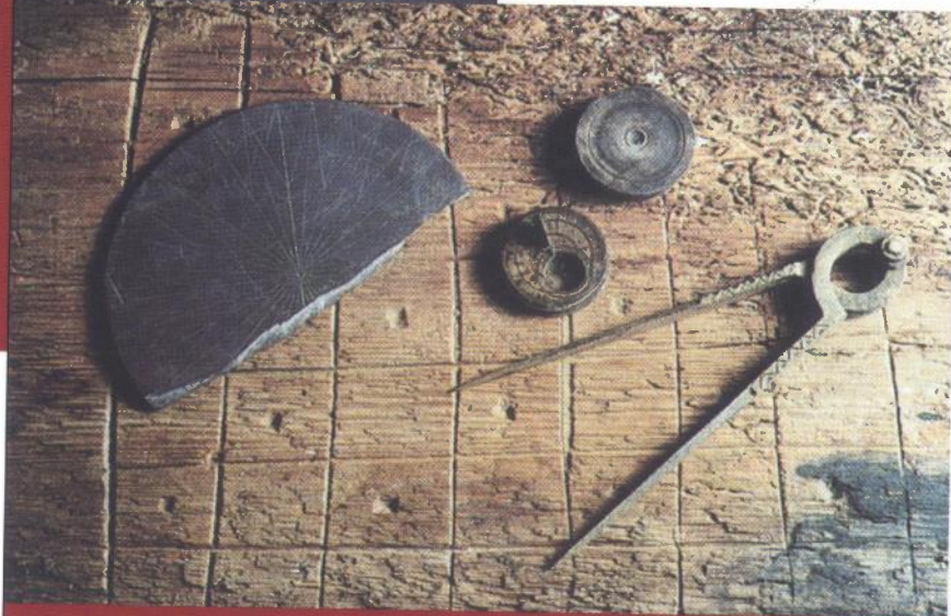
Brodski pribor za navigaciju koji se sastoji od drvene ploče koja je služila kao podloga za pomorsku kartu, kompas, kameni kutomjer i šestar za mjerenje razdaljina
