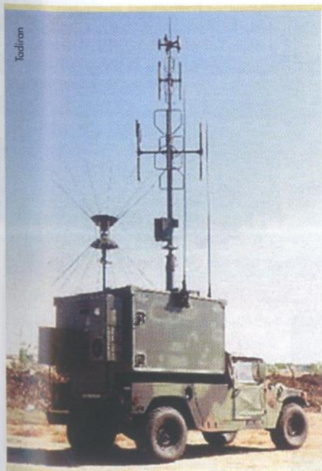
TC/DF sustav montiran na vozilu - svi sustavi ometanja komunikacija, kao i ovaj moraju biti koordinirani, da bi se izbjeglo ometanje vlastitih i "prijateljskih" kanala. Sustav ne otkriva samo mreže koje bi trebalo ometati već zahtijeva da se neke mreže ne ometaju, kako bi se neke primljene poruke mogle iskoristiti kao korisne informacije
