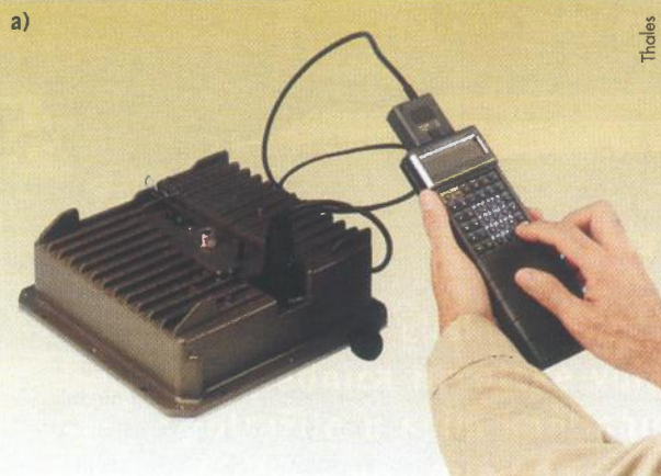
Prijenosni uređaj za ometanje "BLB-20" a) Da bi mogao samostalno djelovati, uređaj "BLB-20" prethodno mora biti napunjen odgovarajućim programima b) Isprogramiran i uključen, ostavljen je da samostalno ometa neprijateljske sustave za vezu
