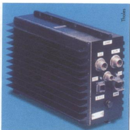
Uređaj za ometanje predviđen za ugradnju na male lagane letjelice. Za vrijeme leta uključuje se i obavlja ometanje neprijateljskih veza u okolišu zone kretanja letjelice
