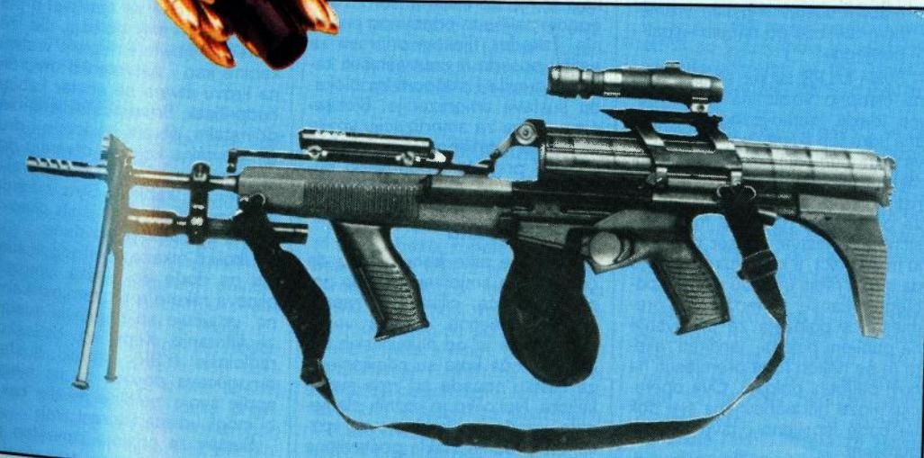
*CALICO model M951-A s različitim dodacima. Uočavaju se nožice, baterijska lampa ispod cijevi, laserski pokazivač, hvatač čahura, te optički ciljnik*
