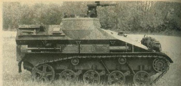
*Wiesel 2 prikazan s boka. Na krovu se vidi strojnica kalibra 7,62 mm*
