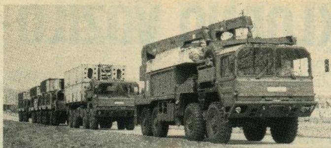
Vozila prenose dijelove za izgradnju Dornierove sklopivog mosta. Na čelu kolone je MAN kamion, vozilo za postavljanje mosta, s dizalicom
