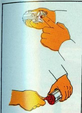
*Postupak napinjanja pogonske opruge spremnika, te način oslobađanja te napetosti*
