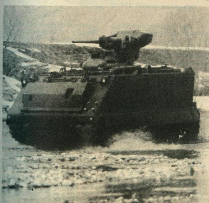
Oklopni transporter M113 od svog nastanka do današnjih dana najrabljenije oklopno vozilo u svijetu. Osim temeljne zadaće za koju je konstruirano, poslužilo je i kao platforma za različite oružničke sustave. Na slici se vidi M113 naoružan automatskim topom Oerlikon kalibra 25 mm
