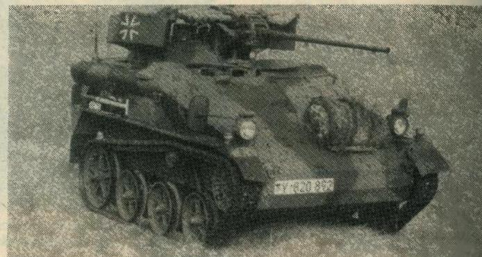
Lako oklopno vozilo Wiesel Mk 20 A1 naoružano s automatskim topom kalibra 20 mm
