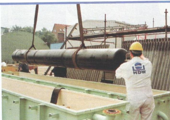
Metal hidridni spremnik vodika namijenjen ugradnji u podmornice iz projekta Type 212A
