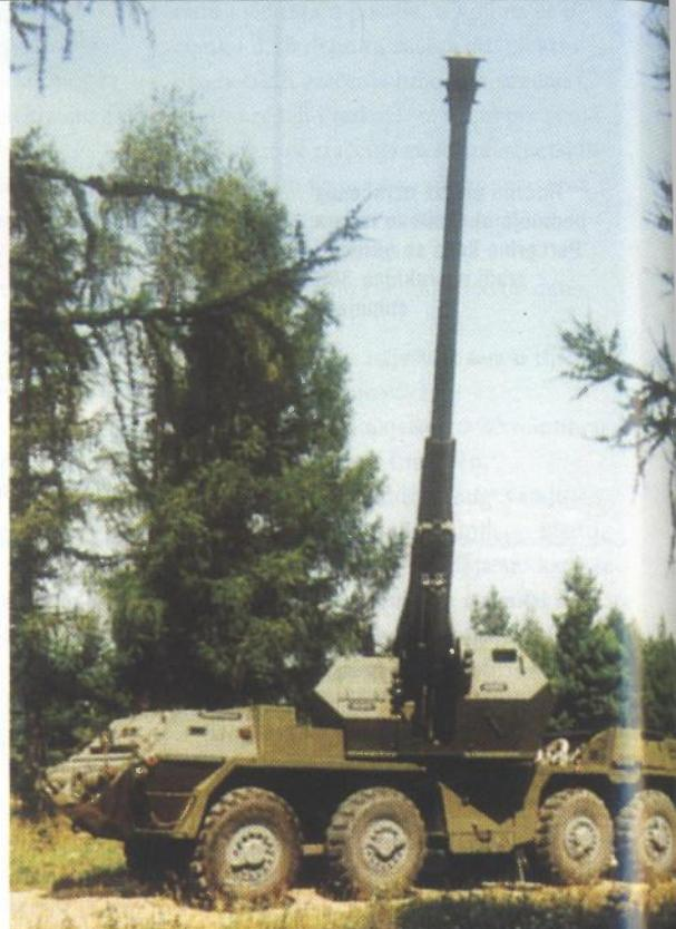
ZUZANA na borbenom položaju spremna za paljbu s cijevi u maksimalnoj elevaciji
