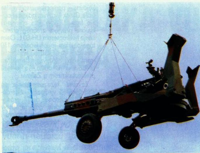
Prenosanje oružja zračnim transportom s preklopjenim krakovima i skupljenim stabilizatorima oružja
