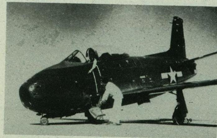
Radi lakšeg smještaja na nosačima na prednji kotač podvozja mogao se postaviti dodatni mali kotač. Kad bi se prednji kotač uvukao, spuštanjem nosa i podizanjem stražnjeg dijela Furya bilo je moguće u ograničenom prostoru hangara nosača smjestiti više zrakoplova
