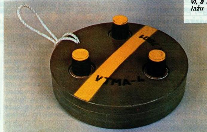
Izgled opremljene mine VTMA-4
