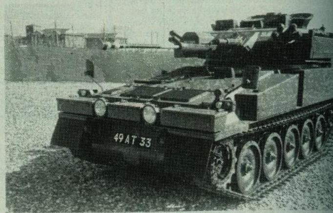
Prototip »novog« oklopnog izvidnika – Sabre proizvod je poznate tvrtke Alvis. Na slici je lako uočljiv nadomjesni prsten bez kojeg se Foxova kupola ne bi mogla postaviti na Scorpionovo podvozje, kao i Rardenov 30 milimetarski top s karakterističnom vrlo dugom cijevi
