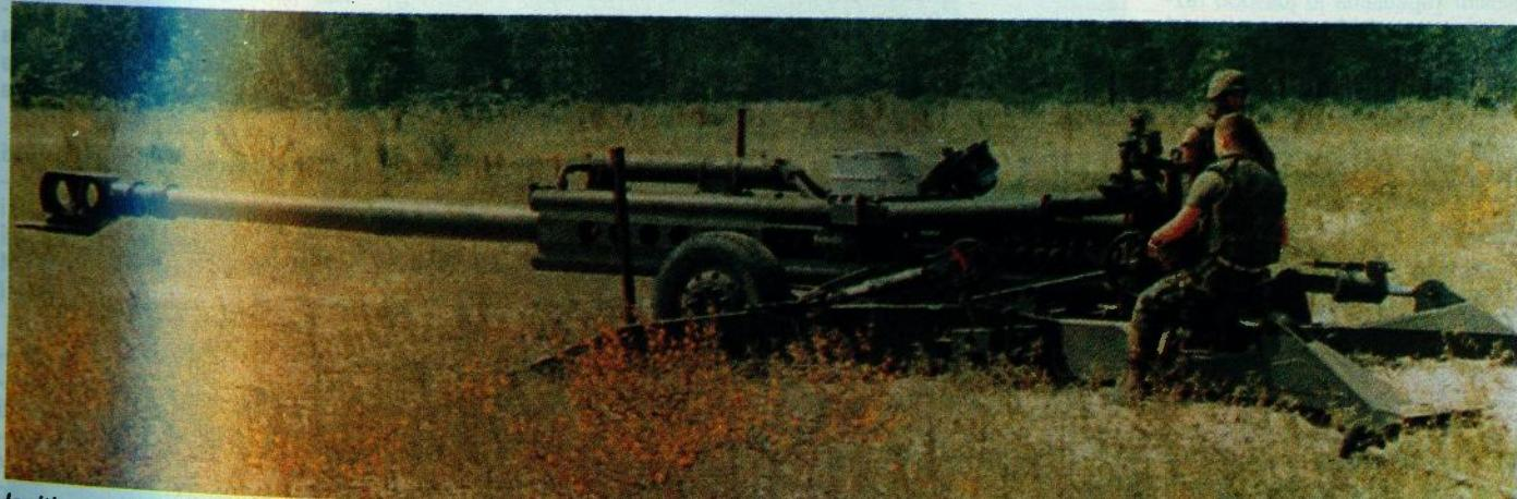
*Ispitivanje oružja pri niskim elevacijama. Obratite pozornost na nisku siluetu oružja na bojnom položaju što je i te kako važno u sustavu otkrivanja položaja*
