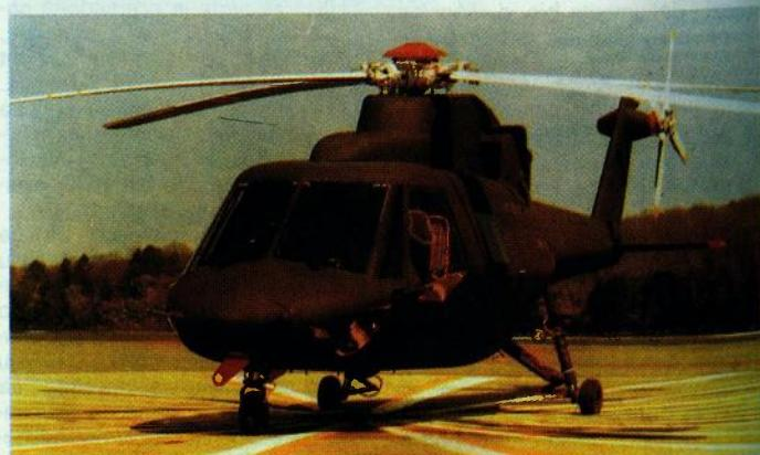
Radi ispitivanja konstrukcije od kompozitnih tvoriva, u okviru programa ACAP korištena su dva tehnološka demonstratora (na slici je S-75 tvrtke Sikorsky)
