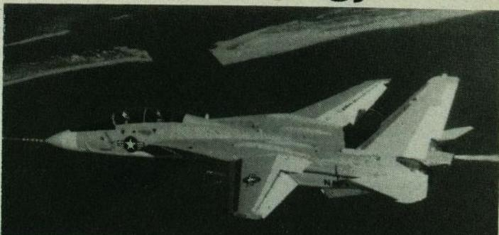
Prvi prototip snimljen u letu 30. prosinca 1970. godine kad je došlo do otkazivanja primarnog a zatim i sekundarnog hidrauličnog sustava (na slici je vidljivo istjecanje hidraulične tekućine) te do gubitka prototipa pri slijetanju
