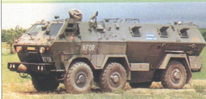
**Višenamjensko oklopno vozilo TATRAPAN, temeljeno na podvozju Tatra T-815 može prevoziti do 12 vojnika s punom opremom, a može se rabiti i u izvidničkim i logističkim postrojbama. Modernizirana inačica MARTAN ima ugrađen motor Deutz BF 6M 1015C sukladan normama Euro I i II, a u uporabi je od 2000. godine**
