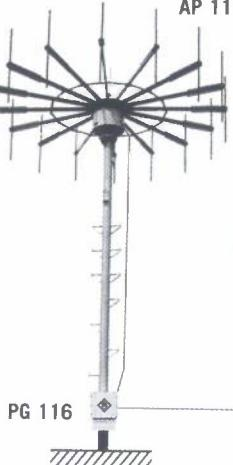
**Konfiguracija radiogoniometra PA100 (goniometarska antena AP116, jedinica za skeniranje PG 116, goniometarska jedinica PP100 i operatorska jedinica za upravljanje i obradu podataka PB 100)**
