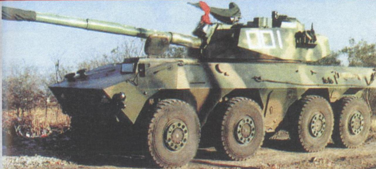
**K**ina je razvila novo kotačno oklopno vozilo/lovac tenkova konfiguracije 8X8 opremljen topom od 120mm. Vozilo je temeljeno na produženom i redizajniranom podvozu oklopног transportera NORINCO WZ 551 6X6 koji je u naoružanju kineske vojske. Za sad se još ne zna njegova službena oznaka.
