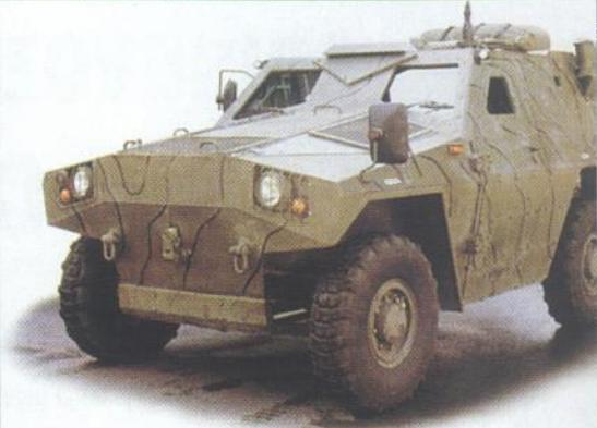
Oklopno amfibijsko vozilo 4x4 ALIGATOR PVS koje može imati višenamjensku funkciju
