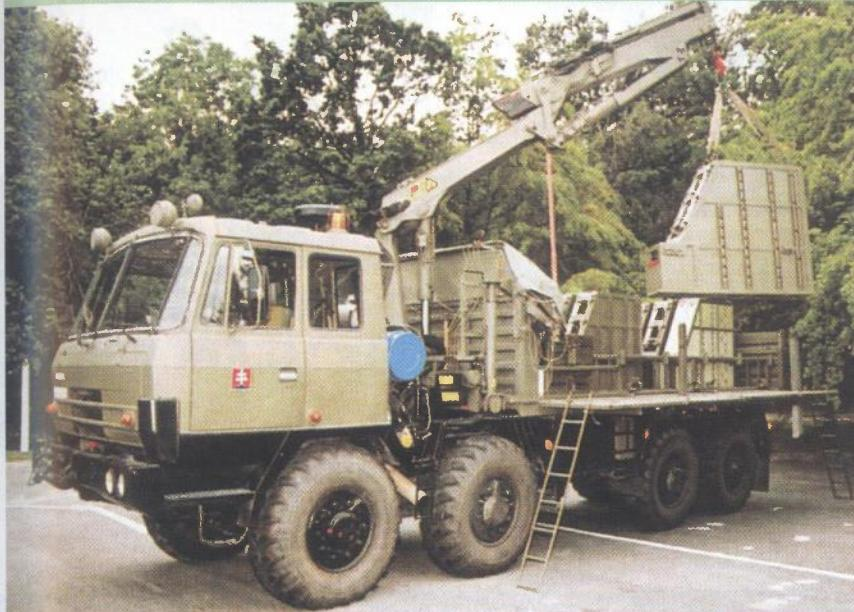
Specijalizirano vozilo za prijevoz streljiva namijenjenog PZ sustavu BRAMS. Prevozi 4.800 metaka kalibra 30 mm i 8.000 metaka kalibra 7,62 mm
