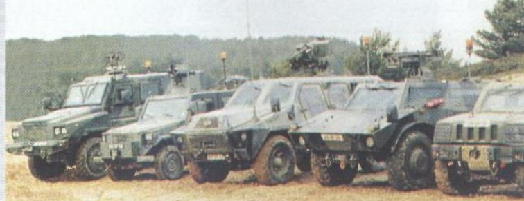
Svi kandidati na FCLV izboru. S lijeva na desno: RG-31M, RG-32M, VLRB, Scarab i MLV
