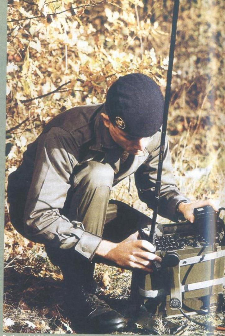
Radiouređaj PR4G prije uporabe potrebno je napuniti programima i početnim podacima pomoću jednostavnog prijenosnog uređaja za punjenje (Fill Gun)
