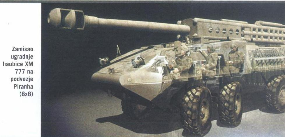
Zamisao ugradnje haubice XM 777 na podvozje Piranha (8x8)
