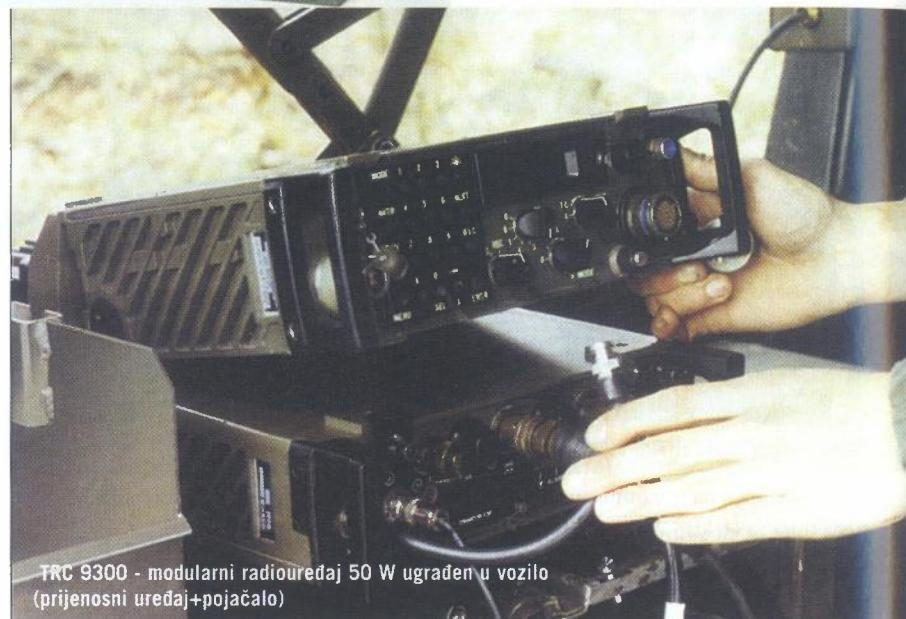
TRC 9300 - modularni radiouređaj 50 W ugrađen u vozilo (prijenosni uređaj+pojačalo)
