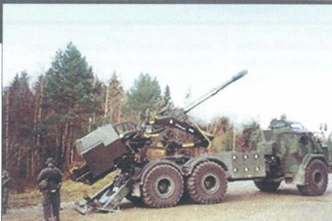
Stručnjaci tvrtke Bofors Weapon Systems ugradili su haubicu modela FH-77 na kamionsko podvozje VME A25C Volvo
