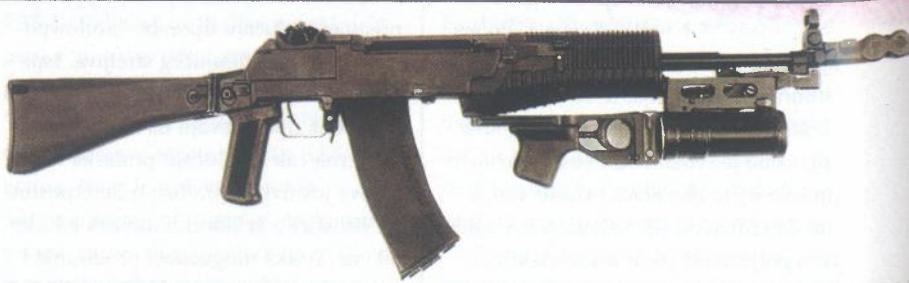
Izgled automatske puške AN-94 s montiranim bacačem granata ispod cijevi
