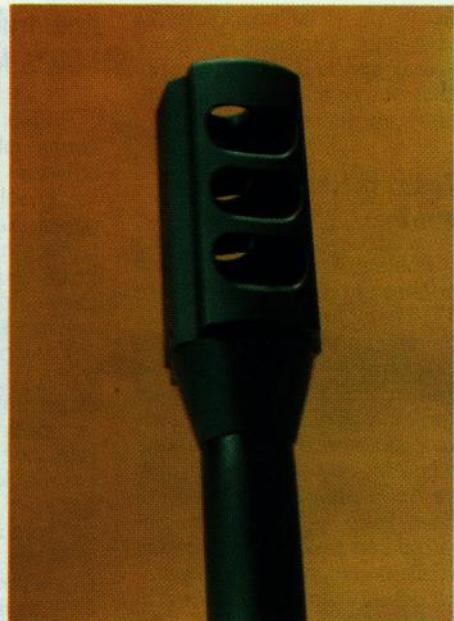
Izgled plinske kočnice čija je zadaća smanjivanje trzanja puške nakon opaljenja. Kočnica je troredna s bočnim otvorima izrađenim pod određenim kutom
