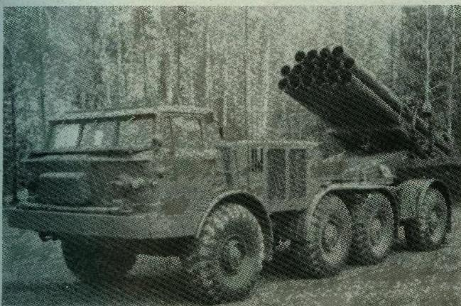
VRL BM 9P140 Uragan kalibra 220 mm postavljen u paljbenu poziciju s podignutim lanserom i spuštenim stabilizatorima
