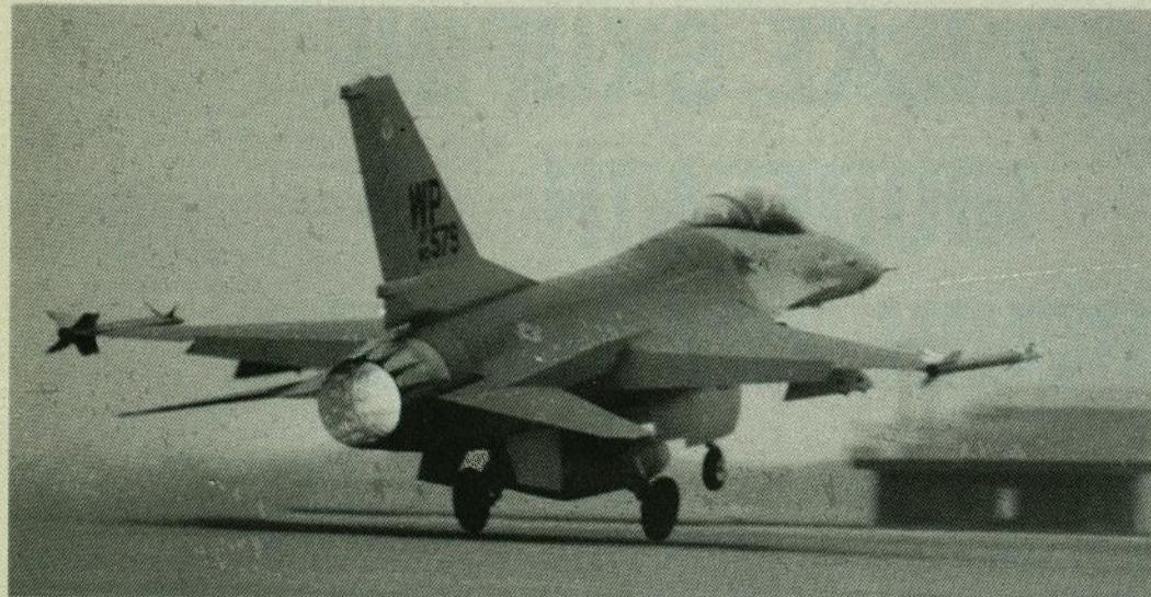
**Najmasovniji lovac u naoružanju zapadnih zrakoplovstava, F-16 Fighting Falcon ima pogonsku skupinu koja se sastoji od jednog turboventilatorskog motora F100**
