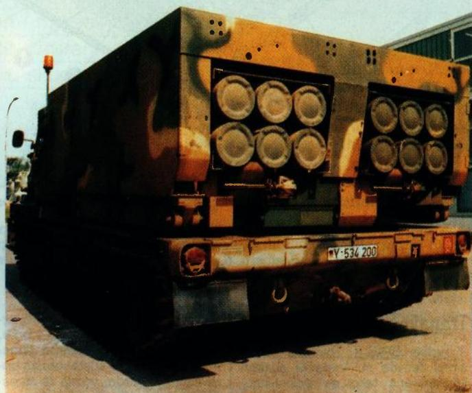
**MLRS s montiranim raketnim simulatorom (zelena kutija) koji može simulirati sve sekvence prigodom provođenja procedura paljbe i to za različite tipove raketa**
