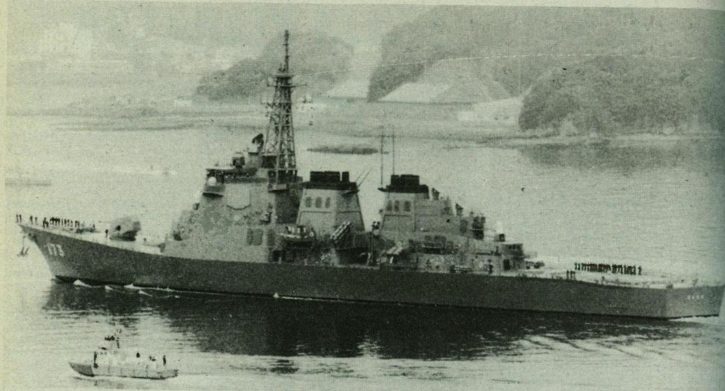
*Na ovoj fotografiji vidi se jedna od antena radara RCA SPY 1D, smještena na boku prednjeg nadgrađa, ispod zapovjednog mosta*
