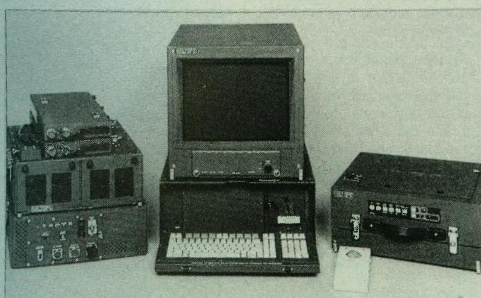
*Sklopovska oprema sustava AFATDS uključuje FSCT (Fire Support Control Terminal) prikazan na slici, koji upravlja računalskim postajama povezanim u LAN. FSCT Milope, koji se temelji na PA-RISC arhitekturi Hewlett-Packarda, obavlja operacijske proračune i nadzire spremanje podataka i programa. Ostali veći čimbenici sustava su FST (Fire Support Terminal) na LCU računalu i TDD (Tactical Display Device)*
