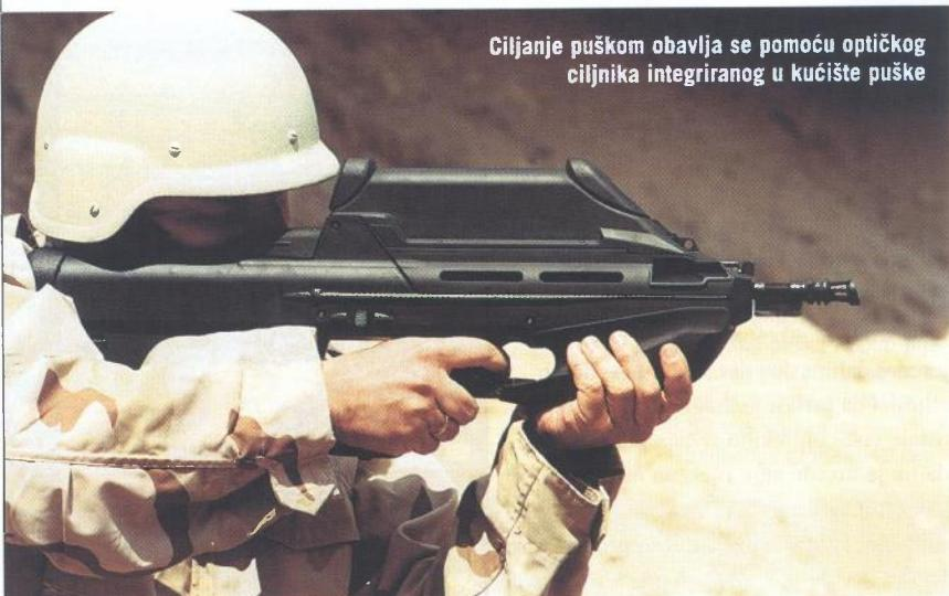
Ciljanje puškom obavlja se pomoću optičkog ciljnika integriranog u kućište puške
