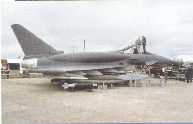
Aerodinamički oblikovanim CFT-ima opremljen je i Eurofighter Typhoon
