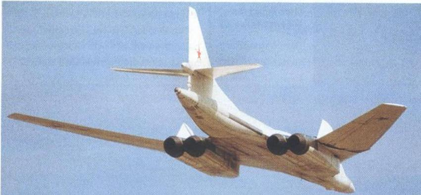
Konstrukcija gondola je znatno naprednija nego na B-1B, što je izazvalo veliko iznenadjenje na Zapadu. U gondoli su ugrađivana četiri Samara NK-321 turbofan mlazna motora, po dva u svaku gondolu. Motor NK-321 imao je maksimalnu snagu od 137,3 kN suhog i 245 kN potiska s naknadnim izgaranjem, što je 79 posto više snage nego kod konkurenata B-1B
