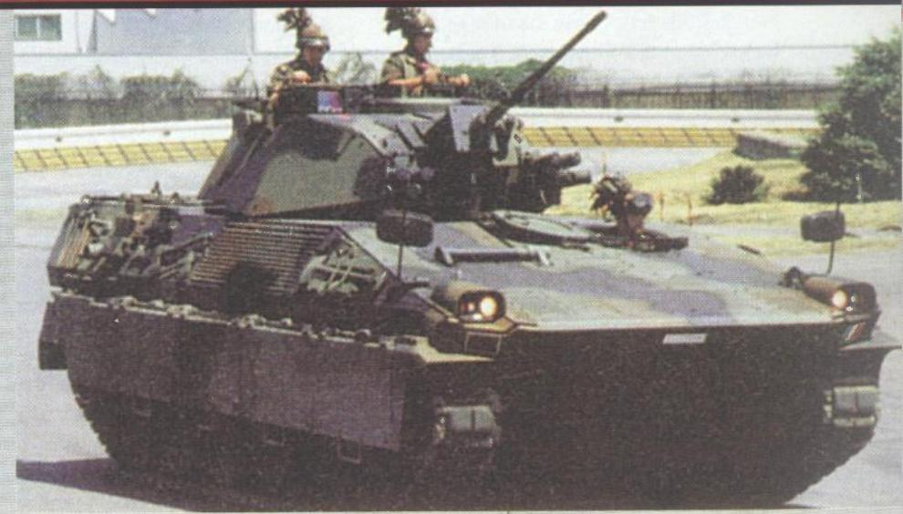
Dardo je težak 23 tone ali mu se može postaviti i dodatni oklop težine tri tone. Pokreće ga Ivecov motor snage 383 kW (520 KS). Mogućnosti daljnog usavršavajnog Darda su brojne i obećavajuće. Razvijeni su novi IC periskop topnika, panoramski periskop zapovjednika te novi navigacijsko-zapovjedno-nadzorni sustav SICCONA.
