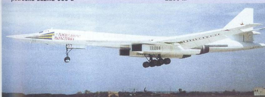
Stajni trap Tu-160 je masivan i prilagođen za loše USS-e, ili za betonske staze prekrivene snijegom. Glavne noge stajnog trapa imaju čak šest kotača što je znatno utjecalo na težinu. Zbog gondola na krilima razmak glavnih nogu stajnog trapa relativno je mali.
