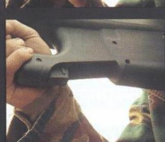
Utvrđivač spremnika ima takav oblik i položaj da je i ljevacima i dešnjacima vrlo jednostavno izvaditi ili staviti spremnik.
