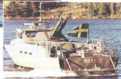
njač minobacača je hidraulični i omogućava punjenje svakih trideset sekundi. Kupola je opremljena suvremenim računalnim sustavom za usmjeravanje paljbe.
