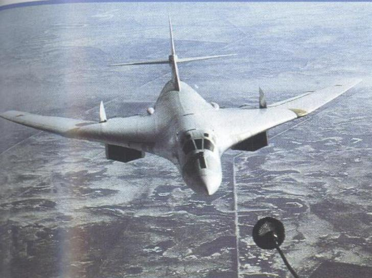
**Vrlo neobična fotografija prilaska Tu-160 na dopunu gorivom u letu tankeru Il-78 Midas pri vrlo velikoj brzini (krila su na 35°, s podignutim vertikalnim pretkrilcima radi bolje upravljaljivosti)**
