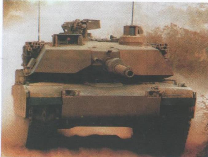
Suvremeni glavni borbeni tank M1A2 Abrams naoružan topom kalibra 120 mm s glatkom cijevi
