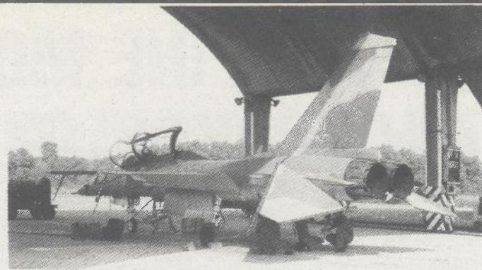
*Novi tajvanski lovac AIDC Ching-Kuo ima pogonsku skupinu od dva turboventilatorska motora TFE 1042-70. Ovaj motor modularnog dizajna pripada obitelji motora koja uključuje i F124-GA-100 ponuđen kao direktna zamjena za Adour Mk 871/F405 na T-45 Goshawku*
