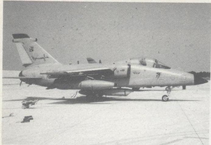
**Jurišni zrakoplov AMX iz sastava 3º Stormoa, opremljen s izvidničkim spremnikom Orpheus, spremnik je postavljen na središnji podtrupni nosac (snimio F. Grattioni)**
