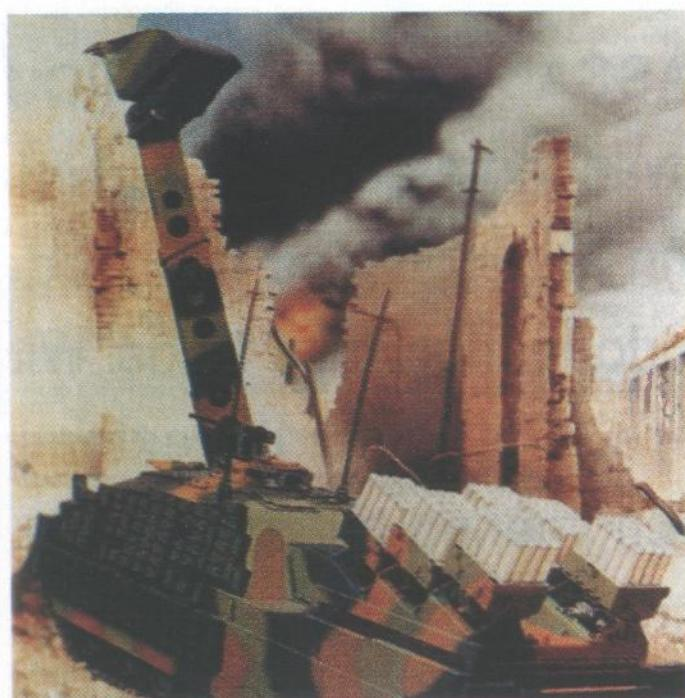
*Posljednja novost u tankovskoj obitelji je opkoparsko vozilo zasnovano na Leclerc tanku, proizvod tvrtke Giat. To vozilo ima kompletni dodatni kotači za kretanje po cesti, dozersku oštricu, rovokopač, Minotaur minoplač i Demeter magnetski uredaj za aktiviranje mina*
