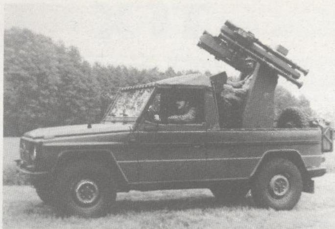
**Vozilo Mercedes-Benz s uređajem LLADS u borbenom položaju**
