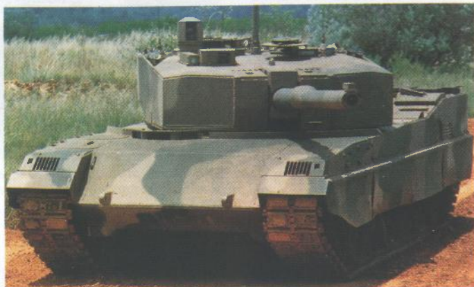
TTD (Tank Technology Demonstrator) zamišljen kao program demonstracije razvoja tehnologije čime bi Olifant 1B dobio dostojnog zamjenika. Predstavlja povećanje paljbene moći, zaštite i mobilnosti
