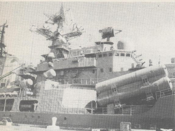
Lanseri protubrodskih projektila SS-N-22 na razaraču klase »Sovremenij«, te kupola radara Band Stand i antena radara Top Steer
