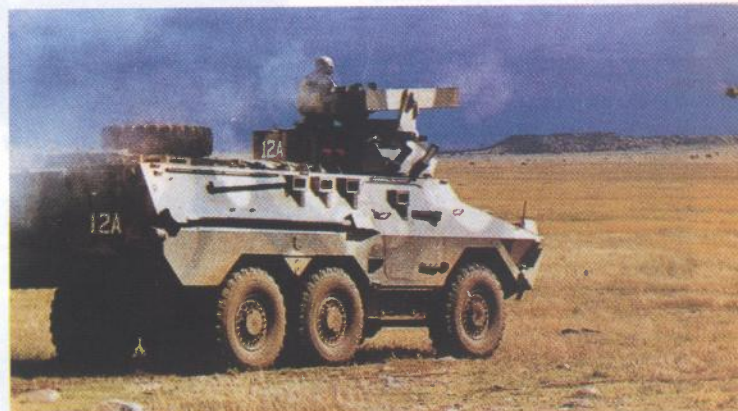
Ispaljivanje protuoklopne rakete ZT-3 Swift tijekom ispitivanja borbenih performansi oklopnog vozila Ratel
