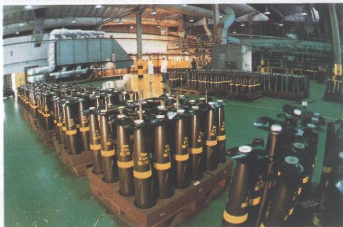
Denel je poznat po širokom spektru proizvodnje streljiva. Slika pokazuje laboraciju streljiva 155 mm ERFB-BB za korištenje iz G5 i G6 te kompatibilnih sustava
