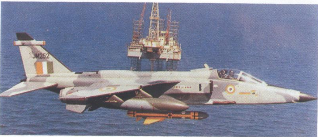
Omanski Jaguar International s protubrodskim projektilom BAe Sea Eagle na podtrupnom nosaču (vidi se i promijenjen oblik nosa zrakoplova, zbog smještaja radara Agave)
