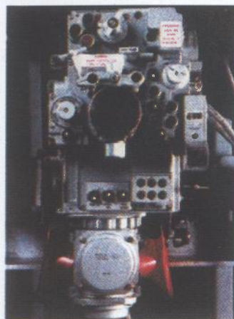
Dnevna ciljnička naprava s laserskim daljinometrom, standardna oprema ruskih tankova T-72, poznata kao TPDK-1
