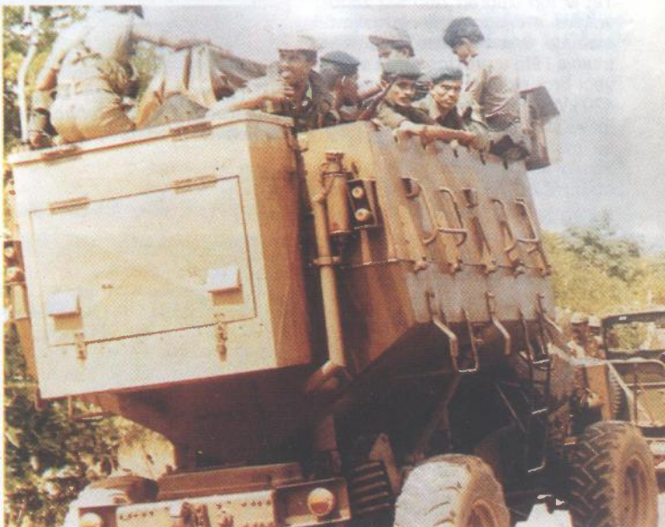
Buffel APC 4x4 karakteristično po »V« obliku poda koji omogućuje maksimalnu zaštitu od nagaznih mina
