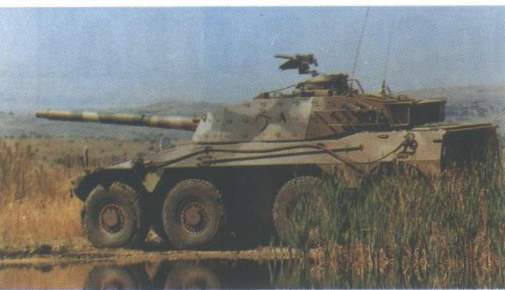
Rooikat 8x8 originalna izvedenica naoružana topom 76 mm dok se za izvoz nudi s topom 105 mm
