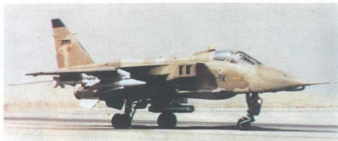
Francuski Jaguar A snimljen tijekom Desert Storma, prigodom uzleta (vidi se naoružanje od projektila zrak-zrak Magic 550, projektila zrak-zemlja AS30L, spremnika s ATILISOM na središnjem podtrupnom nosaču, kao dodatni spremnik goriva na desnom podkrilnom nosaču koji služi za balansiranje mase AS30L)
