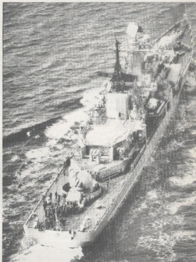
Snimka razarača tipa »Sovremenij« s novim radarom za nadzor zračnog prostora tipa »Top Plate« i zatvorenim vratima hangara
