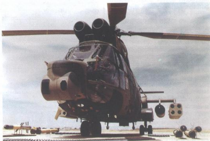
Helikopter Puma s pripadajućom borbenom opremom. Slika prikazuje u nosu ugrađen ciljnik za protuoklopne rakete ZT-3
