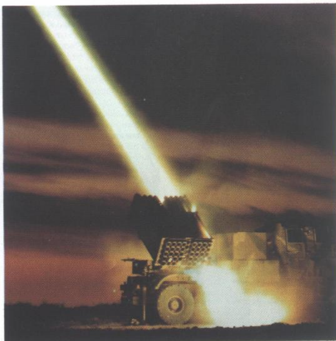
Bateleur-40 višecjevni lansirni sustav kalibra 127 mm dometa gotovo 37 km
