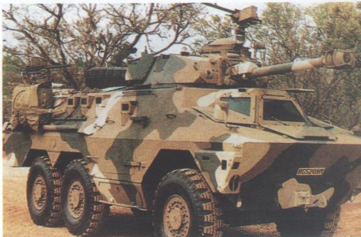
Ratel FSV 90 naoružan protuoklopnim topom kalibra 90 mm i protuzrakoplovnom strojnicom kalibra 7,62 mm
