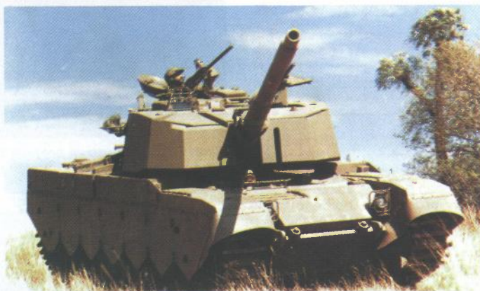
Olifant 1B kupola se sastoji od specijalnog oklopa koji formira kupolu glatkih površina
