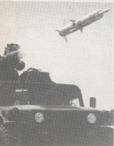
Protuoklopni vođeni raketni sustav (POVRS) TOW namijenjen za protuoklopnu borbu na udaljenostima do 4 km postavljen na visoko pokretljivo terensko vozilo HUMMER u trenutku paljenog djelovanja
