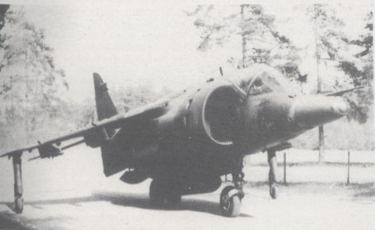
Jedan od načina smanjivanja zahtjevnosti prema zemaljskim instalacijama unutar zrakoplovnih baza je konstruiranje zrakoplova s vertikalnim uzlijetanjem i slijetanjem, poput britanskog Harriera. To nije idealan pristup, jer razvoj ovakvog tipa zrakoplova zahtijeva velika sredstva
