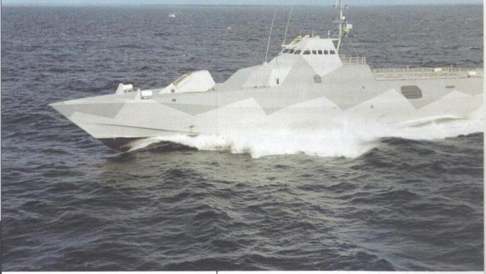
korvetu na udaljenosti od 11 kilometara pri mirnom i na udaljenosti od osam kilometra na nemirnom moru. Za usporedbu brod sličnih dimenzija radari otkrivaju na udaljenosti od 50 kilometara ili više. Kako velika većina suvremenih protubrodskih projektila ima radarsko navodenje na cilj, sve korvete kalse Visby, zbog svoje niske radarske zametljivosti, bit će vrlo otporni ciljevi.
