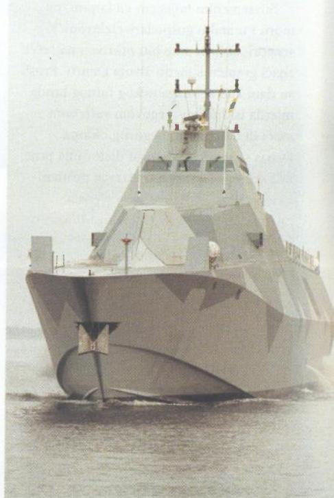
koja se sastoji od staklougljičnog/vinil laminata s PVC jezgrom (carbon fibre reinforced plastic - CFRP). Prema tvrdnjama proizvođača (japanska tvrtka Toray Industries) ovaj materijal u odnosu na druge do sada rabljene ima veću čvrstoću i krutost, što omogućava manju deblinu stjenki i manju masu (istisninu). Uz to pokazuje dobru otpornost na šok podvodnih eksplozija, mali radarski odraz i zamalo nikakve magnetske odlike. Sve to po vrlo prihvatljivo cijeni.
