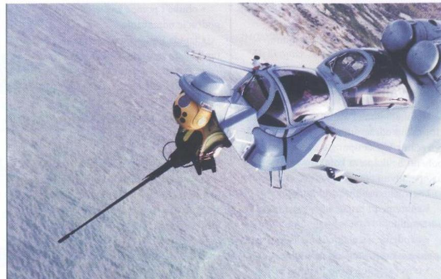
Na SuperHind MkIII ugrađen je 20 mm top, s dva odvojena kanala dovoda streljiva
