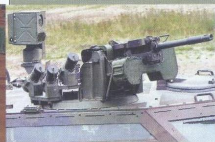
Na njemačkoj izvidničkoj inačici postavljen je automatski bacač granata Heckler&Koch kalibra 40mm
