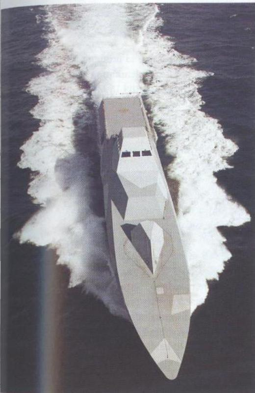
ljeni su od ravnih ploča koje se proizvode procesom vakumskom ubrizgavanja. Rabi se tehnologija proizvodnje relativno velikih ploča koje se potom spajaju lijepljenjem. Uporabom kompozitnih materijala istisnina trupa i nadgrada smanjenja je za 50 posto u odnosu na masu koju bi imala ista konstrukcija napravljena od čeličnih ploča. Rezultat je veća nosivost naoružanja i opreme, veća maksimalna brzina i veća autonomnost djelovanja.
