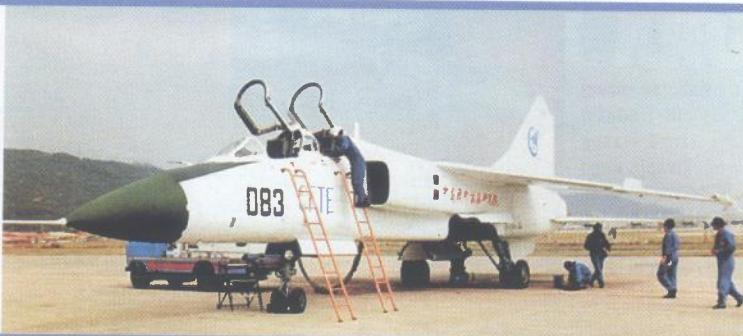
fotografija JH-7 ima po dva nosača naoružanja na krilima (jedan potkrilni i jedan na vrhu krila), Kinezi su predstavili maketu Flying Leoparda s čak četiri nosača na svakom krilu. Repni horizontalni stabilizatori su jednodijelni, a po izgledu podsjećaju na one postavljene na Q-5.
