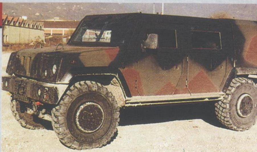
Postoje dva dodatna oklopna kompletata. Temeljni i komplet za pojačanu oklopnu zaštitu. Odlika dodatnih oklopnih kompletata kod Ivecia LMV je da se oni postavljaju tijekom sastavljanja vozila, a ne nakon dovršetka, na dovršeno vozilo kao što se radi kod drugih sličnih sustava.
