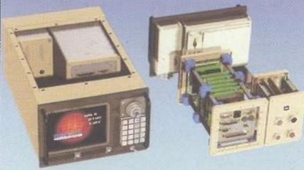
komercijalni opskrbljivači nude hardver koji ispunjava zahtjeve za višu razinu temperaturne osjetljivosti kao i osjetljivosti na vibracije. Takav hardver može izdržati ekstremne vrućine, hladnoću, vlagu, potrese i vibracije, ili se pak manjim doradama za to može priлагoditi.
