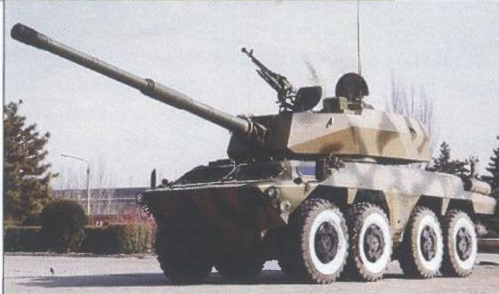
**Dobre odlike topa 120 mm ponukale su Kineze da naprave lovca tenkova na kotačima koji je baziran na oklopnom vozilu WZ-551 8x8. Za to novo vozilo razvijena je nova kupola i ugrađen novi sustav za usmjeravanje paljbe**
