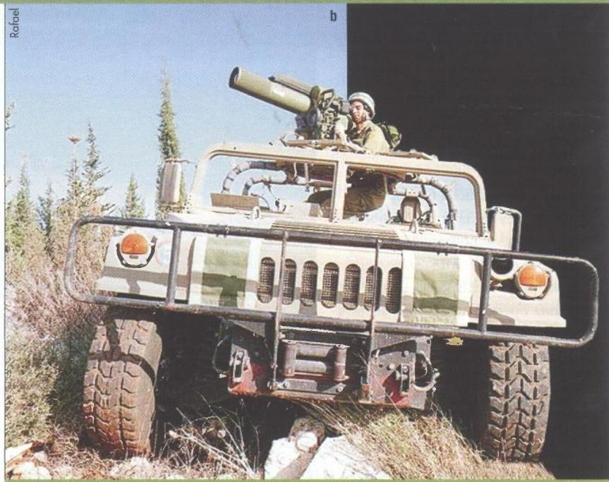
kete (tandem sustav) - prekursor i glavna bojna glava - sposobne su poraziti klasični oklop zaštićen ERA oklopom svih modernih tenkova. Visoka učinkovitost na cilju postignuta je uporabom obrušavajuće trajektorije, visoke preciznosti i tandem bojne glave.
