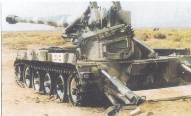
Masivna platforma onemogućava nekontrolirano pomicanje i poskakivanje vozila
