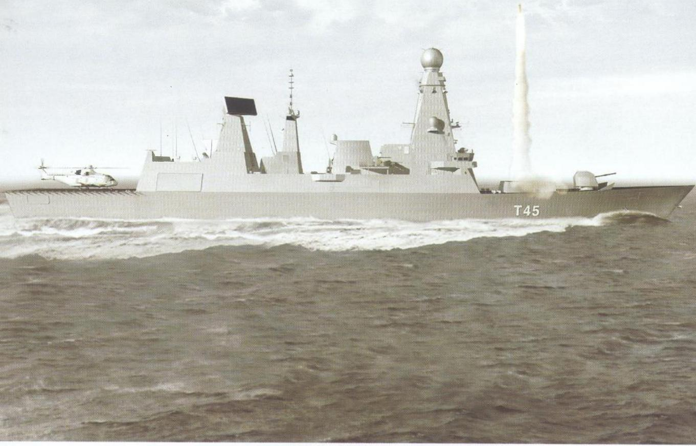
ki radar - postaviti na vrh jarbola 35 metara iznad morske povšine. To bi trebalo biti dosta dobitno za djelotvorno promatranje zračne i morske površine.
