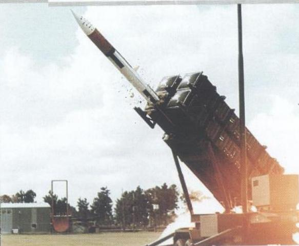
Nakon probijanja membrane prilikom izljetanja projektila, njegov let u početnom dijelu usmjerava cjevasta unutrašnjost spremnika
