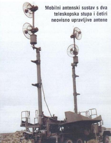
Mobilni antenski sustav s dva teleskopska stupova i četiri neovisno upravljevine antene
