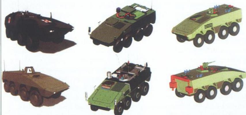
**Osnovnih pet partnerskih inačica GTK vozila:** Oklopni transporter pješaštva GTP (GE), APC (UK); Zapovjedno vozilo CP (UK), CP (NL), FuFz (GE); Vozilo za zahtjeve održavanja BDR (NL); Transportno vozilo (CAR (NL); Sanitetsko vozilo / Evakuacija AMB (NL), ATEV (UK)
