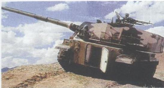
**Velika vrata na stražnjem dijelu vozila znatno povećavaju razinu sigurnosti jer posadi omogućavaju brzo napuštanje vozila u slučaju opasnosti. Uz to olakšavaju unošenje streljiva u vozilo**
