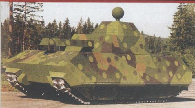
**K**onzorcij švedskih tvrtki razvio je stealth tenk koji je predan Upravi za obrambeno opremanje na testiranja. Konzorcij čine tvrtke Hägglunds Vehicle (odgovorna za podvozje, elektrooptičke
