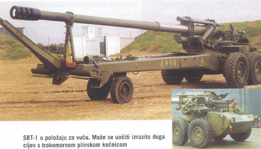
SBT-1 u položaju za vuču. Može se uočiti izrazito duga cijev s trokomornom plinskom kočnicom
