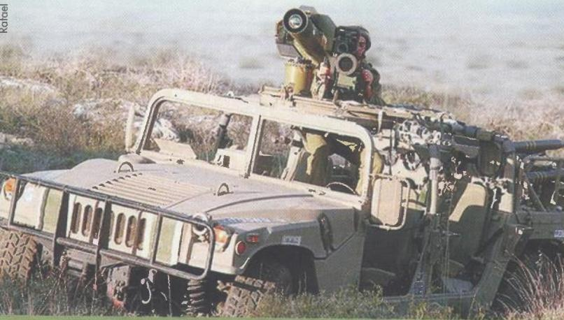
Raketni sustav SPIKE-ER u prijenosnoj inačici na paljbenom položaju. Ova je inačica sastavni dio vozeće inačice instalirane na terenskom vozilu (Hummer), a sastoji se od zapovjedno-lansirne jedinice s kompletom raket instaliranom na tronožnom postolju, vrlo sličnom postolju američkog POVRS-a TOW. Prijenosna inačica može se postaviti na paljbenе položaje do kojih nije moguće pristupiti vozilom.
