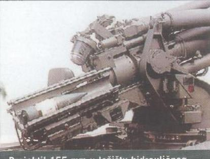
Projektil 155 mm u ležištu hidrauličnog punjača streljiva koji ima elektronički sustav nadzora
