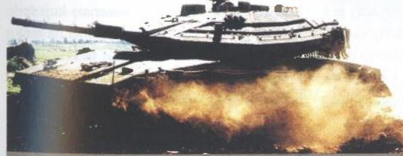
**Ugradnjom motora snage 1500 KS i zadržavanjem mase na 65 tona znatno je povećana pokretljivost koja je sada usporediva sa suvremenim tenkovima Zapada**
