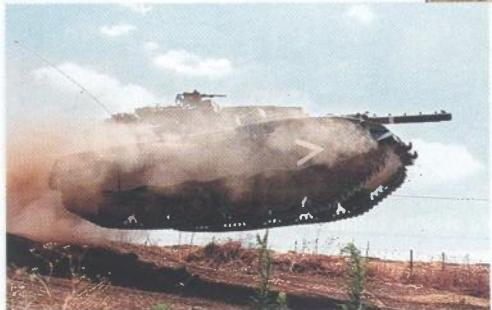
Prigovori o nedovoljnoj pokretljivosti Merkava Mk 1 i Mk 2 donekle su otklonjeni sa Merkavom Mk 3 u koju je ugrađen motor od 1200 KS. Novo, znatno unaprijeđeno podvozje omogućava veliku brzinu vožњe po lošim putovima ili van njih
