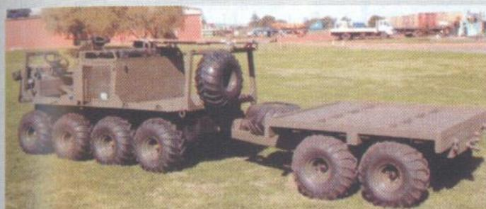
jnicu kalibra 7,62 mm postavljenu na držać na prednjem dijelu vozila. Vozilo na posebnoj platformi-prikolici može prevoziti veća oružja kao minobacač kalibra 120 mm ili netržajni top. Ukoliko je riječ o manjem oružju, npr. minobacaču kalibra 81/82 mm, tada se oružje postavlja na stražnji dio Gecka.
