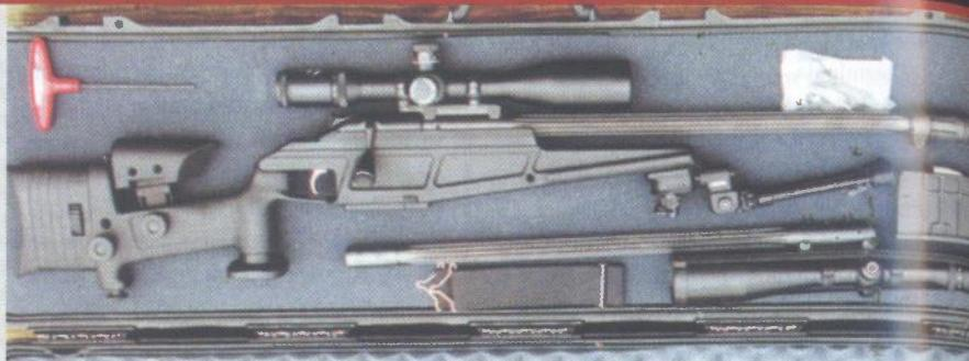
osjeća kao trzaj slabijeg metka kalibra 7.62x51 mm. Plinska kočnica ne narušava preciznost puške. Cijev puške se može promijeniti vrlo jednostavno, a cijela operacija traje nekoliko minuta. Svi čelični dijelovi puške imaju posebnu završnu obradu kako bi bili otporni na koroziju. Na pušku se može postaviti i remen za nošenje.
