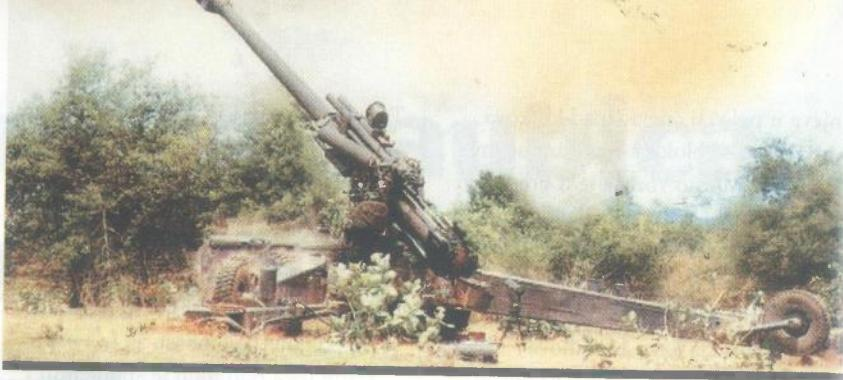
**Samovozna haubica 155 mm u mobilnoj izvedenici pripremljena je za avionski ili helikopterski transport**
