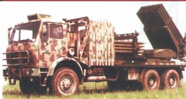
Kineska tvrtka NORINCO (China North Industries Corporation) proizvodi višecijevni bacač raketa (VBR) Type 90, kalibra 122 mm. VBR je postavljen na stražnji dio kamionskog podvozja Mercedes-Benz pogonske konfiguracije 6x6. Prema općem izgledu podsjeća na neke postojeće VBR-e, ponajprije na RM-70 koji je proizvodila bivša Čehoslovačka ili na M-77 Oganj koji je proizvodila vojna indus-
