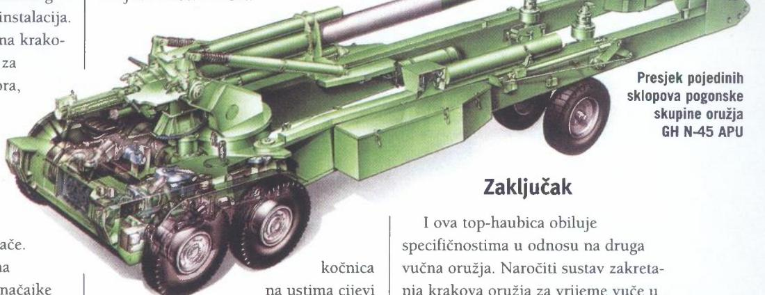
Presjek pojedinih sklopova pogonske skupine oružja GH N-45 APU
