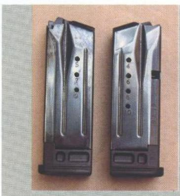
Spremnići pištolja M serije izrađeni su od čelika te s obje strane imaju brojčane oznake. Na slici su prikazani spremnići pištolja Steyr S9
