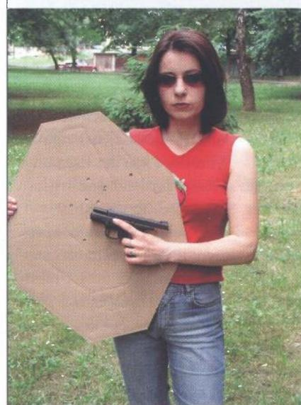
Testirani pištolji na našem su se testu pokazali kao iznimno precizni. Prikazana je grupa pogodaka postignuta pištoljem S9 na IPSC mete na udaljenosti od 10 m. Postignuto vrijeme je iznosilo 2,11 sec uz potezanje pištolja iz odgovarajućeg holstera
