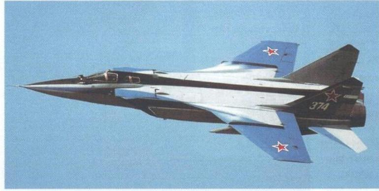
nom od 1.500 km/h. Presrećači dolet za ovakav tip aviona je mnogo važnija statistika. Pri brzini od 2,35 M on iznosi 720 km, a pri brzini od 0,85 M (bez dodatnih spremnika za gorivo) je 1.400 km. Uz jedno tankanje u zraku, a pri istoj brzini, "Foxhoundov" presrećači dolet se povećava na 2.200 km.
