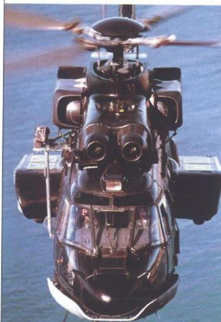
AS 532 SAR s dodatnim štitnicima, za zaštitu od udara valova u slučaju slijetanja na vodu
