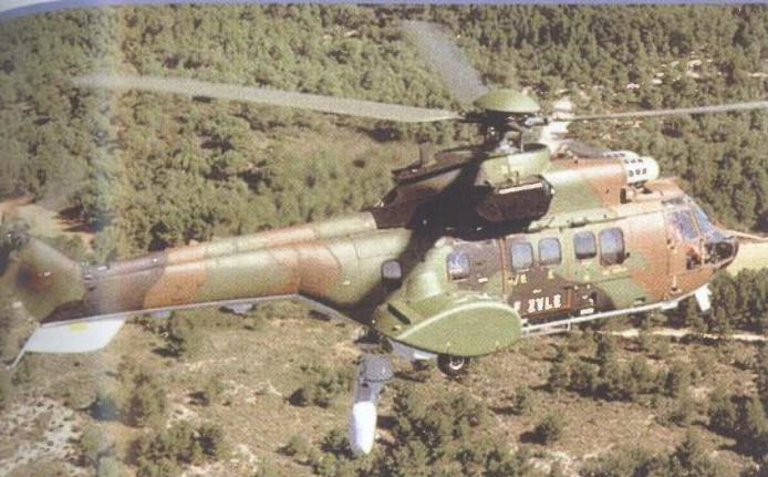
Na AS 532UL Cougar je ugrađen HORIZON taktički radarski sustav za izviđanje i nadzor područja djelovanja, dometa 150-200 km, ovisno o odrazu objekta u zraku. Sustav može poslužiti i za razmjenu podataka s drugim sustavima poput MLRS
