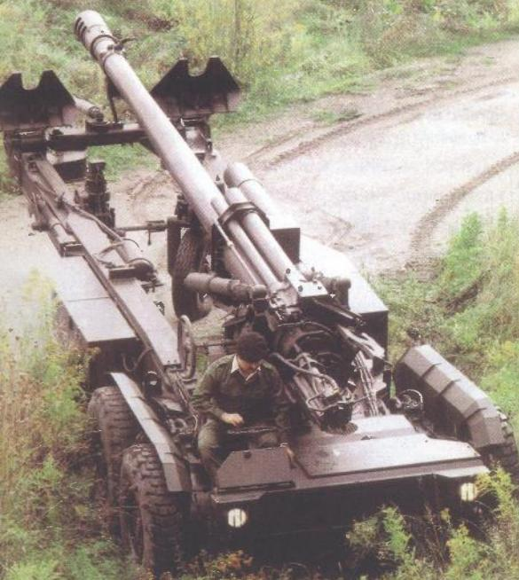
Izvedenica oružja s pomoćnim pogonom nosi oznaku GH N-45 APU. Slika prikazuje kretanje oružja vlastitim pogonom u položaju cijevi za kamionski transport
