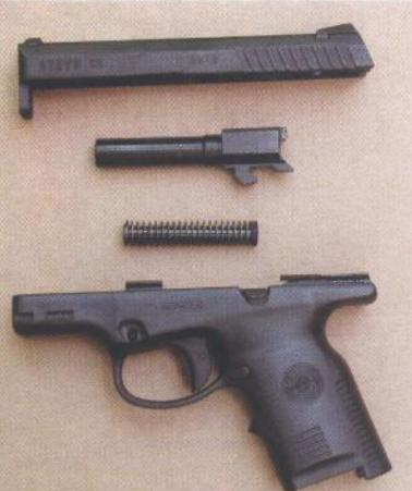
Pištolj Steyr S9 rastavljen na osnovne dijelove. Daljnje se rasklapanje preporučuje jedino ovlaštenim, stručnim osobama
