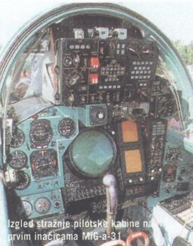
Izgled stražnje pilotske kabine na prvim inačicama MiG-a-31
