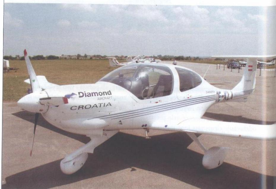
stakloplastike sa sendvič konstrukcijom. Repne površine su "T" konstrukcije, a stajni trap je neuvlačeći tipa tricikl, s vrlo lijepim aerodinamičkim oblogama kotača. Kabina je dizajnirana tako da se u nju mogu udobno smjestiti četiri osobe (pilot + 3 putnika), koje sa sobom mogu ponijeti najviše 30 kg prtljage, koja se može smjestiti u prtljažni prostor koji se nalazi iza stražnjih sjedala.
