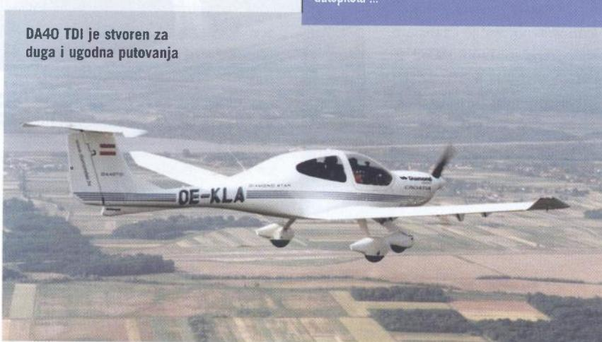
TDI proizvodi dovoljno otpora da bi se moglo reći kako se ponaša kao "normalan" avion. Dok zakrilca nisu u položaju za slijetanje, a posebno dok su uvučena, može se reći da se ponaša kao jedrilica. Pri izvlačenju zakrilaca i u letu s izvučenim zakrilcima avion je stabilan, tako da u završnom prilazu za slijetanje odgovara i na najmanje pokrete palice i pedala, čime održavanje aviona u pravcu osi piste ne predstavlja nikakav problem ni pri bočnom vjetru.
