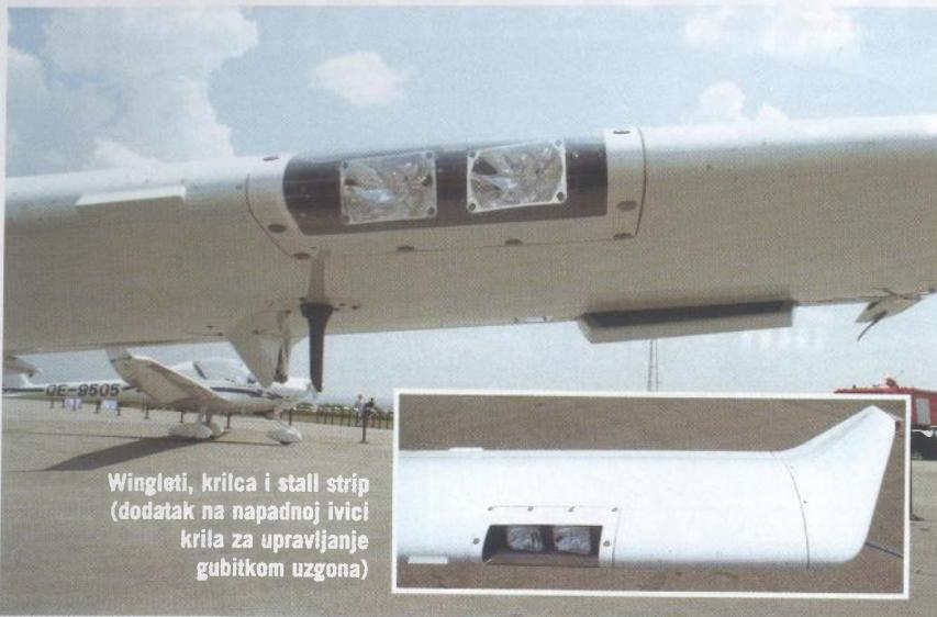
**Wingleti, krilca i stall strip (dodatak na napadnoj ivici krila za upravljanje gubitkom uzgona)**
