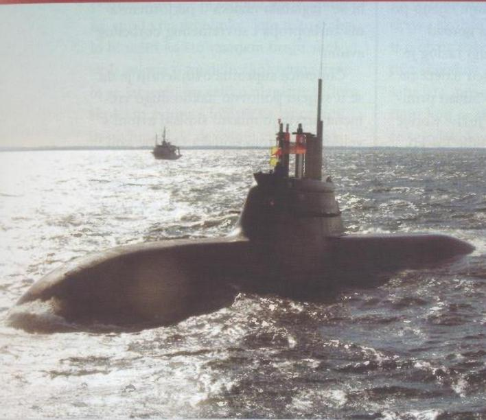
Podmornica U-31, prva od četiri napadne podmornice tipa 212A koje se grade za Njemačku ratnu mornaricu, napustila je 07. travnja luku Kiel te je otplovila na probnu plovidbu i ispitivanje svojih gorivih članaka pogonskog sustava bez utjecaja vanjske atmosfere (anaerobni sustav). Podmornice tipa 212A duljine su 56 m, podvodne istisnine 1830 tona, podvodne brzine 20 čvorova, a doplov im pri podvodnoj brzini 4 čvora iznosi 250 nm. Dubina ronjenja im je veća od 400 m.
