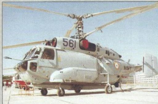
jelica s vertikalnim uzljetanjem. Odabran je helikopter Ka-29 koji je opremljen posebno razvijenim radarem E-801M Oko. Ovako opremljen helikopter dobio je označku Ka-31 iako se u nekim zapadnim izvorima spominje i kao Ka-29 RDL. Antena radara smještena je s donje strane helikoptera što radaru omogućava nesmetano motrenje svih 3600. Antena je dimenzija 6 x 1 metar i težine 200 kg. Brzina okretanja
