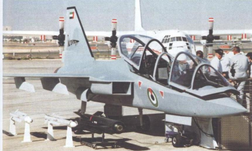
Ono što PC-21 predstavlja među turboprop to MAKO predstavlja među mlaznim školskim avionima. Napredna aerodinamička konstrukcija i omjer potiska i težine koji iznosi oko visokih 1 omogućavaju mu letenje na velikim napadnim kutevima što su odlike svih suvremenih borbenih aviona. Napredna avionika, STEALTH svojstva i mogućnost nošenja "pametnog" naoružanja čine ga višenamjenskim lakin borbenim avionom
