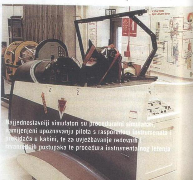
Najjednostavniji simulatori su proceduralni simulatori, namijenjeni upoznavanju pilota s raspoređenom instrumentima i prekidačima u kabini, te za uvježbavanje redovnih i izvanrednih postupaka te procedura instrumentalnog letenja
