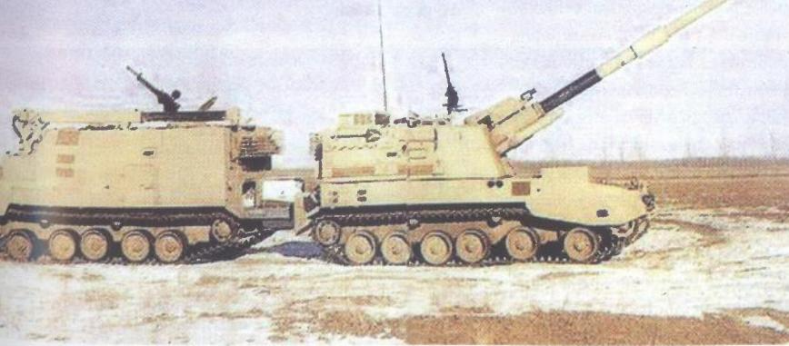
Izvidničko vozilo GCL 45 mase 15 tona opremljeno je opremom za otkrivanje ciljeva i motrenje
