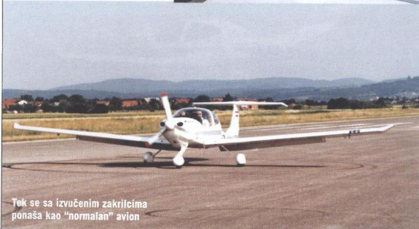
litara), a brzina se stabilizirala na nešto manje od 100 čvorova (oko 180 km/h). Pri 60 posto opterećenja potrošnja raste na 4 US galona (15 litara), a brzina raste za otprilike 10 čvorova (oko 200 km/h). Na 80 posto opterećenja potrošnja je od 5,5 do 6 US galona (oko 22 litre), dok brzina raste za još dodatnih 15 - 20 čvorova (oko 235 km/h). Visina leta je 2.000 stopa (600 metara).
