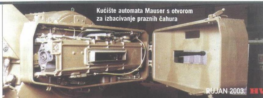
**Kućište automata Mauser s otvorenim izbacivanje praznih čahura**
