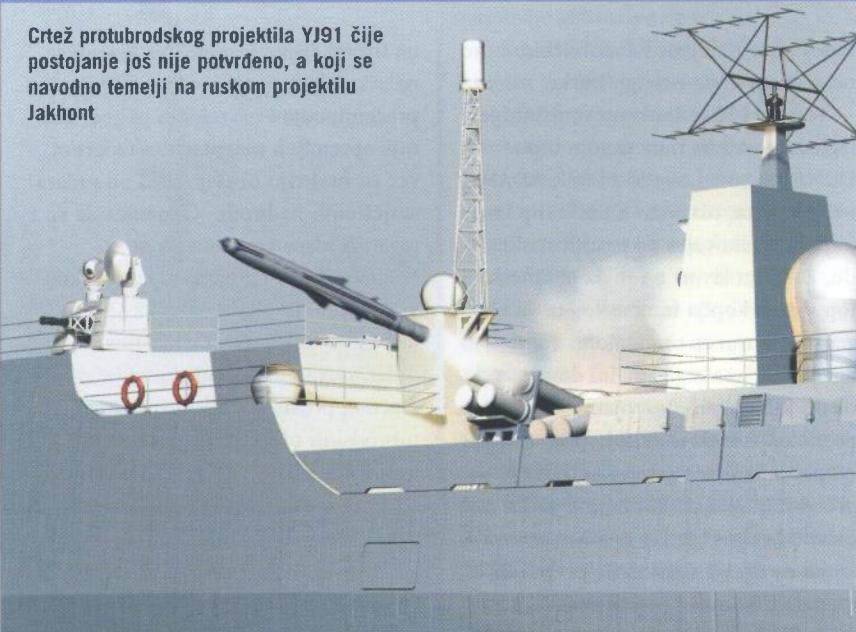
mo onu s projektom YJ-83. Tijelo projektila je vrlo glatko, bez ikakvih izbočenja, sa zašiljenim nosom (slično ruskom projektu AS-17 Kripton), što je jasan indikator da se radi o projektu koji leti visokim nadzvučnim brzinama. Zbog velikog dometa, vodenje mu je kombinirano - putem datalinka na srednjem dijelu leta i radarskog samonavodenja u završnoj fazi leta.
