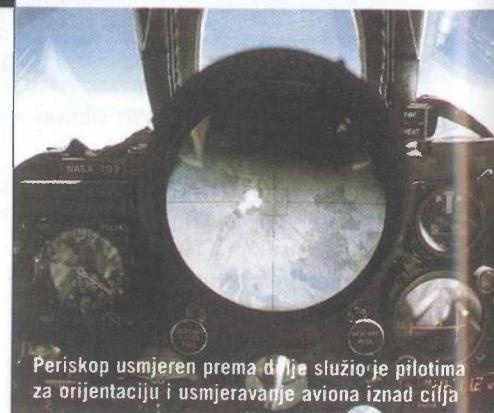
Periskop usmjeren prema dolje služio je pilotima za orijentaciju i usmjeravanje aviona iznad cilja
