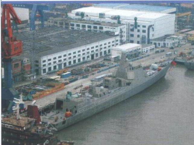
**Prvi razarač klase Lanzhou snimljen s jednog šangajskog mosta neposredno nakon porinuća. To je prva fotografija koja je potvrdila da su razarači opremljeni vertikalnim lanserima bunarskog tipa**
