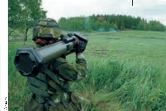
Masa oružja je 11,6 kilograma, jednokratno je i nakon opaljenja se odbacuje. Imo mogućnost postavljanja dodatnog noćnog ciljnika. Projektil je spremlijen u zapečaćenom kontejneru iz kojeg se i ispaljuje. Ne traži nikakvo posebno održavanje, jednostavno se uskladišti u odgovarajućim uvjetima i u slučaju potrebe podijeli vojnicima.
