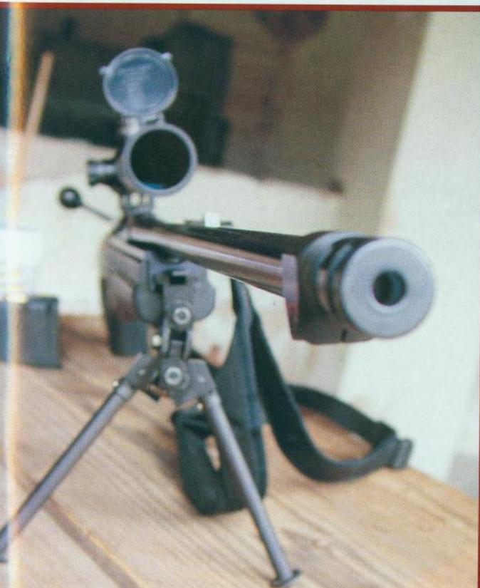
Cijev vrhunske kakvoće završava masivnom i učinkovitom plinskom kočnicom
