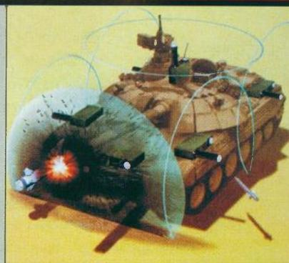
svoj senzor i aktivni sustav za uništavanje raketa te se može postaviti na bilo koji oklopnjak kako bi ga zaštitio od protuoklopnog oružja, kumulativnog ili kinetičkog. Radi tako da senzor stalno motri okolinu i u slučaju detektiranja projektila koji se približio oklopnjaku automatski ispaljuje kazetno punjenje s fragmentima koji se na proračunanoj udaljenosti rasprše i unište ili oštete nadolazeći projektil.
