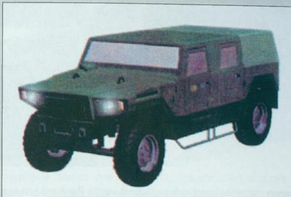
pruža posadi zaštitu u slučaju detoniranja mine mase do 8 kilograma. MOWAG navodi kako će se Eagle IV moći lagano pretvoriti u vozilo za razne zadaće, npr. izvidničke, logističke, zapovjedne itd.
