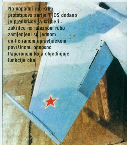
Pomicanjem utega protiv flutter vibracija na vrh krila, prototipovi serije T10S dobili su dvije dodatne podvjesne točke pa je broj nošenih projektila povećan s osam na deset. Predkrilica koja se protežu gotovo cijelim napadnim rubom krila poboljšala su letne osobine na velikim napadnim kutevima i malim brzinama
