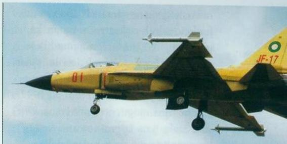
Stajni trap je tipa tricikla i uvlači se u trup - prednja noga u prostor između usisnika, a noge glavnog stajnog trapa u produžetak usisnika. Lošija strana takvog rješenja je vrlo uzak trag kotača, što može biti problem pri snažnom bočnom vjetru. Kao opcija moguće je ugraditi sustav za dopunjavanje gorivom u letu i kuka za zaustavljanje.
