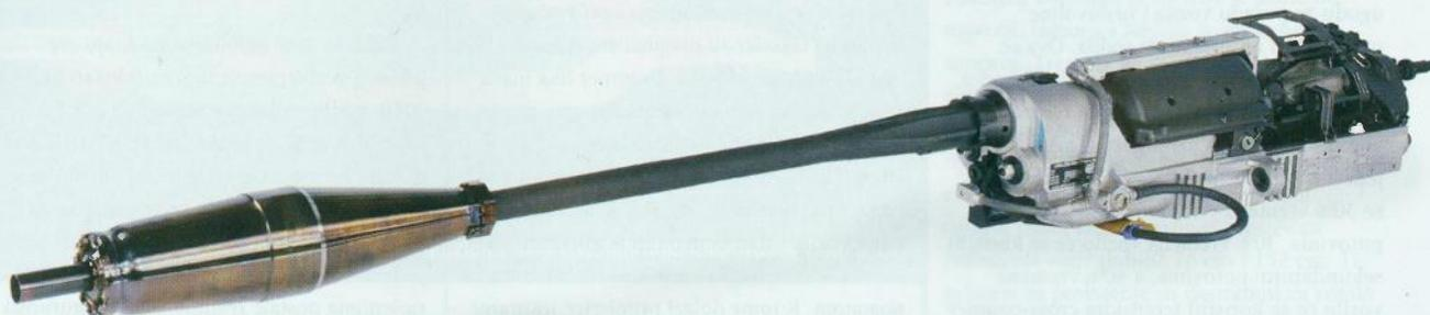
Zrakoplovni top BK 27 s ublaživačem trzanja i prigušivačem plamena predstavlja vrlo respektabilno oružje
