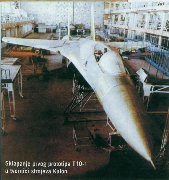
Sklapanje prvog prototipa T10-1 u tvornici strojeva Kulon
