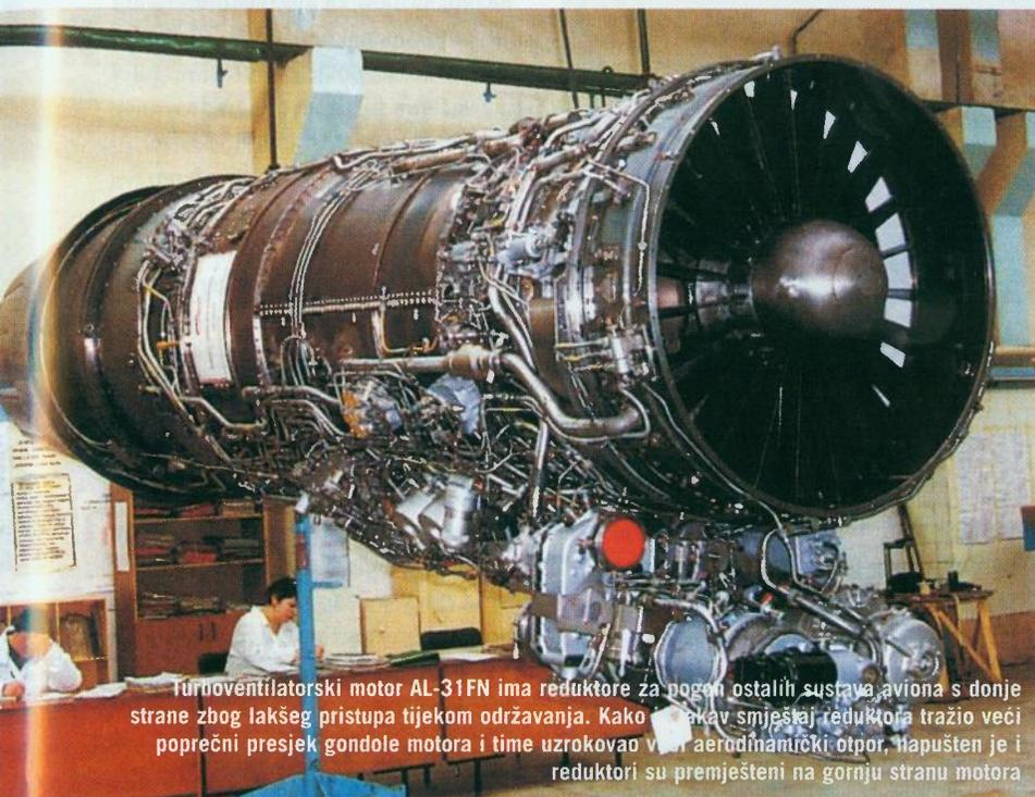
Turboventilatorski motor AL-31FN ima reduktore za pogon ostalih sustava aviona s donje strane zbog lakšeg pristupa tijekom održavanja. Kako bi ovaj smještaj reduktora tražio veći poprečni presjek gondole motora i time uzrokovao veći aerodinamički otpor, napušten je i reduktori su premješteni na gornju stranu motora
