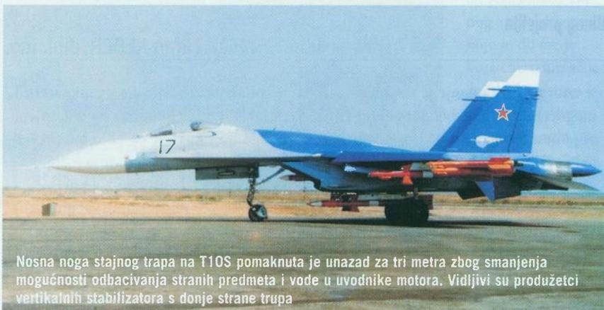
Nosna noga stajnog trapa na T10S pomaknuta je unazad za tri metra zbog smanjenja mogućnosti odbacivanja stranih predmeta i vode u uvodnike motora. Vidljivi su produžetci vertikalnih stabilizatora s donje strane trupa
