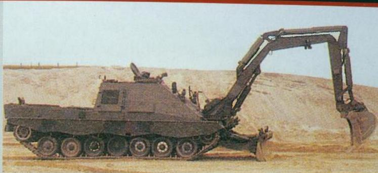
razminiranje. Vozilo ima i dva vitla. Posada svim alatima, i teškom strojnicom kalibra 12,7 mm, upravlja daljinski, iz oklopom zaštićene unutrašnjosti.
