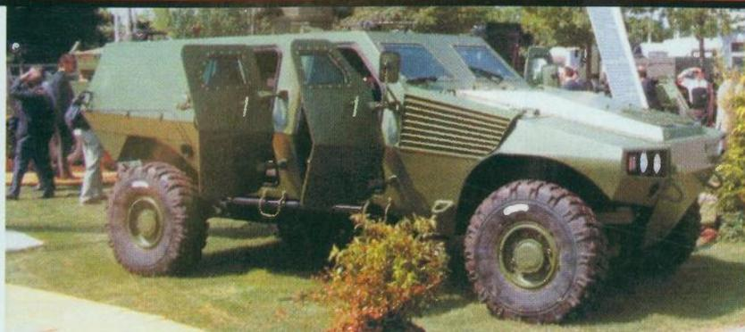
**F**rancuski proizvođač oklopnih vozila Panhard prikazao je veću inačicu svojeg oklopnjaka VBL. Nova je inačica nazvana VBR (Véhicule Blindé à Roues), a pogonska je konfiguracija 4x4. Borbena masa nove inačice je 7,5 tona, a nosivosti je 2 tone. Konstruktori su u razvoju nove inačice nastojali zadovoljiti želje korisnika koji su zahtijevali veću nosivost i bolju mobilnost.
