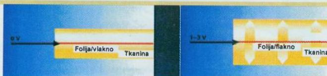
tvorevine ugradivale električki vodljive metalne folije. Primjena vodljivih vlakana i folija mogla bi biti u obliku prijemnih i emisijskih antena u odjeći. Vodići unutar tekstilnih vlakana mogli bi poslužiti i za izvođenje vrlo laganih, tankih i nevidljivih električnih i elektroničkih sabirnica za napajanje svih ugradenih uređaja i za prijenos podataka između njih.
