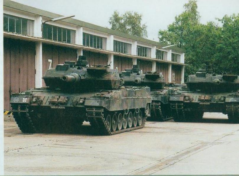
tome prvi tenk inačice A5 službeno je isporučen njemačkoj vojsci 30. studenog 1995. Odlučeno je i da sva tijela proizvedena u šestoj, sedmoj i osmoj seriji postanu osnova za ovu inačicu, a da se kupole s tenkova proizvedenih u prve četiri serije moderniziraju na standard A5 i njihovim spajanjem proizvedu tenkovi inačice Leopard 2 A5. Za proizvodnju i modernizaciju tijela odgovorne su bile tvrtke Krauss-Maffei
