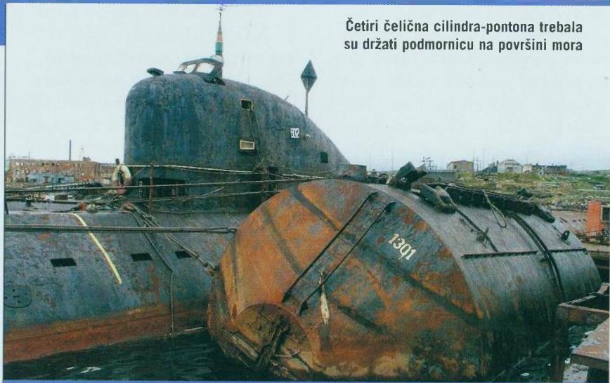
**Četiri čelična cilindra-pontona trebala su držati podmornicu na površini mora**
