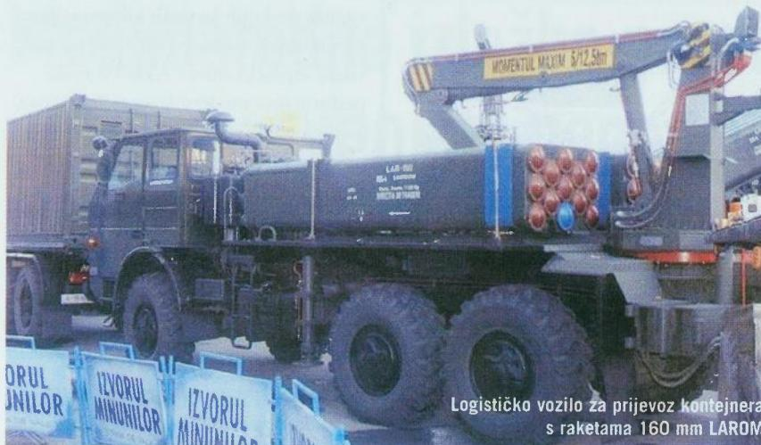
Logističko vozilo za prijevoz kontejnera s raketama 160 mm LAROM
