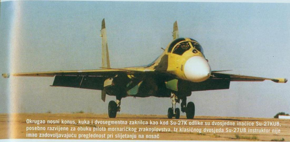
Okrugao nosni konus, kuka i dvosegmentna zakrilca kao kod Su-27K odlike su dvosjedne inačice Su-27KUB, posebno razvijene za obuku pilota mornaričkog zrakoplovstva. Iz klasičnog dvosjeda Su-27UB instruktor nije imao zadovoljavajuću pregleđnost pri slijetanju na nosač
