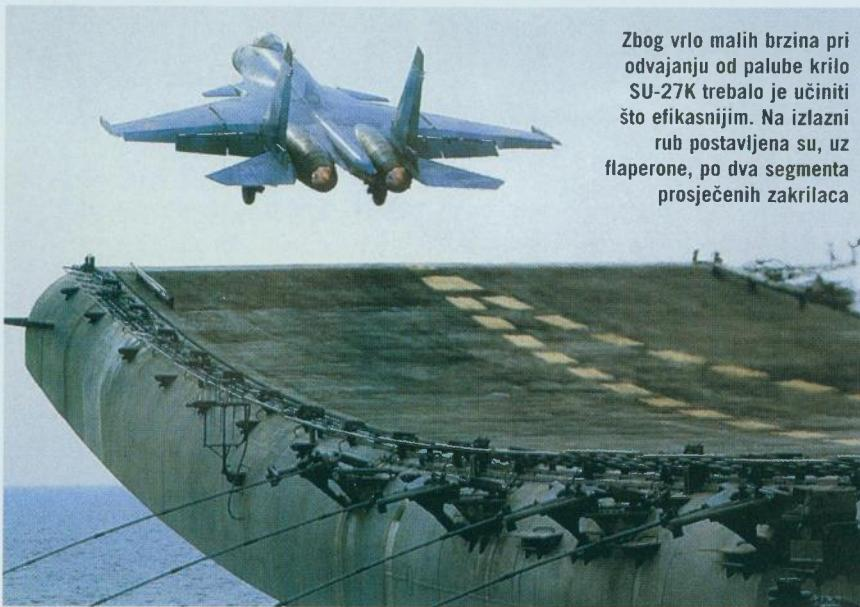
Zbog vrlo malih brzina pri odvajjanju od palube krilo SU-27K trebalo je učiniti što efikasnijim. Na izlazni rub postavljena su, uz flaperone, po dva segmenta prosječenih zakrilaca
