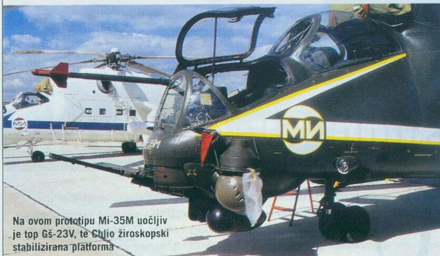
Na ovom prototipu Mi-35M uočljiv je top GŠ-23V, te Ghljo žiroskopski stabilizirana platforma
