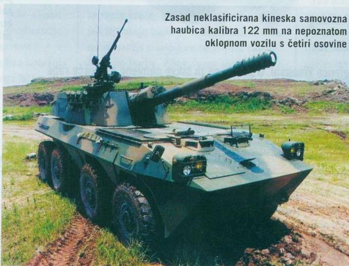
Zasad neklasificirana kineska samovozna haubica kalibra 122 mm na nepoznatom oklopnom vozilu s četiri osovine
