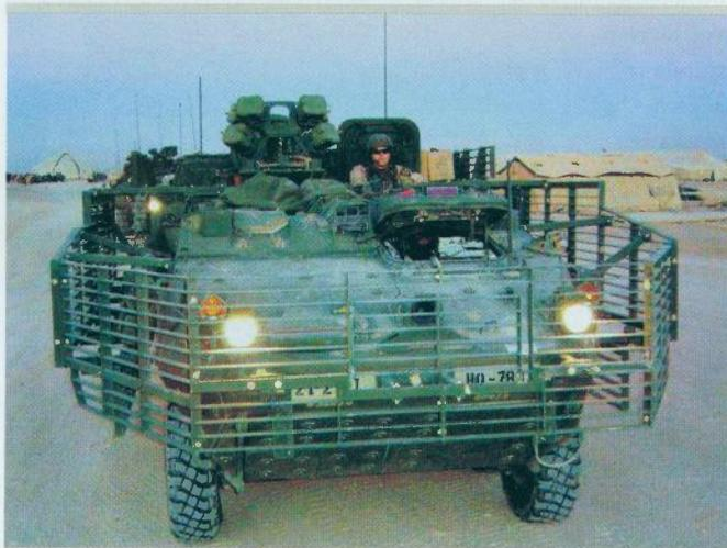
Stryker sa "slat" oklopm koji bi ga trebao štiti od protuoklopnih kumulativnih projektila
