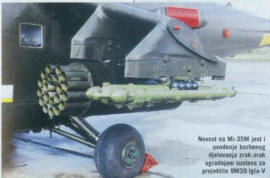
Novost na Mi-35M jest i uvođenje borbenog djelovanja zrak-zrak ugradnjom sustava za projektele 9M39 Igla-V
