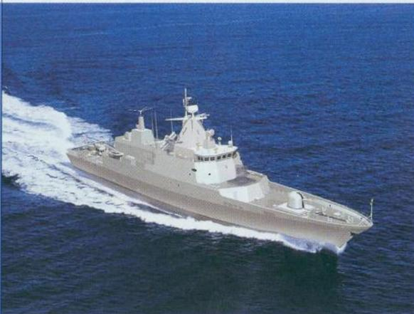
91 metar, istisnine 1900 tona, a najveću brzinu od 22 čvora osiguravaju im dva Diesel motora Caterpillar 3616 ukupne snage 5450 kW.
