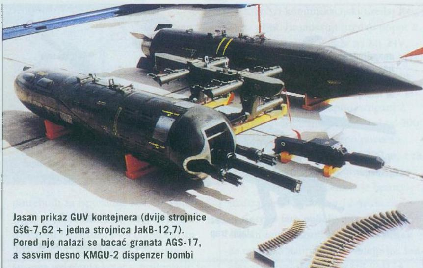
Jasan prikaz GUV kontejnera (dvije strojnice GŠG-7,62 + jedna strojnica JakB-12,7). Pored nje nalazi se bacač granata AGS-17, a sasvim desno KMGU-2 dispencer bombi
