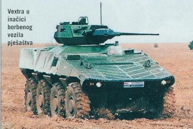
se razvija i inačica u konfiguraciji 6x6. Borbena masa mu je 27 tona, od čega je čak 11 tona nosivosti. Može ponijeti dva člana posade i 12 vojnika. Iako ima relativno slabu oklopnu zaštitu (od streljiva kalibra 7,62 mm), može ga se opremiti dodatnim oklopom. Posebna pozornost dana je zaštiti od mina. Pot-
