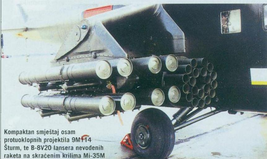
Kompaktan smještaj osam protuoklopnih projektila 9M114 Šturm, te B-8V20 lansera nevođenih raketa na skraćenim krilima Mi-35M
