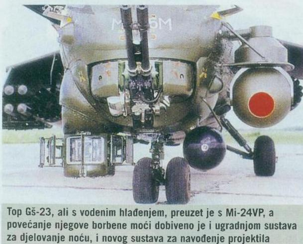
Top GŠ-23, ali s vodenim hlađenjem, preuzet je s Mi-24VP, a povećanje njegove borbene moći dobiveno je i ugradnjom sustava za djelovanje noću, i novog sustava za navođenje projektila
