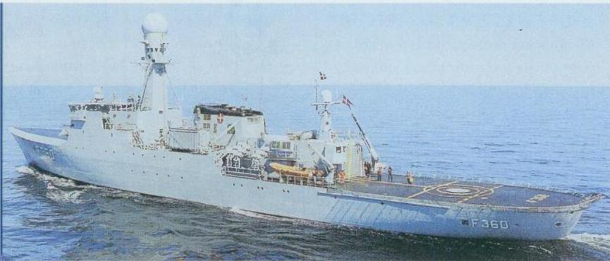
lubu i unutar nadgrada kako bi se smanjila mogućnost zaleđivanja i oštećenja opreme, ali i zbog smanjenja radarskog odraza. Brodovi nemaju ljuljnu kobilicu, no stabiliziranje se postiže kombiniranom uporabom aktivnih krilnih stabilizatora tvrtke Blohm+Voss i pasivnim sustavom stabilizirajućih tankova.
