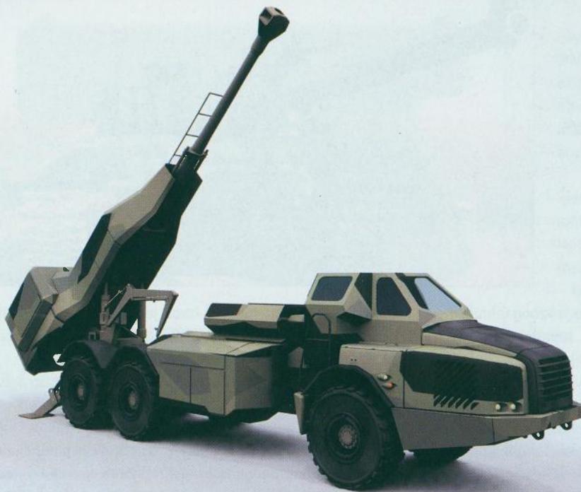
**Š**vedska Uprava za obrambene nabave (FMV-Försvarets materielverk) planira s tvrtkom Bofors Defence sklopiti ugovor o izgradnji dva demonstratorska topnička sustava FH-77BD L52. Riječ je o samovoznom sustavu pogonske konfiguracije 6x6. Demonstracijski će sustavi biti dovršeni tijekom ove godine, a 2005. bi započela intenzivna trupna ispitivanja. Ako sve bude teklo prema planu, prvi serijski primjerici bili bi isporučeni 2008.
