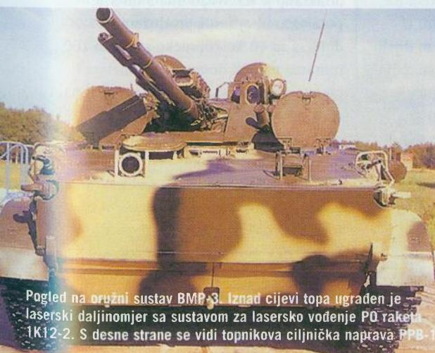
Pogled na oružni sustav BMP-3. Iznad cijevi topa ugrađen je laserski daljinomjer sa sustavom za lasersko vođenje PÖ rakete 9M117. S desne strane se vidi topnikova ciljnička naprava PPB-1.
