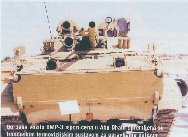
Borbena vozila BMP-3 isporučena u Abu Dhabi opremljena su francuskim termovizijskim sustavom za upravljanje paljbot
