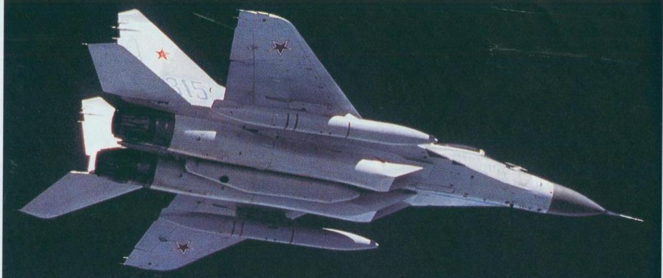
**Prva modifikacija MiG-a 29 (projekt 9-13) bila je ponajviše usmjerena na povećanje nosivosti goriva. Osim povećanja kapaciteta internih spremnika unutrašnje podkrilne točke prilagođene su nošenju podvjesnih spremnika s gorivom**
