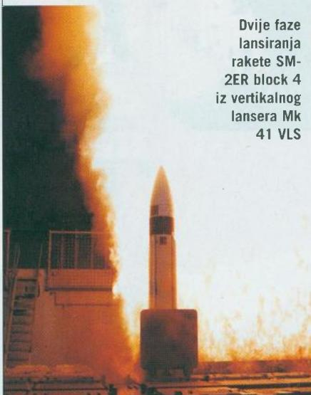
Dvije faze lansiranja raketke SM-2ER block 4 iz vertikalnog lansera Mk 41 VLS
