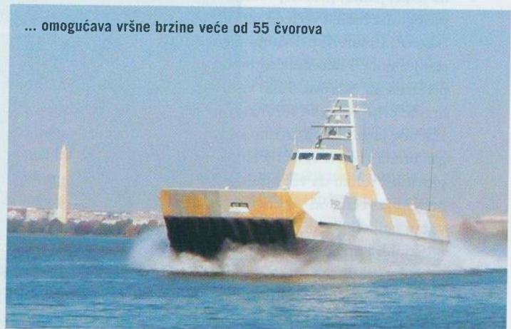
mornaricu bit će u pogonskom sustavu. Originalni Skjold ima CODAG (Combined Diesel And Gas turbine) pogonski sustav, dok će operativni brodovi ove klase imati znatno drugačiji COGAG (Combined Gas turbine And Gas turbine) pogon.
