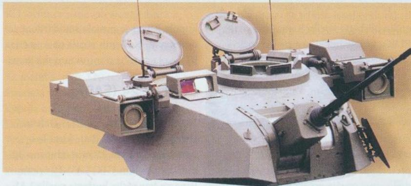
od 120 metaka, te 600 metaka za strojnici 7,62 mm, masa kupole je oko 1.850 kg.
