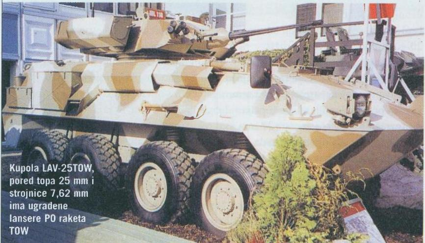
**Kupola LAV-25TOW, pored topa 25 mm i strojnice 7,62 mm ima ugradene lansere PO raketa TOW**
