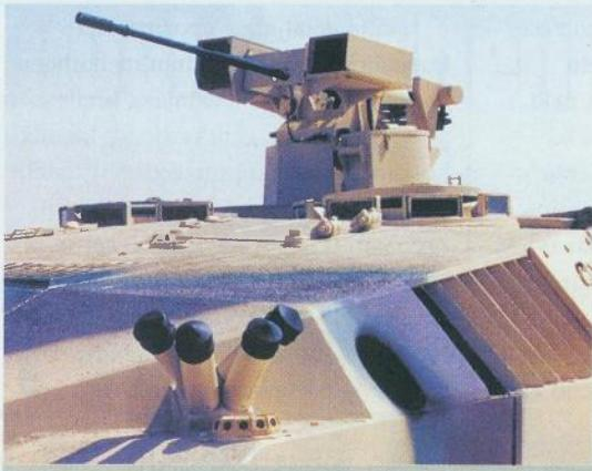
**Kupola 20 mm bez posade SWARM (Stabilized Weapon And Reconnaissance Mounting) opremljena topom 20 mm M621 Giat i koaksijalno spojenom strojnicom 7,62 mm ugrađena na jordansko borbeno vozilo AB 14 Temsah**
