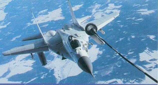
Za temeljne inačice MiG-a 29 (projekt 9.12 i 9.13) te MiG-29SMT razvijen je montažni priključak za punjenje gorivom u zraku koji je kompatibilan s NATO standardom zračnih cisterni
