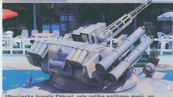
Ukrajinska kupola Shkval, vrlo velike paljbe moći, opremljena topom 30 mm ZTM-1, lanserima PO raketa Konkurs, automatskim bacačem granata 30 mm AGS-17, koaksijalno spojenom strojnicom 7,62 mm i bacačima dimnih granata
