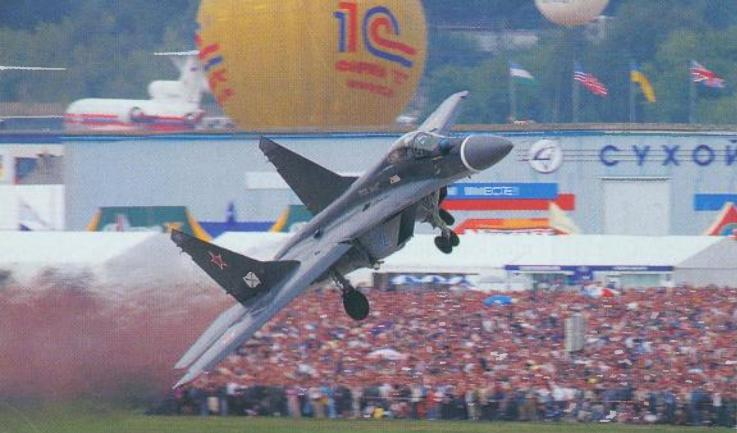
Zbog vrlo velikog omjera potiska i težine te krila povećane površine MiG-29K sposoban je oštro manevrirati odmah nakon uzleta
