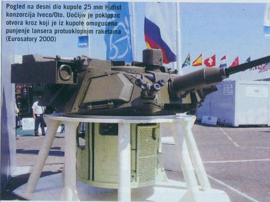
nomjerom. Pored toga po obodu poklopca otvora zapovjednika ugrađeno je šest periskopskih vizira, dok je mjesto topnika opremljeno s dva vizirna sustava. Na bočne strane kupole moguće je ugradnja lansera protuoklopnih raket TOW slično kao i kod kupole TC-25.
