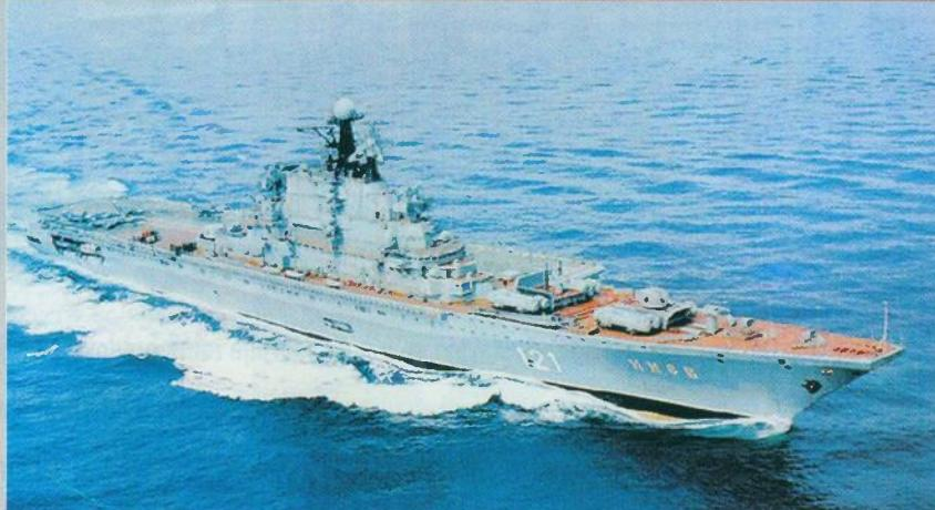
ugradnju novih turbina Kirov-Energomash, novog ventilacijsko-klimatizacijskog sustava i uklanjanje prednjih raketnih lansera. Isto tako, protuzračni sustav će se dograditi postavljanjem raketno-topničkog sustava Kortik/Kaštan 9M311 (NATO oznaka SA-N-11 Grisson) koji se sastoji od projektila 9M311 doseg od 1500 do 8000 m te dvocijevnog automatskog topa 2A38M tipa Gatling kalibra 30 mm doseg 500 do 1500 m. Sustav Kortik/Kaštan je mornarička inačica kopnenog protuzračnog sustava
