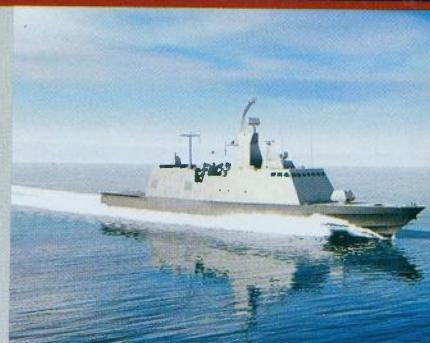
sok stupanj manevaribilnosti. Svaki brod će imati 37 članova posade, dok će četiri dieselska motora MTU 12V595 TE90 preko dva vodomlazna propulzora osiguravati najveću brzinu od 32 čvora. Doplov pri ophodnoj brzini od 15 čvorova će iznositi 2400 nm, a imat će autonomnost od 14 dana.
