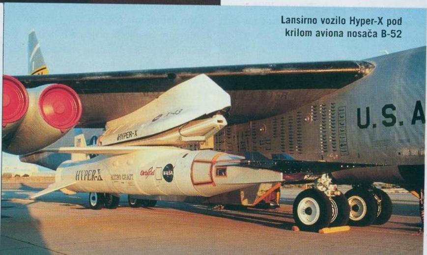
Lansirno vozilo Hyper-X pod krilom aviona nosača B-52
