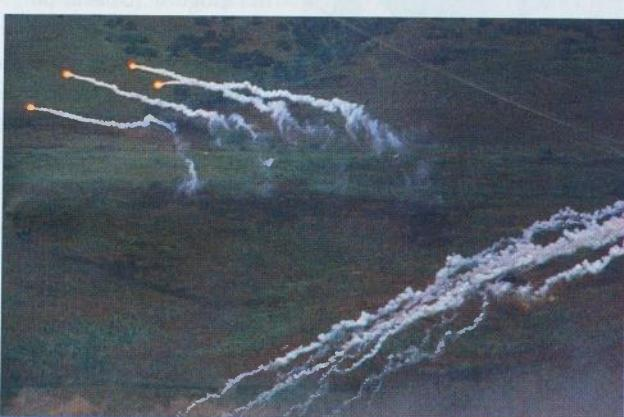
Pirotehnički IC mamci najstariji su način ometanja IC samonavodenih raketica. Uporabljeni sa jako malih visina često izazivaju požar na tlu
