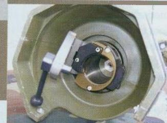
Ležište na stražnjoj strani ručnog bacača AT4 u koje se ubacuje poseban imitator dočaravajući na taj način zvuk i opasnu zonu iza samog bacača
