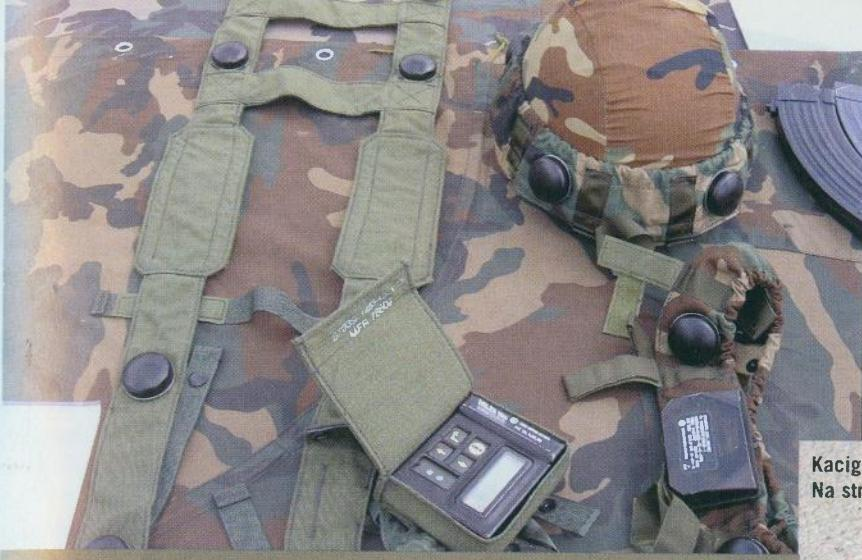
Komplet opreme za vojnika sastoji se od upratača sa senzorima i kontrolnom jedinicom, te laserskog predajnika koji se postavlja na vrh cijevi puške. Na upratačima vojnika raspoređeno je osam senzora (četiri s prednje strane i četiri na ledima), dok su preostala četiri senzora razmještena po obodu kacige. Kontrolna jedinica ima oblik četvrtastih kutija
