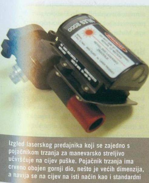
Izgled laserskog predajnika koji se zajedno s pojačnikom trzanja za manevarsko streljivo učvršćuje na cijev puške. Pojačnik trzanja ima crveno obojeni gornji dio, nešto je većih dimenzija, a navija se na cijev na isti način kao i standardni
