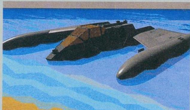
portne avione. Za normalnu plovidbu velikim brzinama rabit će se tzv. High Speed položaj trupa pri kojem je središnji dio trupa visoko iznad vode, a dva bočna trupa duboko ispod površine mora. Za zadaće izviđanja i djelovanja u blizini obala rabit će se tzv. Loiter/Reconnaissance položaj trupa pri kojem je središnji trup na površini mora, a dva pomoćna zaronjena ispod površine. Ovakav položaj trupa između ostalog smanjuje siluetu, ali i omogućava brzo postizanje velikih brzina u slučaju potrebe.
