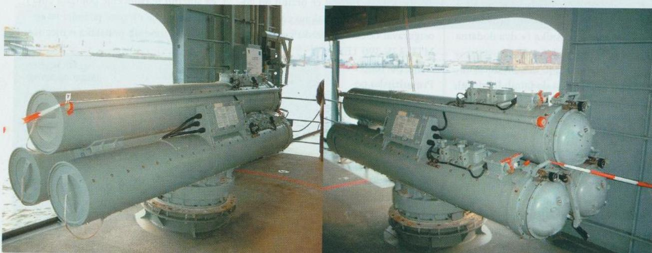
Trostrukе torpedne cijevi MK 32 Mod 9 promjera 324 mm namijenjene lansiranju torpeda Mk 46 mod 2 ili DM4A1
