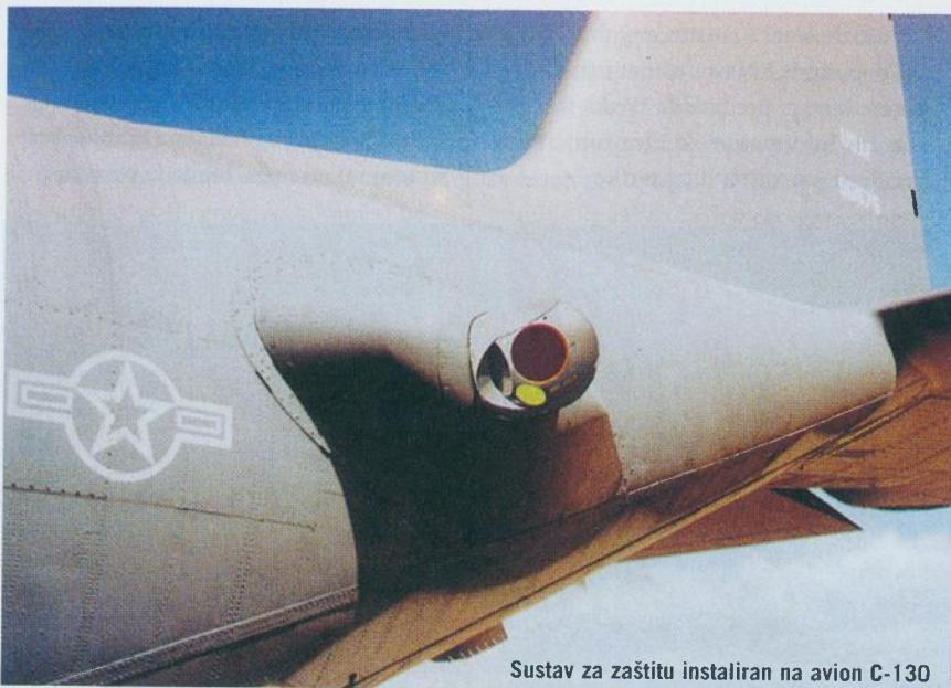
Sustav za zaštitu instaliran na avion C-130
