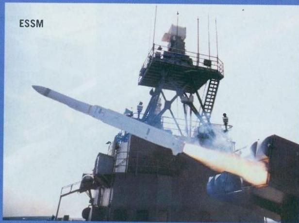
identične raketama inačica RIM-7M/P osim što im je dodano dvokanalno infracrveno tražilo uz poboljšani susav poluaktivnog radarskog vođenja. Infracrveno tražilo preuzeto je iz programa modernizacije raketnog sustava zrak-zrak kratkog dometa AIM-9 Sidewinder. U trenutku lansiranja tražilo je zaštićeno. Tijekom leta zaštitna se skida i tražilo počinje s pretraživanjem prostora ispred raketne, otkriva i prepoznaće cilj te se veže na njega. Zatim
