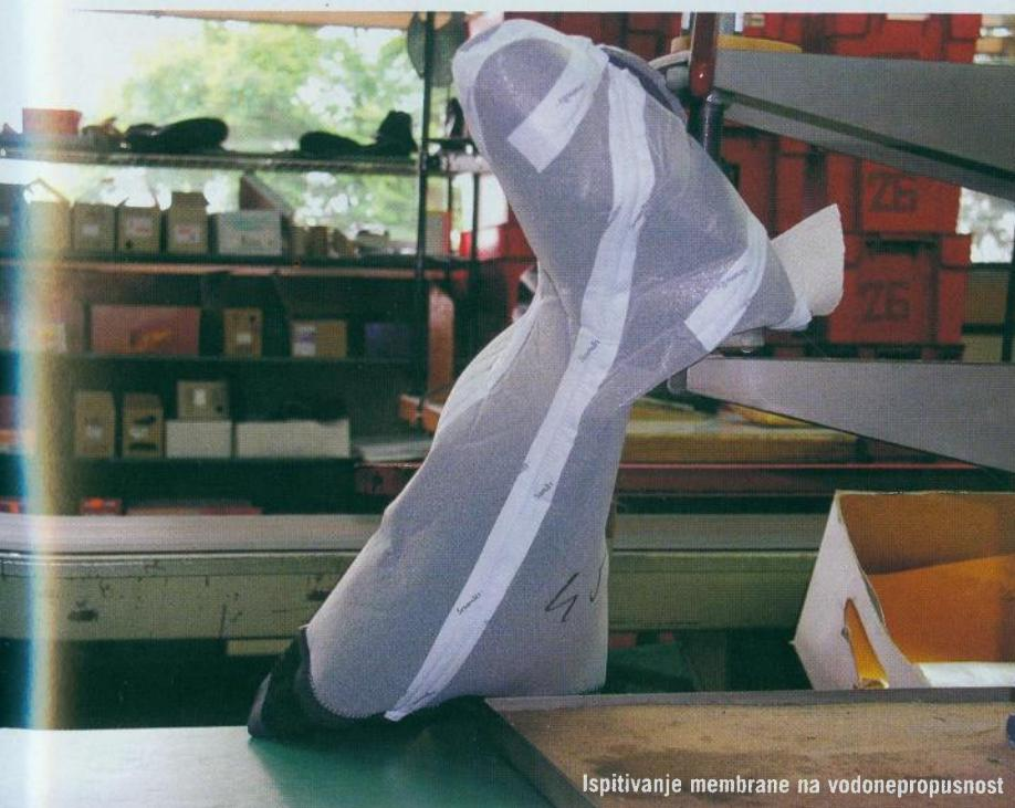
Ispitivanje membrane na vodonepropusnost
