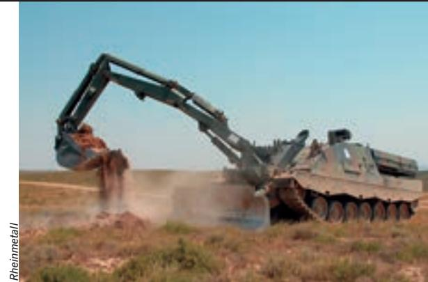
čišćenje minskih polja, a za te se poslove rabi dozerski nož te dodatna oprema za nadzor, mjerjenje i označavanje pregledanog područja. Inače, Geniepanzer ima razinu zaštite posade sličnu kao i kod tenka Leopard 2, a od naoružanja nosi tešku strojnici kalibra 12,7 mm te bacače dimnih granata.
