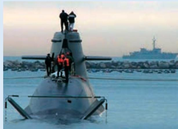
podmornica iznosi 56 metara, dok je najveći promjer trupa 7 metara, imaju karakteristiku podvodne istisnine 1830 tona, maksimalne podvodne brzine 20 čvorova, a doplov im pri podvodnoj brzini 4 čvora iznosi 250 nm. Dubina ronjenja im je veća od 400 metara.
