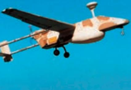
Bespilotna letjelica Searcher Mk II pripada četvrtoj generaciji bespilotnih sustava. Velikim dijelom temelji se na svom prethodniku - bespilotnoj letjelici Searcher koja pripada trećoj generaciji bespilotnih sustava, a u operativnu uporabu ušla je tijekom 1992. Od nje se razlikuje znatno poboljšanim aerodinamičkim
